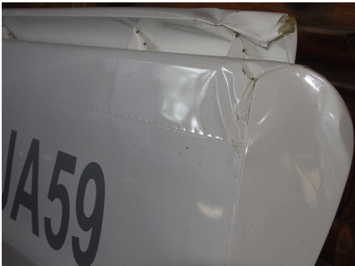
22 – Uszkodzenia końcówki lewego skrzydła i zniszczona końcówka slotu.
