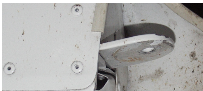
26 – Okucie dźwigara głównego prawego skrzydła z odkształceniami i uszkodzeniami przy zamocowaniu.
