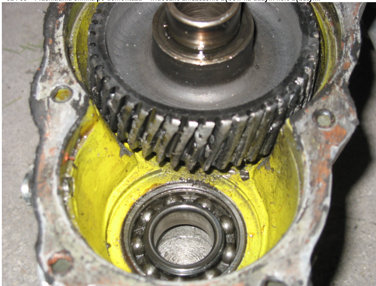
32 i 33 – Przekładnia silnika po demontażu – widoczne zniszczenie zębów na dużym kole zębatym.
