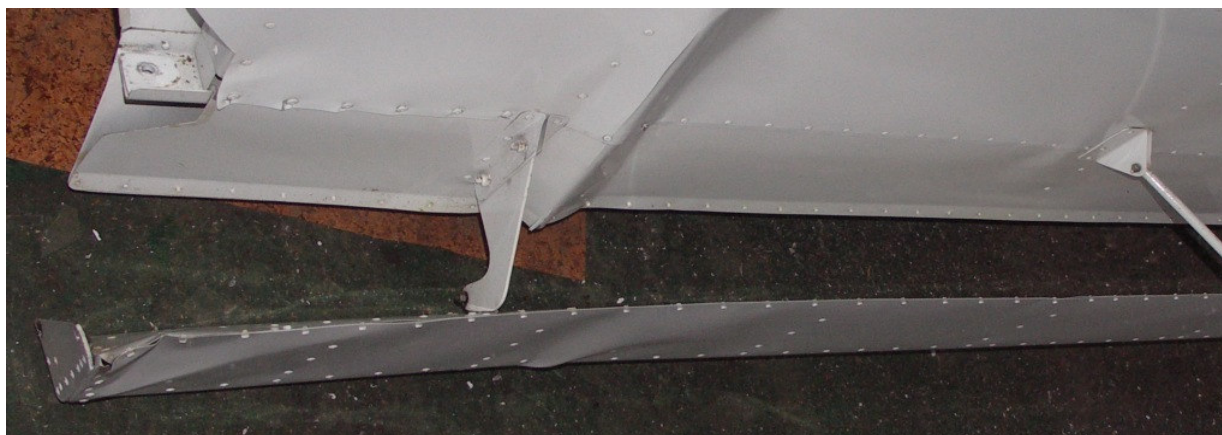
25 – Uszkodzenia lewego wewnętrznego segmentu klapolotki przy kadłubie. Widoczne odkształcenia pokrycia.
