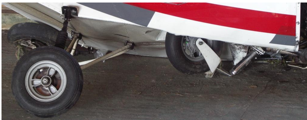
7 – Zbliżenie na zniszczone podwozie i dolne pokrycia kadłuba w rejonie kabiny.
