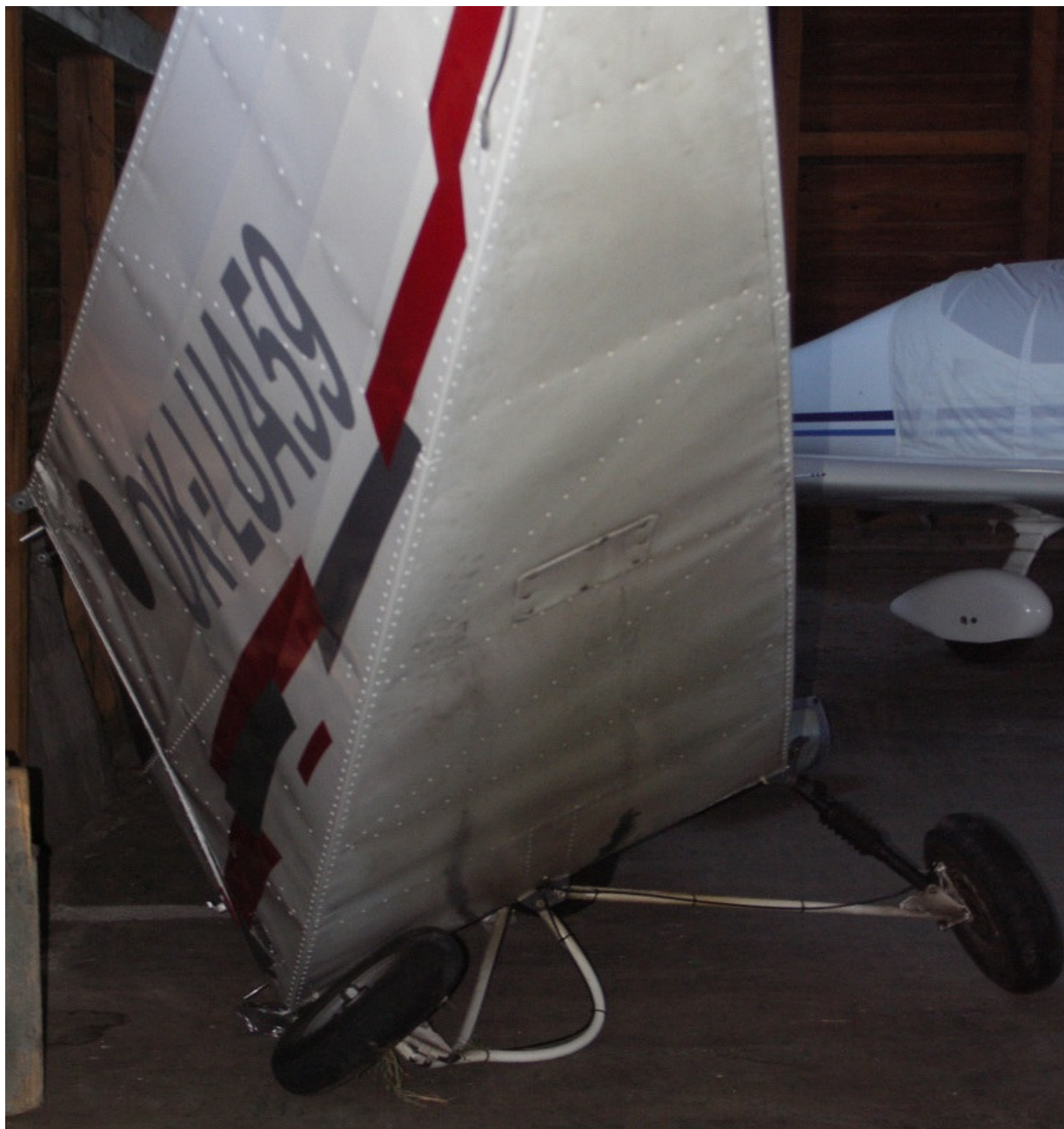
9 – Tylna część kadłuba z widocznymi odkształceniami pokrycia po lewej stronie i podwozie główne.
