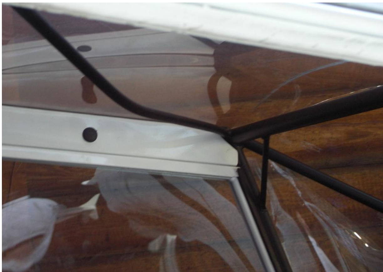
12 – Górne wykrzyżowanie kabinowej grodzi kratownicy, odkształcone w wyniku wypadku.
