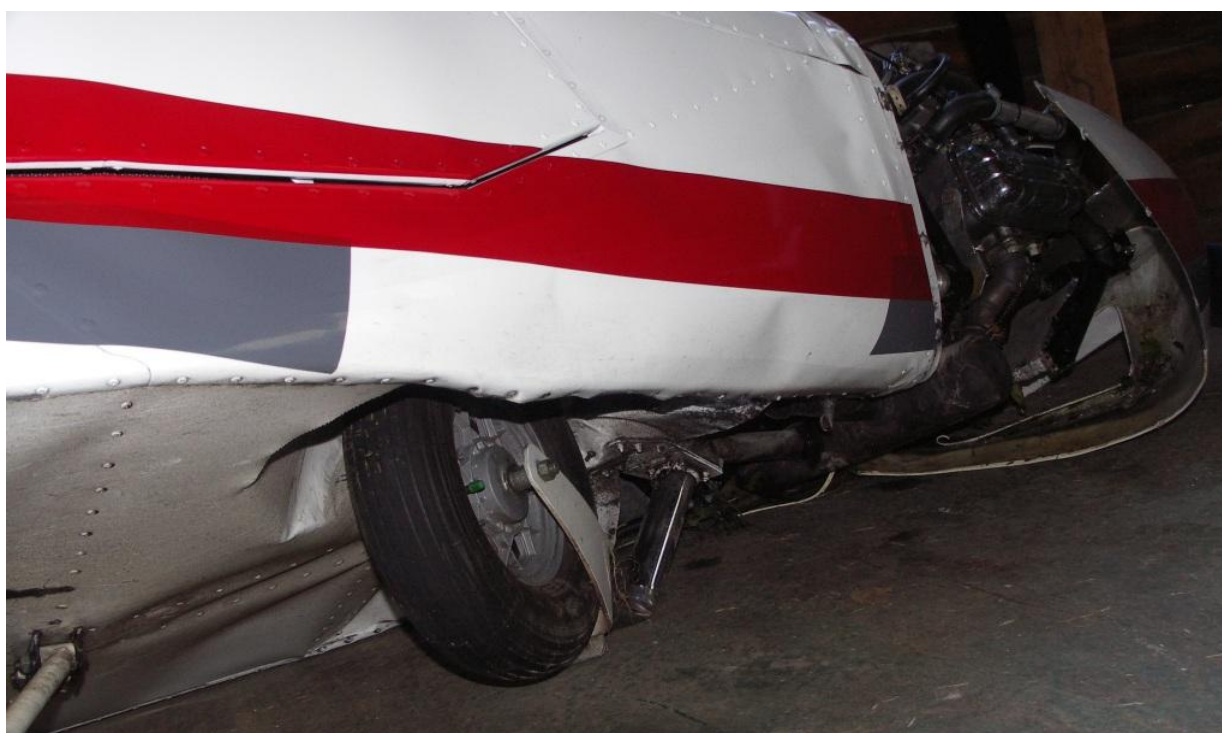
8 – Zniszczone podwozie przednie, dolne pokrycia kadłuba w rejonie kabiny i silnik.
