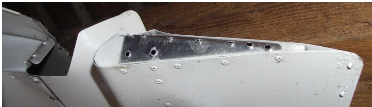
28 – Końcówka lewego wewnętrznego segmentu klapolotki przy kadłubie. Widoczne zniekształcenie żeberka zamykającego i ślady po wyrwanych nitach mocujących dźwignię napędu sterowania, pokazaną na zdjęciu 22. Na drugim planie widoczne uszkodzenia struktury spływowej części skrzydła.
