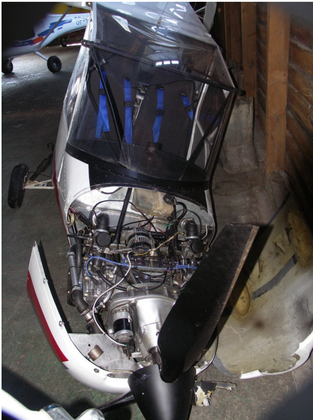
19 – Widok na kadłub zdemontowanego samolotu od przodu. Widoczne zniszczone śmigło. Górna osłona silnika zdjęta.
