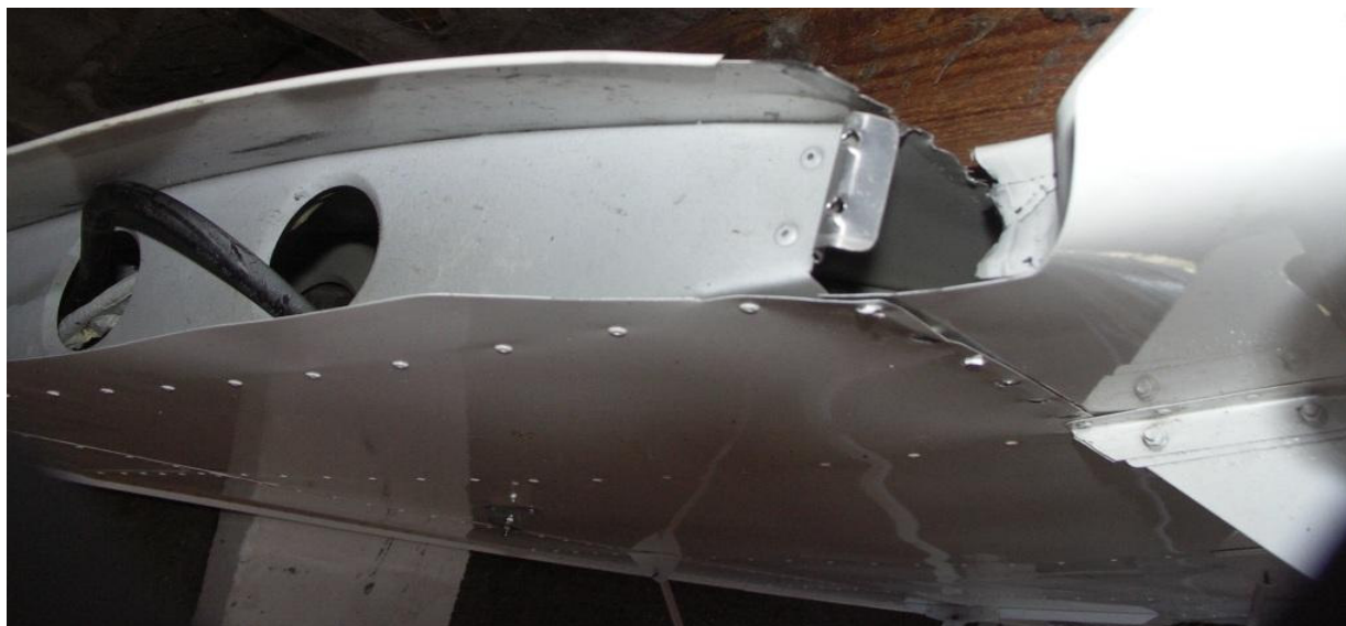
29 – Rejon żebra nasadowego prawego skrzydła. Widoczne uszkodzenia i odkształcenia.
