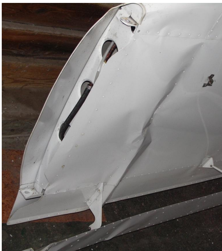
23 i 24 – Uszkodzenia w rejonie nasady lewego skrzydła.
