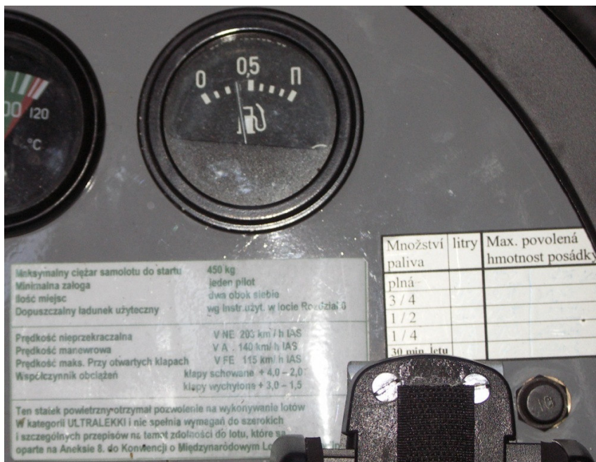
18 – Zbliżenie na główną tabliczkę informacyjną samolotu i wskaźnik paliwomierza, pokazujący ok. 38% paliwa w kadłubowym zbiorniku rozchodowym. Zwraca uwagę brak wpisów na tabliczce określającej ilość paliwa w stosunku do ciężaru załogi.
