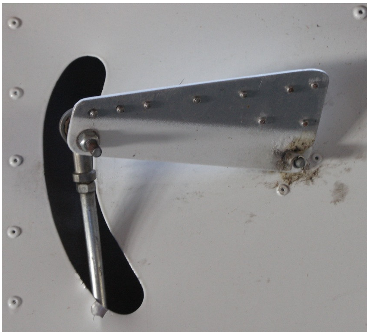
21 – Wyprowadzenie sterowania klapołotkami z prawej burty kadłuba. Na końcówce popychacza wyłamane krańcowe (nasadowe) żeberko wewnętrznego segmentu klapołotki.
