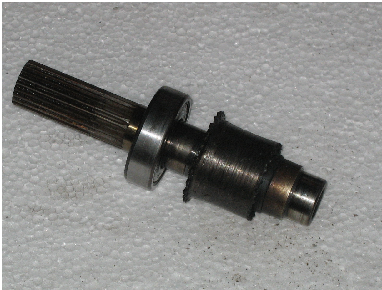
34 – Wałek mniejszego koła zębatego przekładni z resztkami koła.
