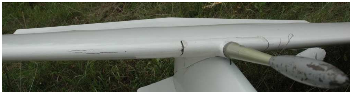
25 – Uszkodzenia noska płyty usterzenia poziomego.
