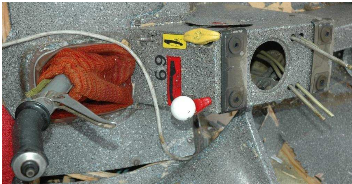
22 – Konsola centralna z drążkiem sterowym. Widoczne amortyzatory po wyrwanej tablicy przyrządów.
