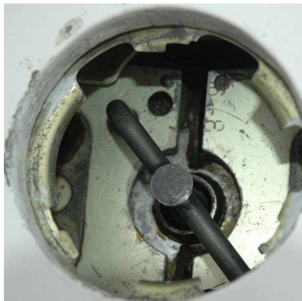
36 – Zbliżenie na otwarty luk sworznia połączenia skrzydeł.
