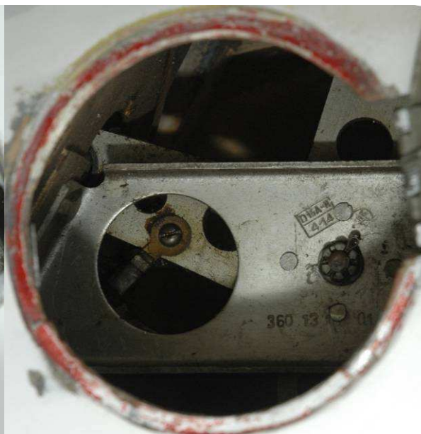
37 – Zbliżenie na otwarty luk układu sterowania na lewej burcie za kabiną.
