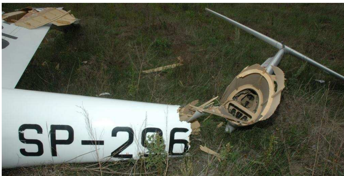
14 – Przełom tylnej części kadłuba.
