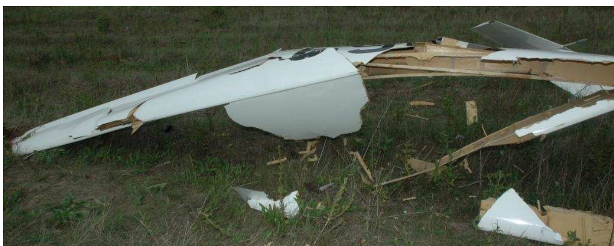
26 – Zniszczone prawe skrzydło od przodu, rejon końcówki i środka.
