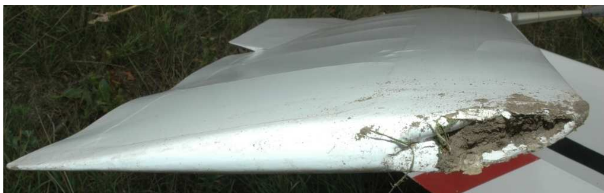
24 – Uszkodzenia prawej końcówki płyty usterzenia poziomego.
