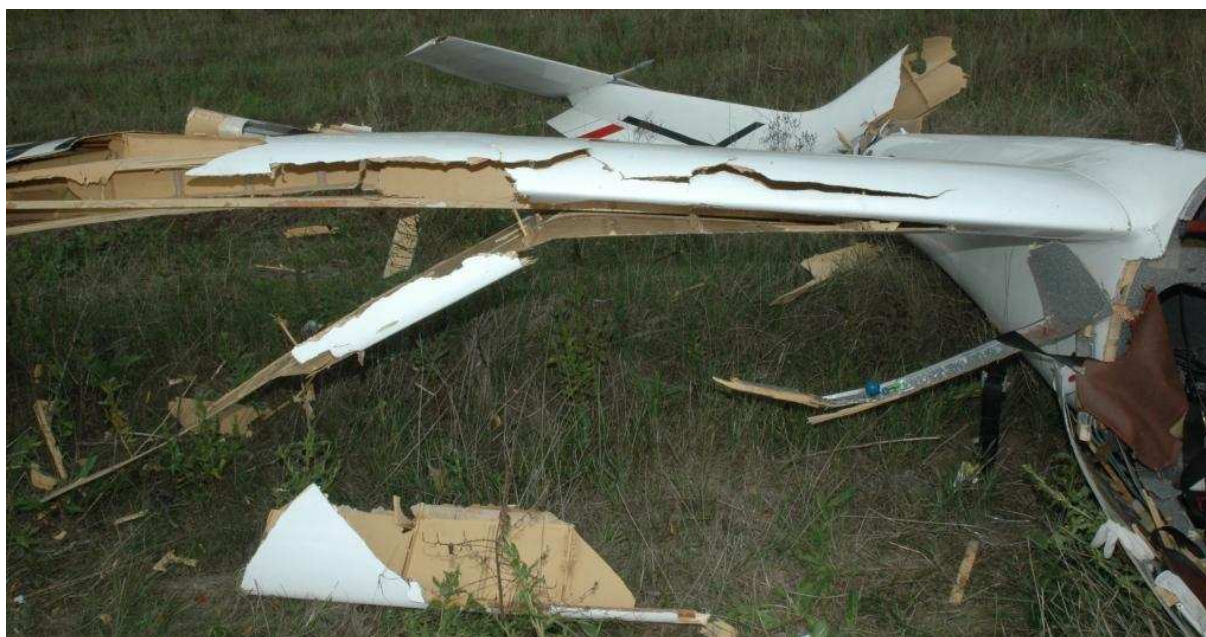
27 – Zniszczone prawe skrzydło od przodu, rejon środka i nasady.
