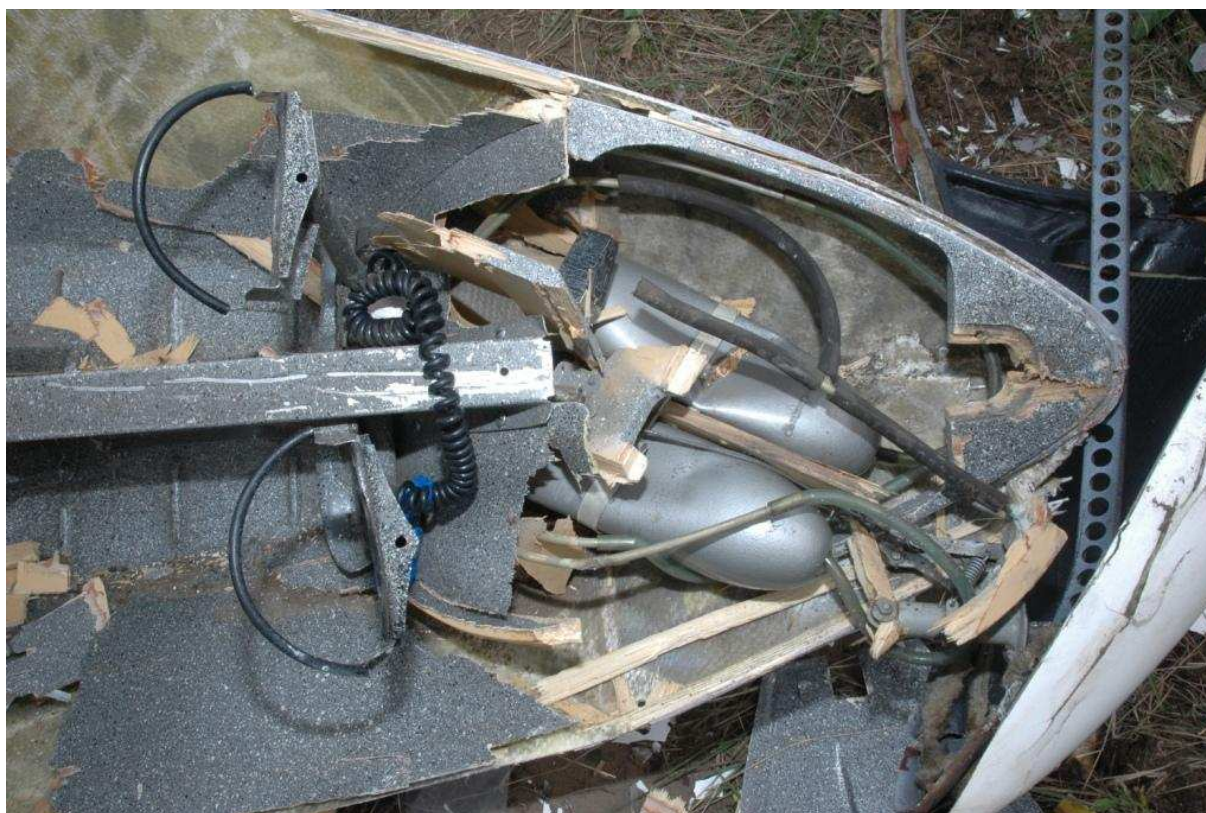
21 – Przednia część kabiny – widoczne zniszczone termosy i pedały sterowania sterem kierunku.
