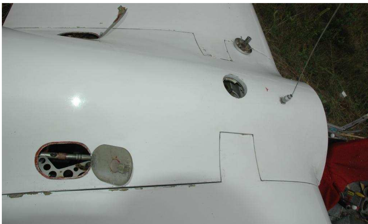
33 – Połączenie skrzydeł z kadłubem – widoczne otwarte pokrywki luków mocowania skrzydeł (po prawej stronie kadru) i luków połączeń układu sterowania (po lewej stronie kadru).
