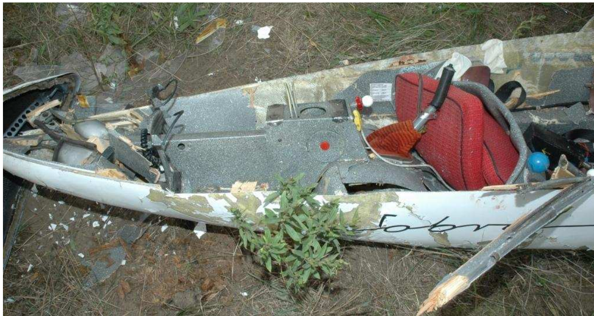
20 – Zniszczona kabina z lewej strony.
