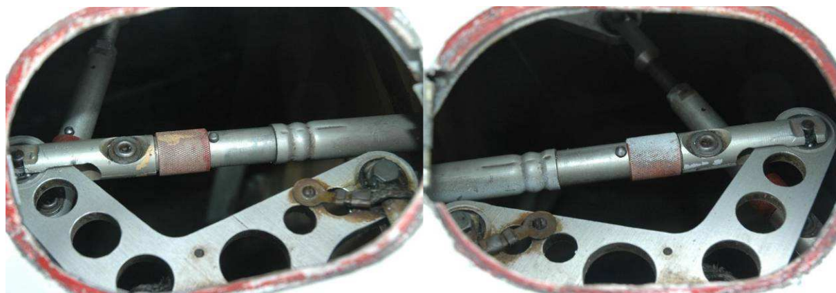
34 i 35 – Zbliżenie na wnętrza otwartych luków połączeń układu sterowania – widać zachowanie ciągłości układu sterowania.
