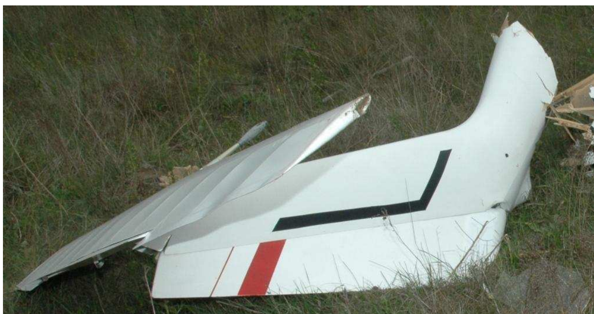
23 – Oderwana tylna część kadłuba z usterzeniem.
