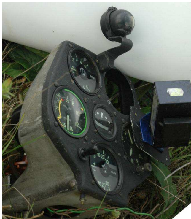
32 – Wyrwana z zamocowania tablica przyrządów.
