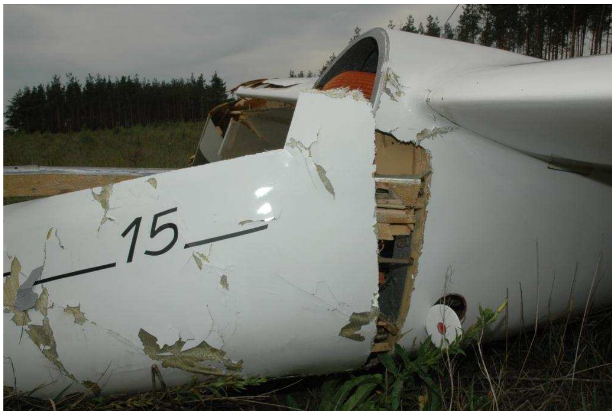
13 – Zbliżenie przełomu kadłuba na tylnej wrzędze części kabinowej, widoczne zniszczenie pokrycia lewej burty kabiny.
