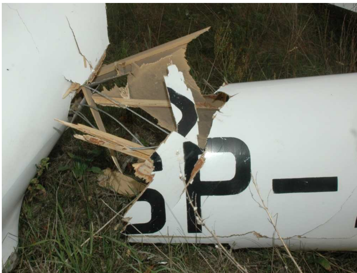
17 – Przełom tylnej części kadłuba w zbliżeniu z prawej strony – widoczna zachowana ciągłość układów sterowania.
