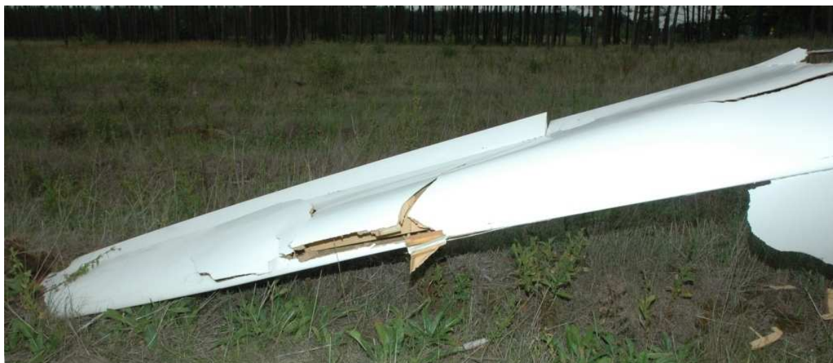
28 – Zniszczone prawe skrzydło w rejonie końcówki, wyraźnie wbite w ziemię.
