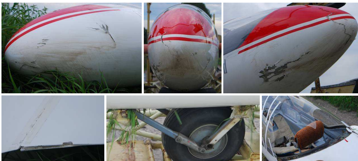
Rys.1 Widoczne uszkodzenia szybowca SZD-41B Jantar Std o znakach SP-3059
