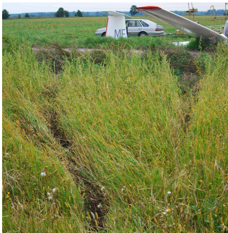
Rys.5 Ślady przyziemienia szybowca i jego położenie po dobiegu; widok w kierunku lądowania
