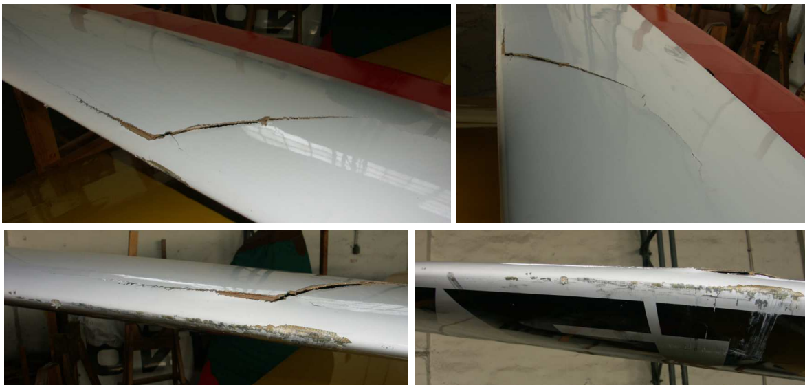
Rys.1 Widoczne uszkodzenia końcówki prawego skrzydła szybowca SZD-30 Pirat o znakach SP-2410
