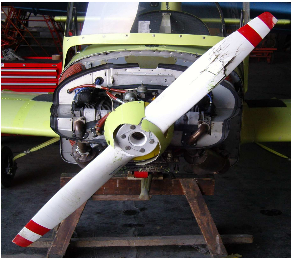
10 – Uszkodzone śmigło i silnik po zdjęciu osłon w hangarze.
