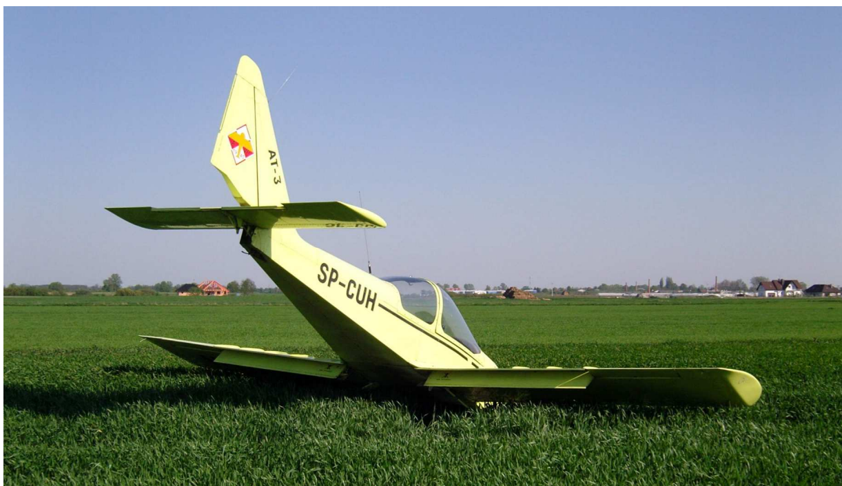
6 – Samolot na miejscu wypadku, widok ogólny. Zwracają uwagę kłapy wychylone do lądowania.
