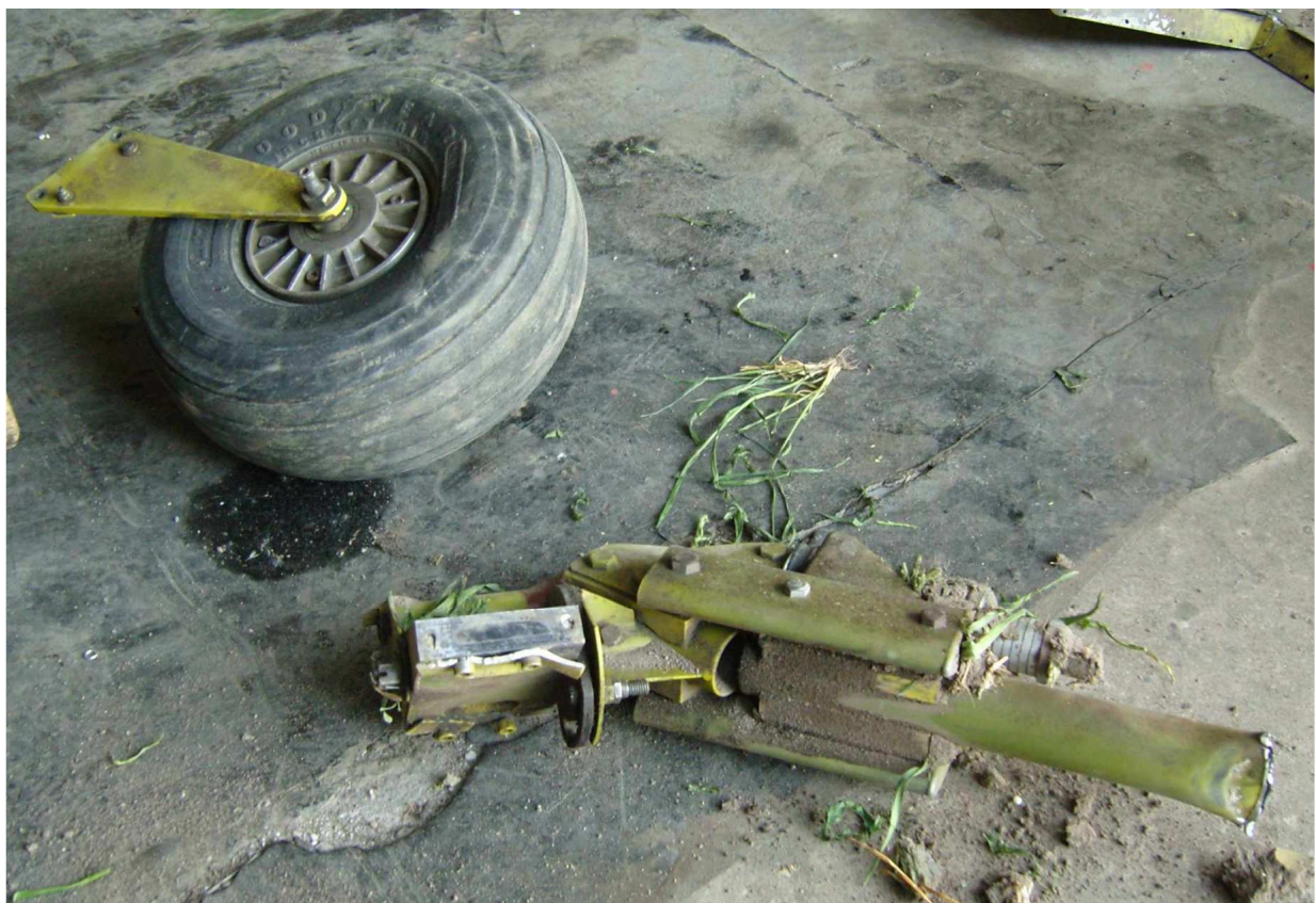
8 – Zniszczone podwozie przednie.
