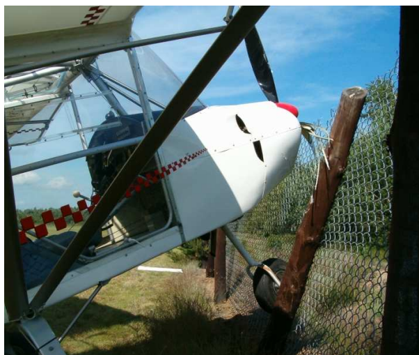
4 i 5 – Samolot po zderzeniu z ogrodzeniem lądowiska (metalowa siatka na drewnianych słupkach). Dobrze widoczne zniszczone łopaty śmigła.
