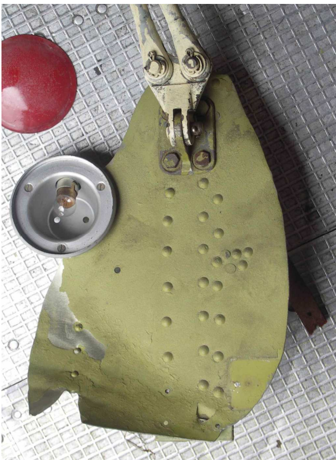
6, 7 – Wyrwany fragment ścianki wręgi wraz z zamocowaniem linek desantowych i wzmacnieniem: po lewej od strony kabiny, po prawej od strony tylnej części kadłuba
