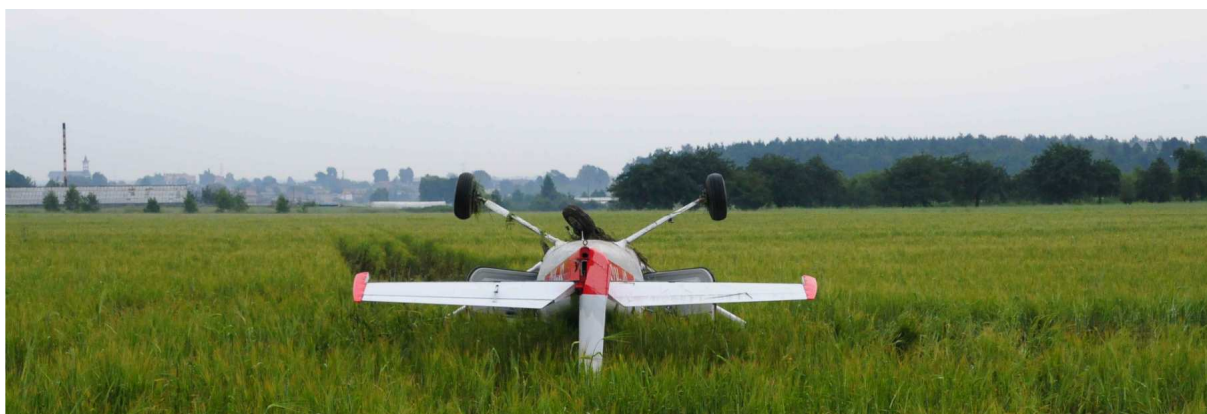
10 – Samolot po kapotażu, widok z tyłu.
