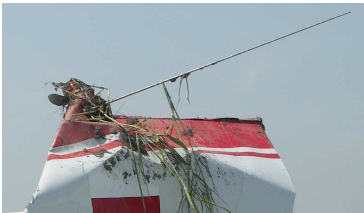
19 – Końcówka usterzenia pionowego (lewa strona) – widoczne uszkodzenia.
