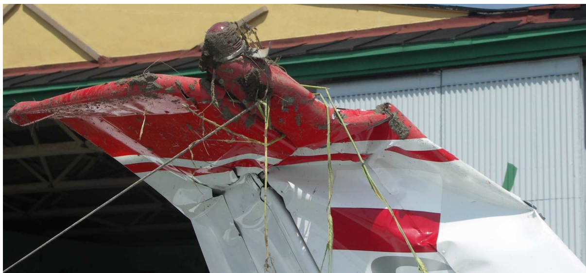
20 – Końcówka usterzenia pionowego (prawa strona) – widoczne uszkodzenia.
