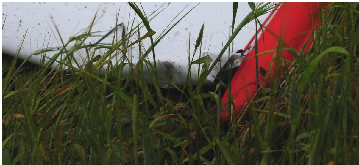
16 – uszkodzenia końcówki prawego skrzydła.
