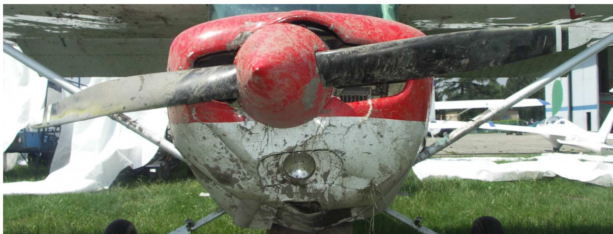
17 – Zniszczone śmigło i dolna osłona silnika.
