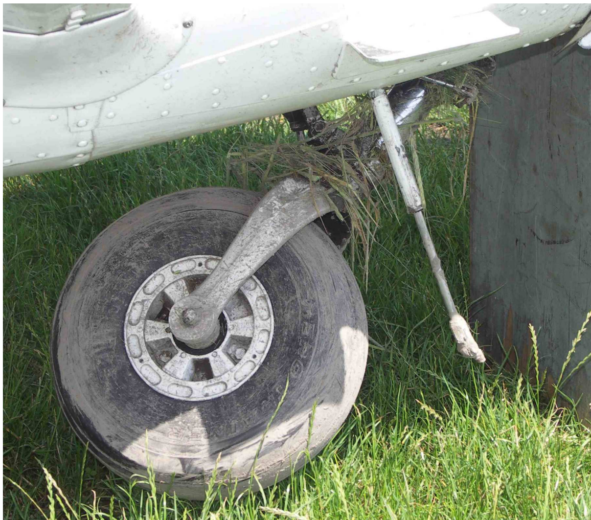
18 – Złamane podwozie przednie.
