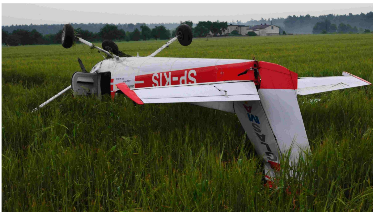
12 – Samolot po kapotażu, widok z tyłu na usterzenie (prawa strona).
