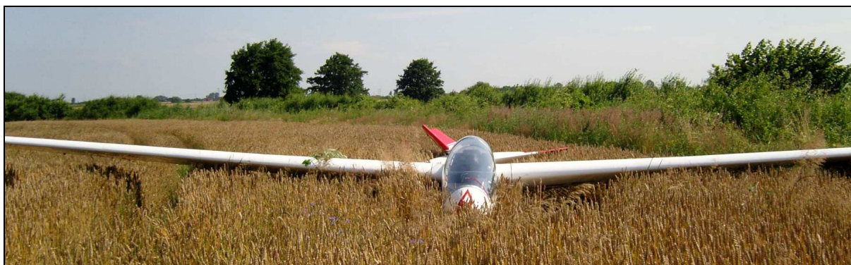
8 – Ogólny widok szybowca od przodu. Widoczne odłamane usterzenie.
