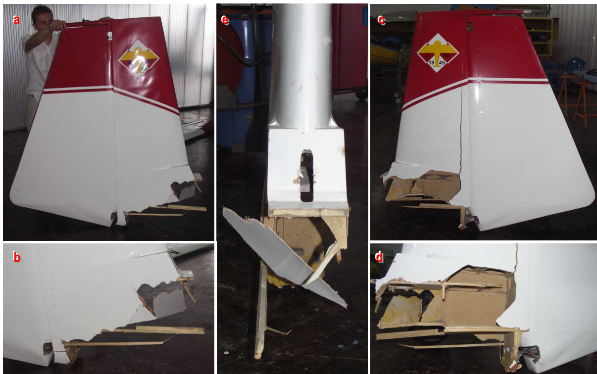
25 – Usterzenie pionowe: a – z prawej strony, b – zbliżenie uszkodzeń części dolnej z prawej strony, c – z lewej strony, d – zbliżenie uszkodzeń części dolnej z prawej strony, e – zbliżenie uszkodzeń części dolnej od przodu.
