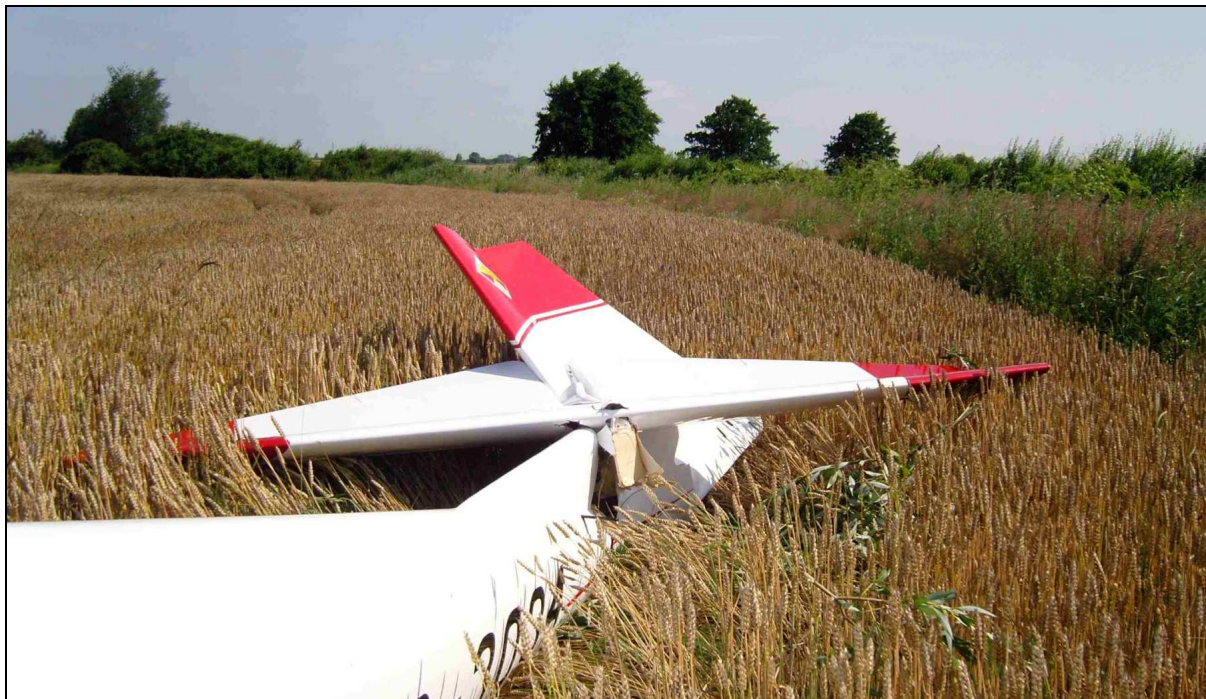
12 – Tylna część kadłuba szybowca z odłamanym usterzeniem.
