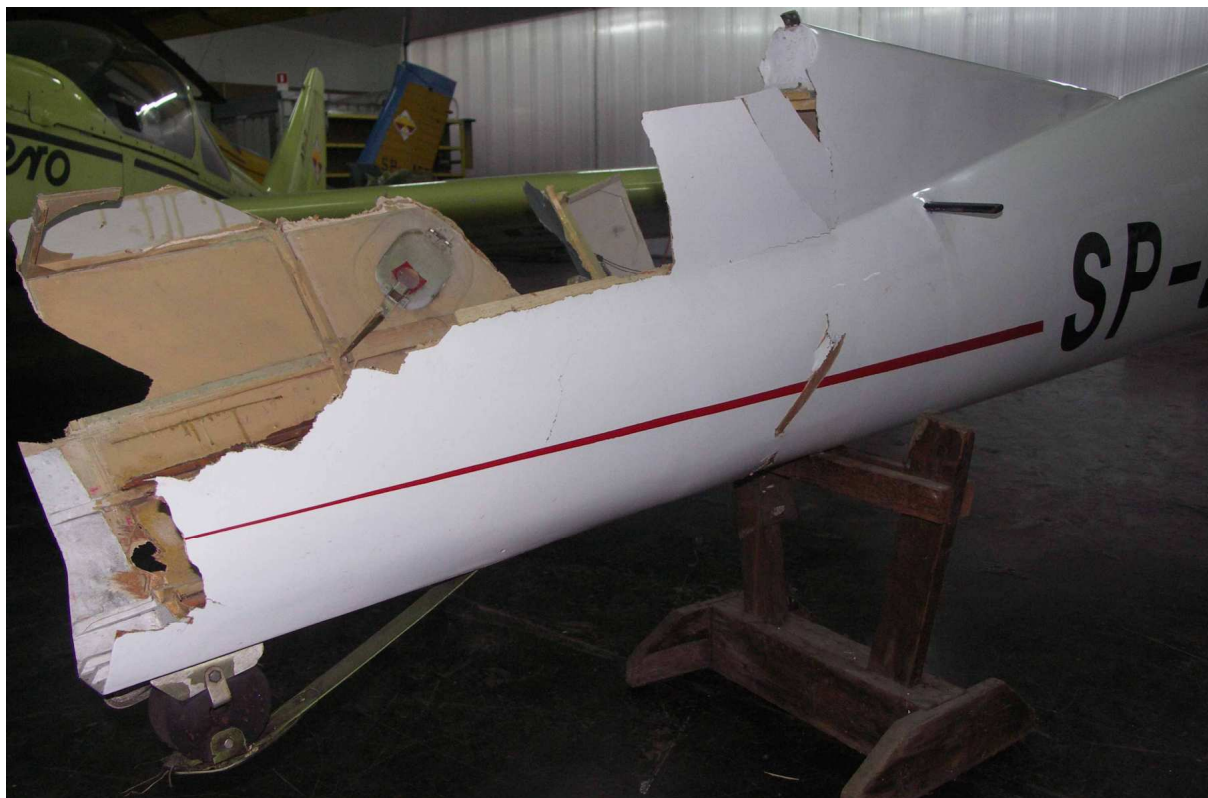
15 – Tylna część kadłuba – przełom od góry z prawej strony.
