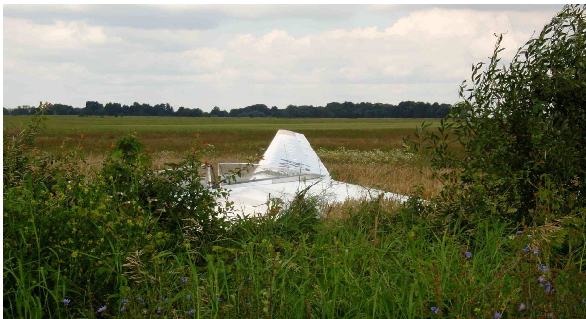
9 – Widok miejsca wypadku w kierunku zbliżonym do kierunku lądowania. Po prawej stronie kadru widoczny większy krzew, który ominęło prawe skrzydło szybowca.
