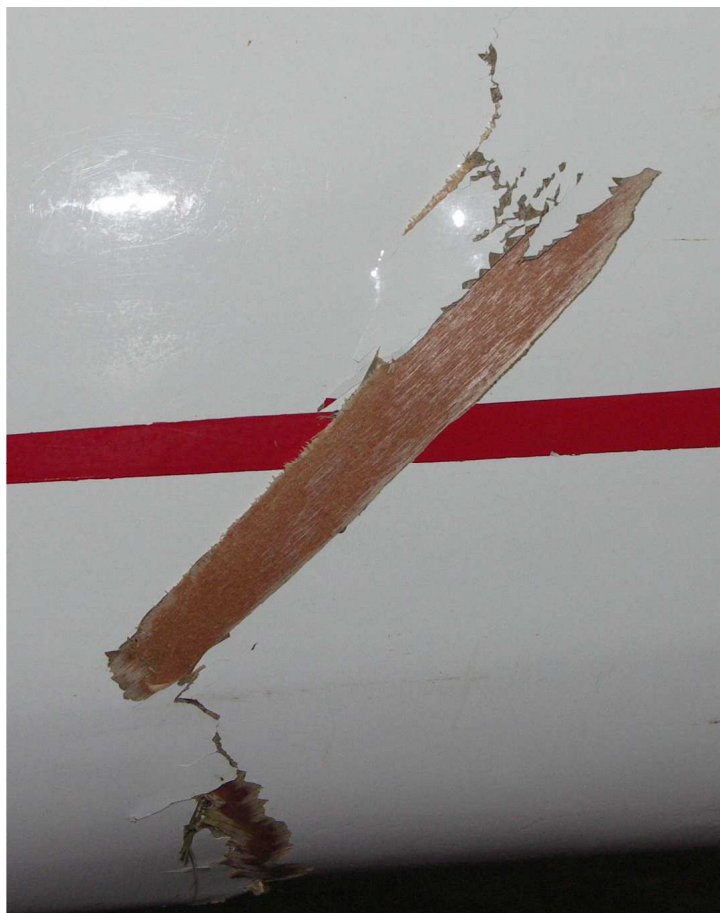
16 – Pęknięcie pokrycia po prawej stronie kadłuba.
