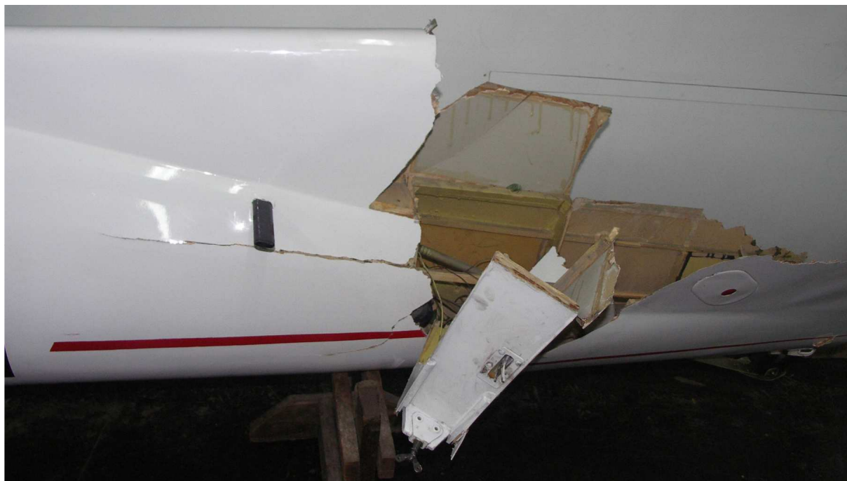
14 – Tylna część kadłuba – przełom od góry z lewej strony.
