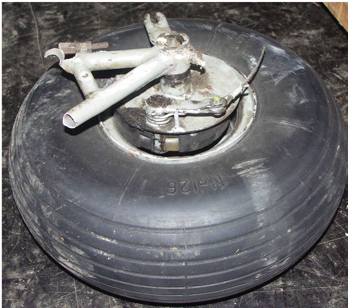
21 – Oderwane koło podwozia z fragmentami widelca.
