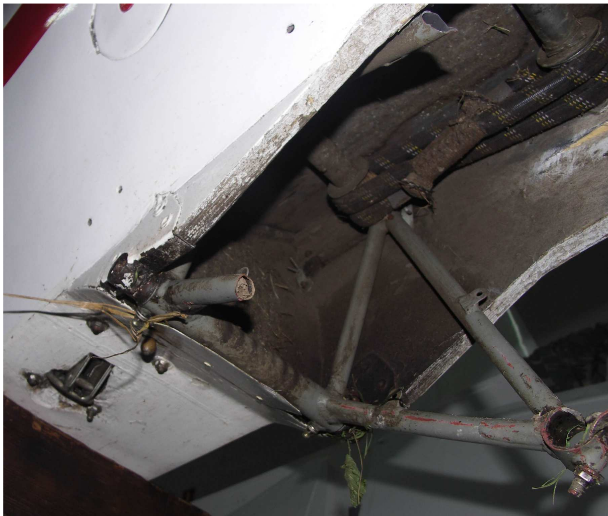
19 – Wnęka podwozia, część przednia. Widoczny zniszczony widelec koła.
