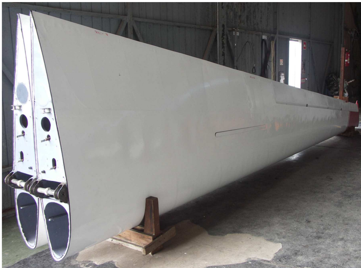
27 – Skrzydła (zdemontowane) – widoczne górna powierzchnia lewego skrzydła od strony żebra nasadowego.
