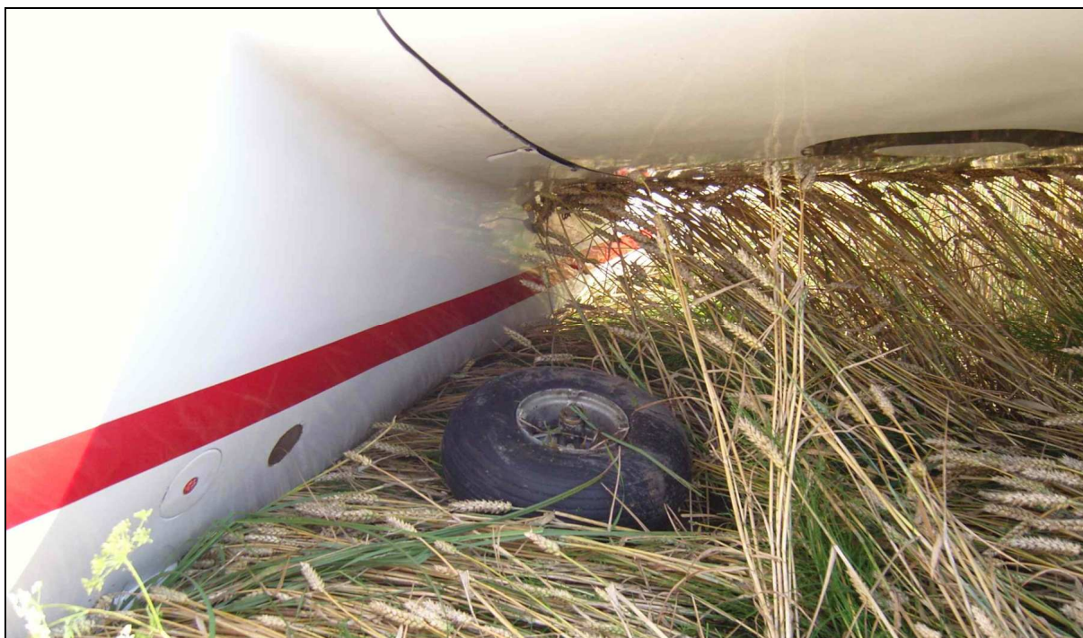
13 – Koło podwozia, oderwane podczas przyziemienia z trawersem.
