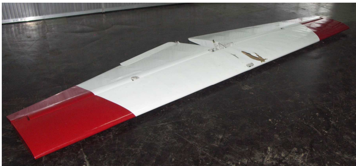
22 – Usterzenie poziome, widok od dołu z lewej strony.
