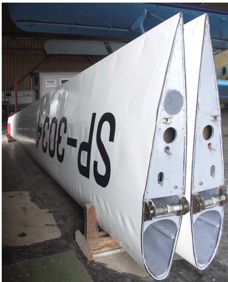
26 – Skrzydła (zdemontowane) – widoczne górna powierzchnia prawego skrzydła od strony żebra nasadowego.
