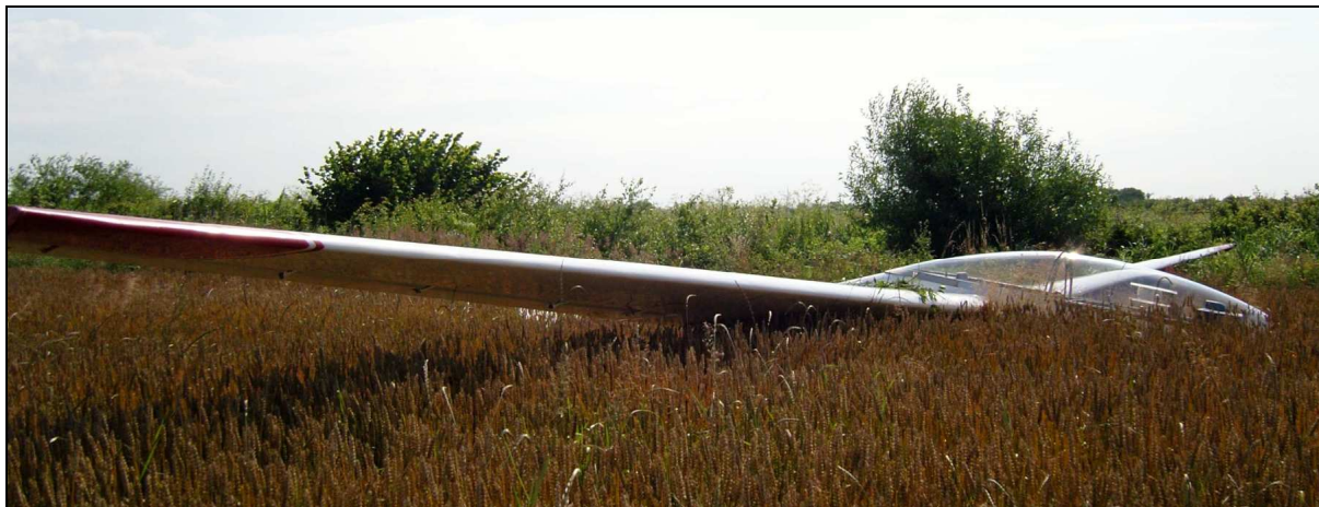
6 – Miejsce wypadku, widok ogólny szybowca. Nad oszkleniem kabiny widoczny większy krzew, który ominęło prawe skrzydło szybowca.
