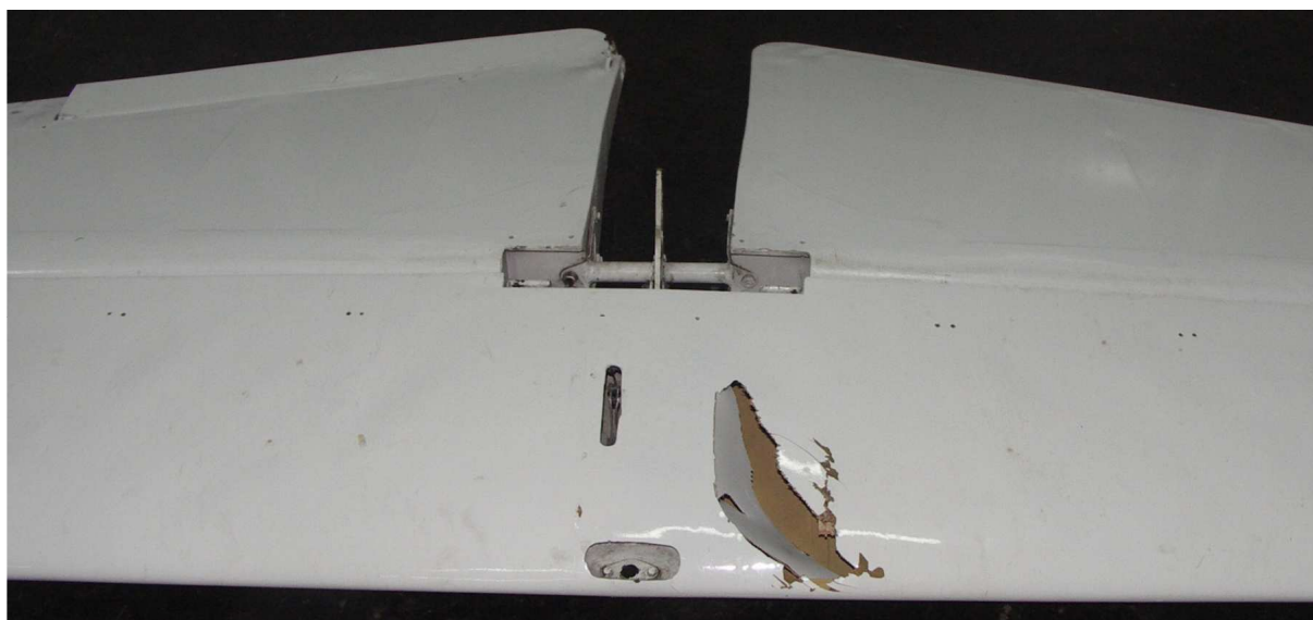
24 – Usterzenie poziome, widok od dołu, zbliżenie na uszkodzenia części środkowej.
