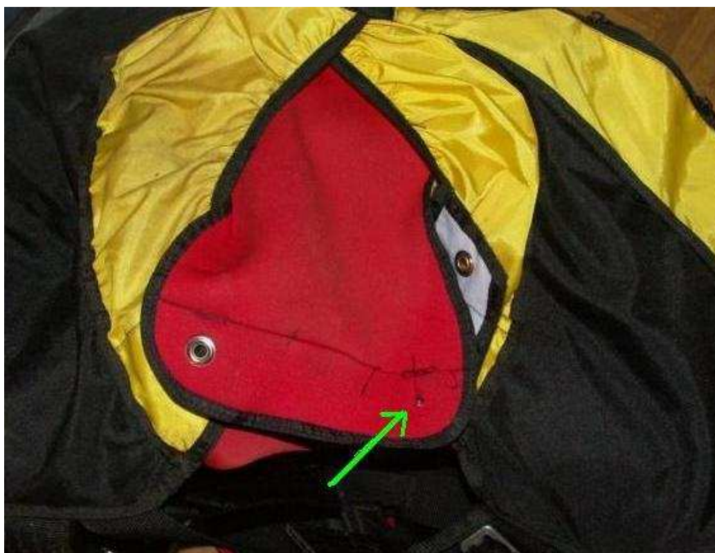
Rys. 2. Strzałka wskazuje uszkodzenia zapięcia komory spadochronu specjalnego przeznaczenia- wyrwane oczko. Z mocowania została wyrwana również gumka.
