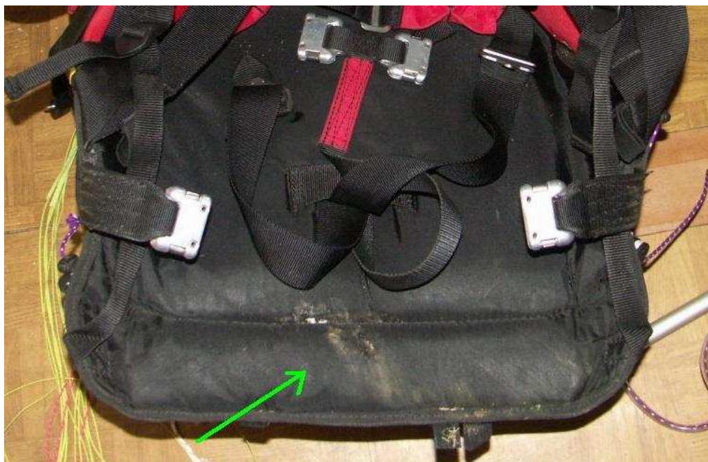
Rys. 1. Strzałka wskazuje uszkodzenie i ślady otarcia na siedzisku upręży.
