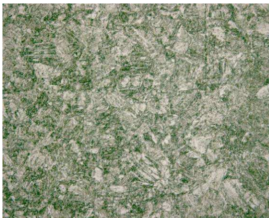
Fot. 43. Struktura stali noża końcówki tnącej MD-1 Powiększenie 200 x.
