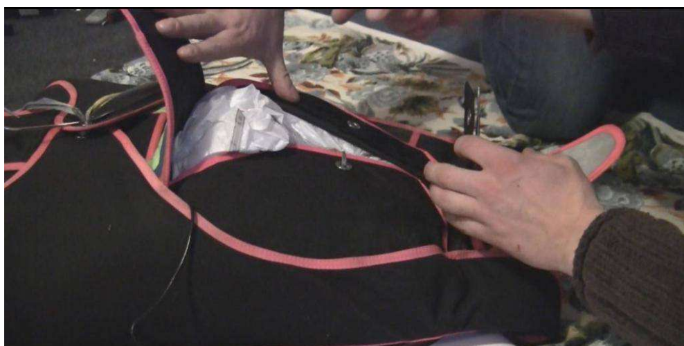
Fot. 12. Aby zidentyfikować przyczynę nieotwarcia komory czaszy zapasowej, ręcznie odchyłono wyłogi komory, z wyjątkiem ostatniego – prawego wyłogu, do którego wewnętrznej strony zamocowana była końcówka tnąca automatu.
