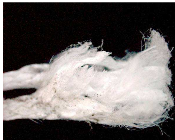
fot. 27. Widoczne częściowe przecięcie i częściowe rozerwanie pętli zamykającej zabezpieczonej na miejscu wypadku.
