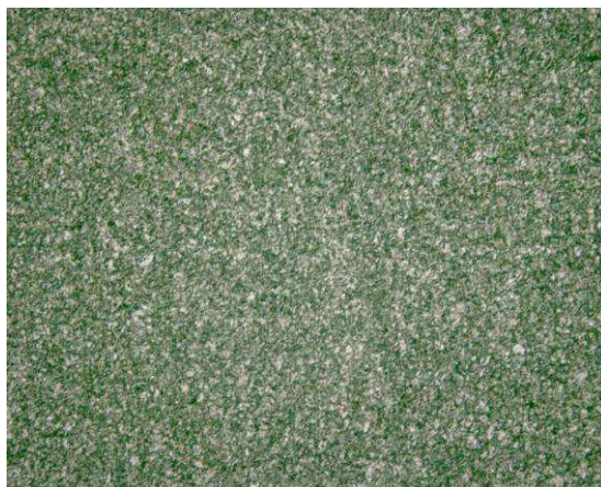
Fot. 45. Struktura stali noża porównawczej końcówki tnącej MP-2 Powiększenie 200 x.
