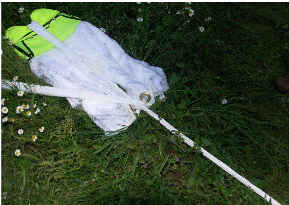
fot. 2. Widok czaszy zapasowej częściowo wysuniętej z osłony oraz osłony z taśmą łączącą oplatającą linki.
