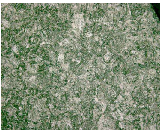
Fot.48. Struktura stali noża porównawczej końcówki tnącej MP-3-III. Powiększenie 200 x.
