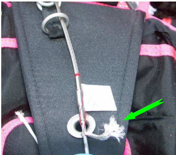
fot. 4. Widok zawleczki uchwytu otwierania czaszy zapasowej i górnej części pętli zamykającej. Zielona strzałka wskazuje postrzępiony koniec rozdzielonej pętli zamykającej.
