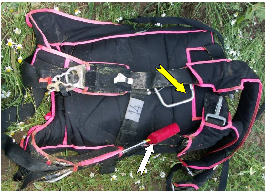
fot. 7. Widok na plecową część pokrowca. Na uprzęży widoczne niewyciągnięte uchwyty wyczepiania czaszy głównej (biała strzałka) i otwierania czaszy zapasowej (żółta strzałka).
