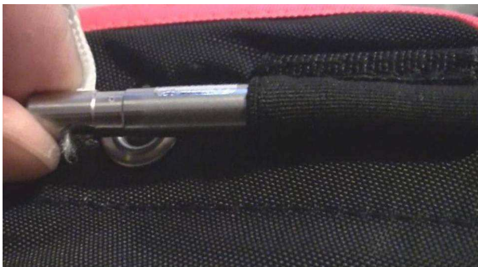
Fot. 17. Dobrze widoczne włókna górnej części pętli zamykającej, wystające z końcówki tnącej.
