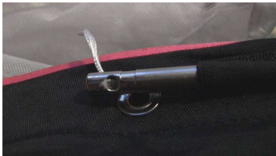
Fot. 16. Górna, zerwana ręcznie część pętli zamykającej wskazuje, że końcówka tnąca przecięła tylko część włókien.
