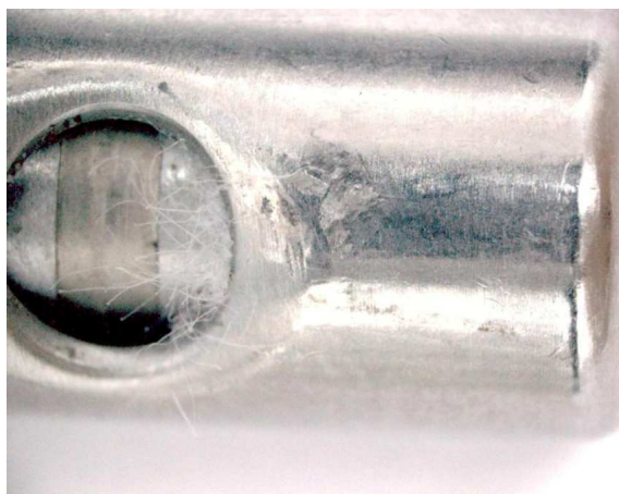
fot. 26. Widoczne włókna pętli zamykającej, wystające z otworu końcówki tnącej zabezpieczonej na miejscu wypadku.
