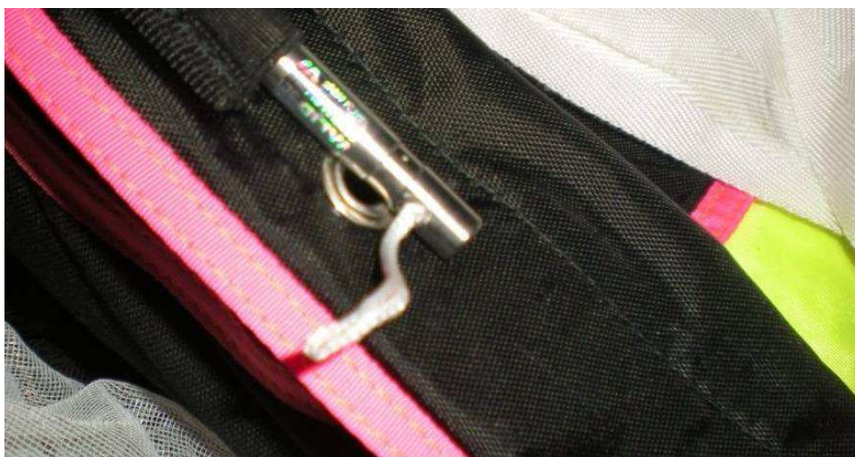
Fot. 18. Widoczna część pętli zamykającej pozostała zakleszczona w końcówce tnącej.
