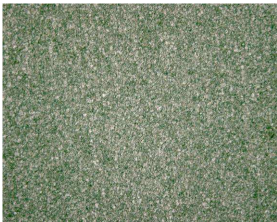
Fot. 44. Struktura stali noża porównawczej końcówki tnącej MP-1 Powiększenie 200 x.
