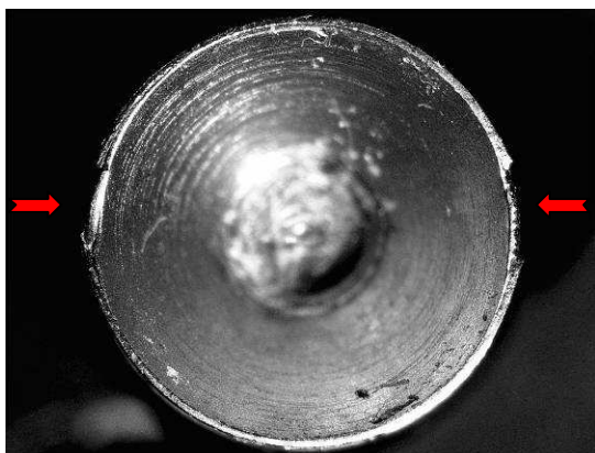
fot. 28. Widok noża od strony ostrza, końcówki tnącej zabezpieczonej na miejscu wypadku. Czerwone strzałki wskazują miejsca uszkodzeń krawędzi tnącej ostrza noża.
