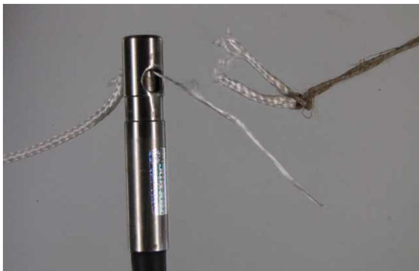
Fot. 39. Widok końcówki tnącej MP-5 i dwóch fragmentów pętli, po przeprowadzeniu eksperymentalnego odpalenia końcówki.
