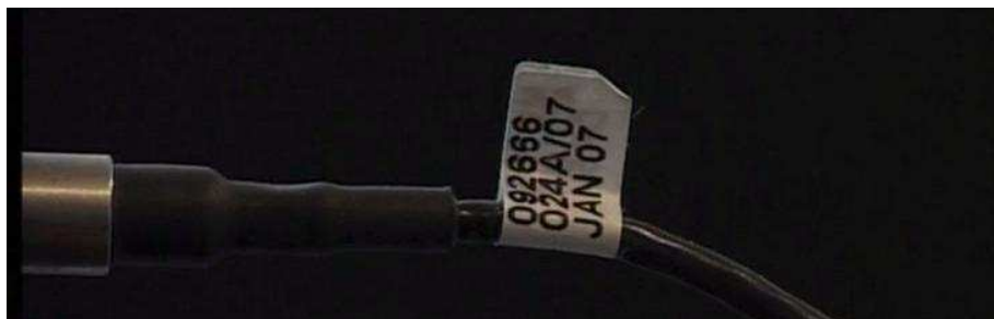
Fot. 32. Końcówka tnąca MP-5 wykorzystana do przeprowadzenia próby pod obciążeniem z siłą 5 kG.
