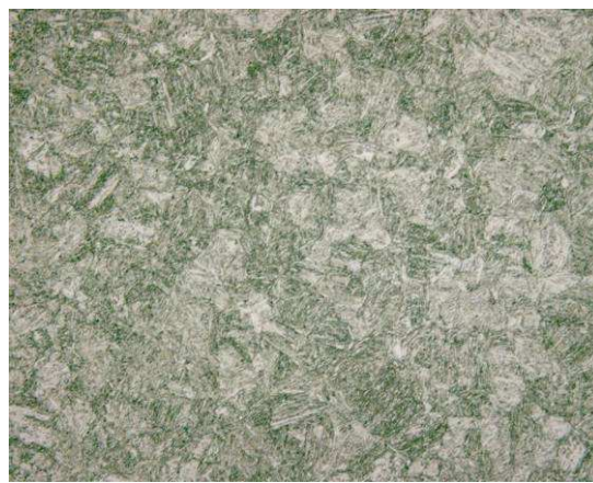
Fot. 47. Struktura stali noża porównawczej końcówki tnącej MP-3-II. Powiększenie 200 x.
