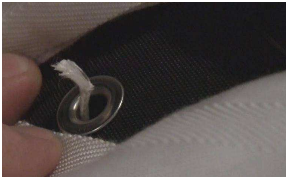
Fot.20. Zbliżenie dolnej części pętli zamykającej. Dobrze widoczne nierówne końcówki włókien.
