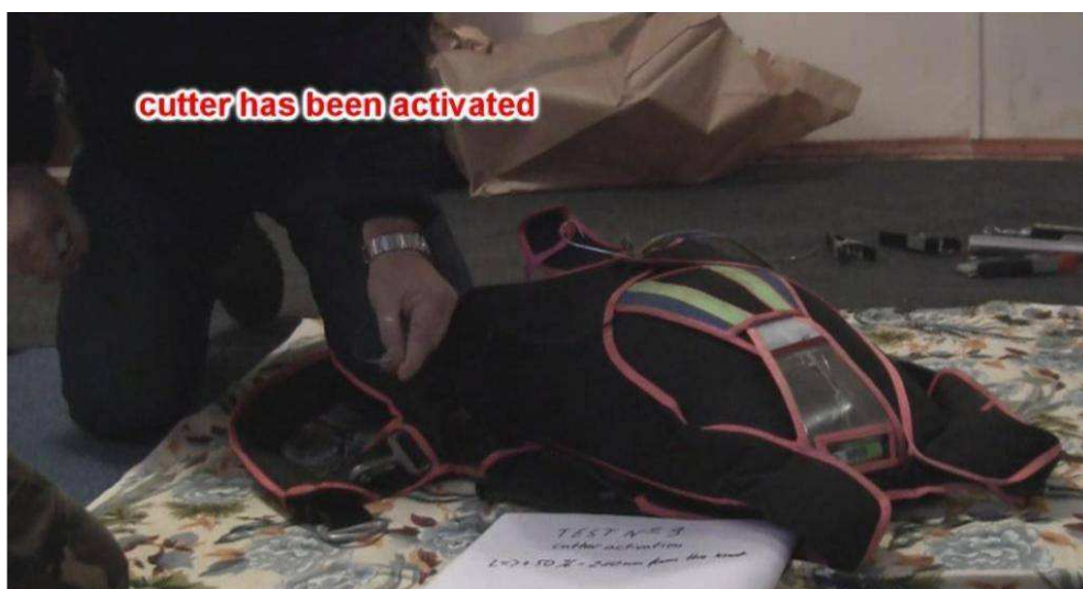
Fot 10. Spadochron chwilę po zainicjowaniu końcówki tnącej. Komora czaszy zapasowej nadal pozostawała zamknięta.
