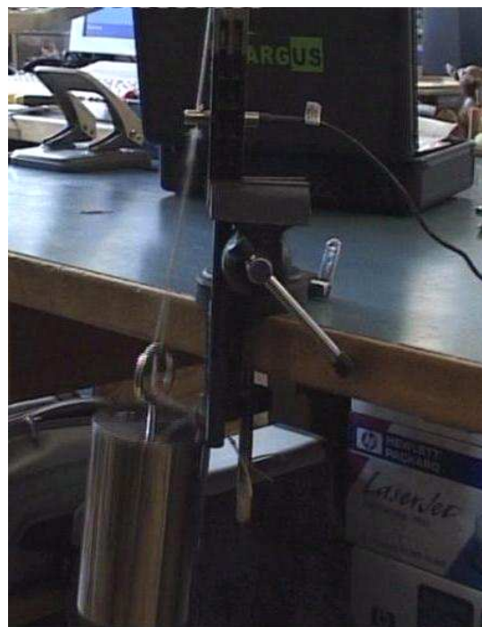
Fot. 34. Widok końcówki tnącej MP-5 i pętli w chwili zadziałania ładunku miotającego.
