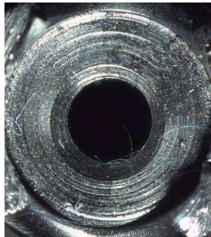
Fot. 41. Brak kolistego wgłębienia w dnie korpusu odpowiadającego średnicy noża.
