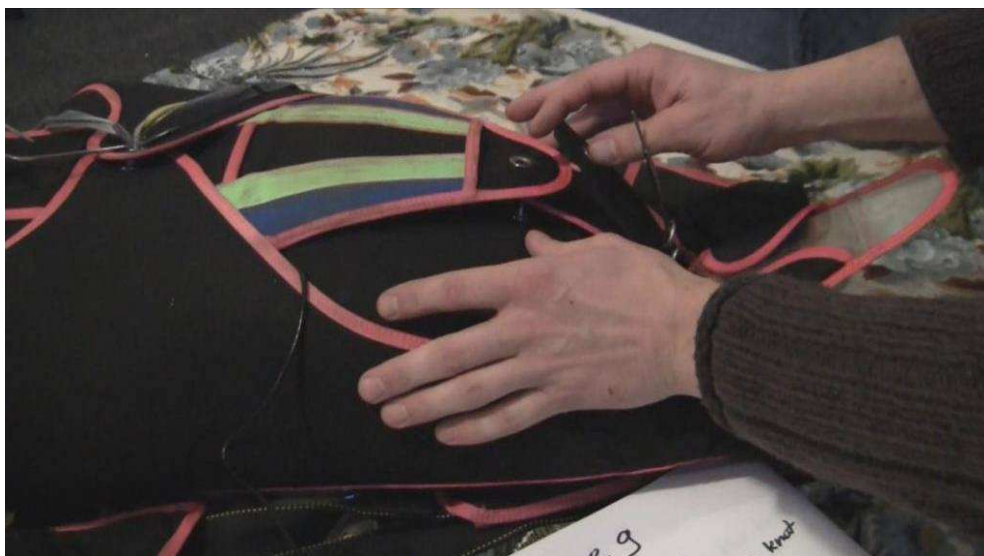
Fot. 11. Stan spadochronu chwilę po wyjęciu zawlecзки zamykającej komorę czaszy zapasowej.
