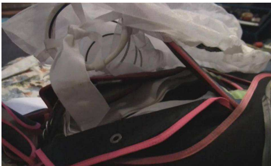
Fot. 15. Po ręcznym zerwaniu pętli zamykającej nastąpił start pilocika.
