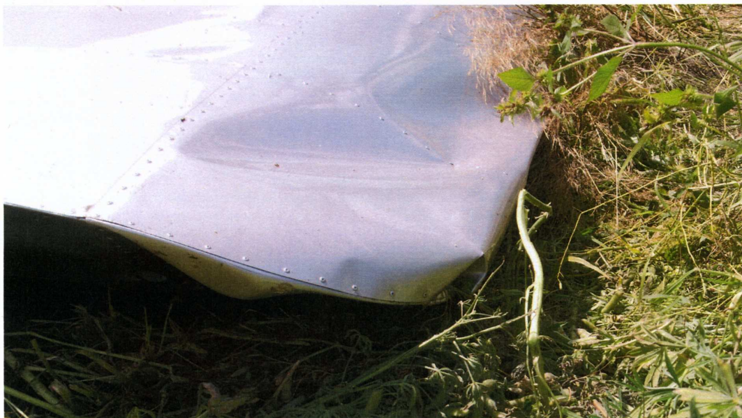
Fot. 4 Widok uszkodzeń usterzeń poziomego i pionowego
