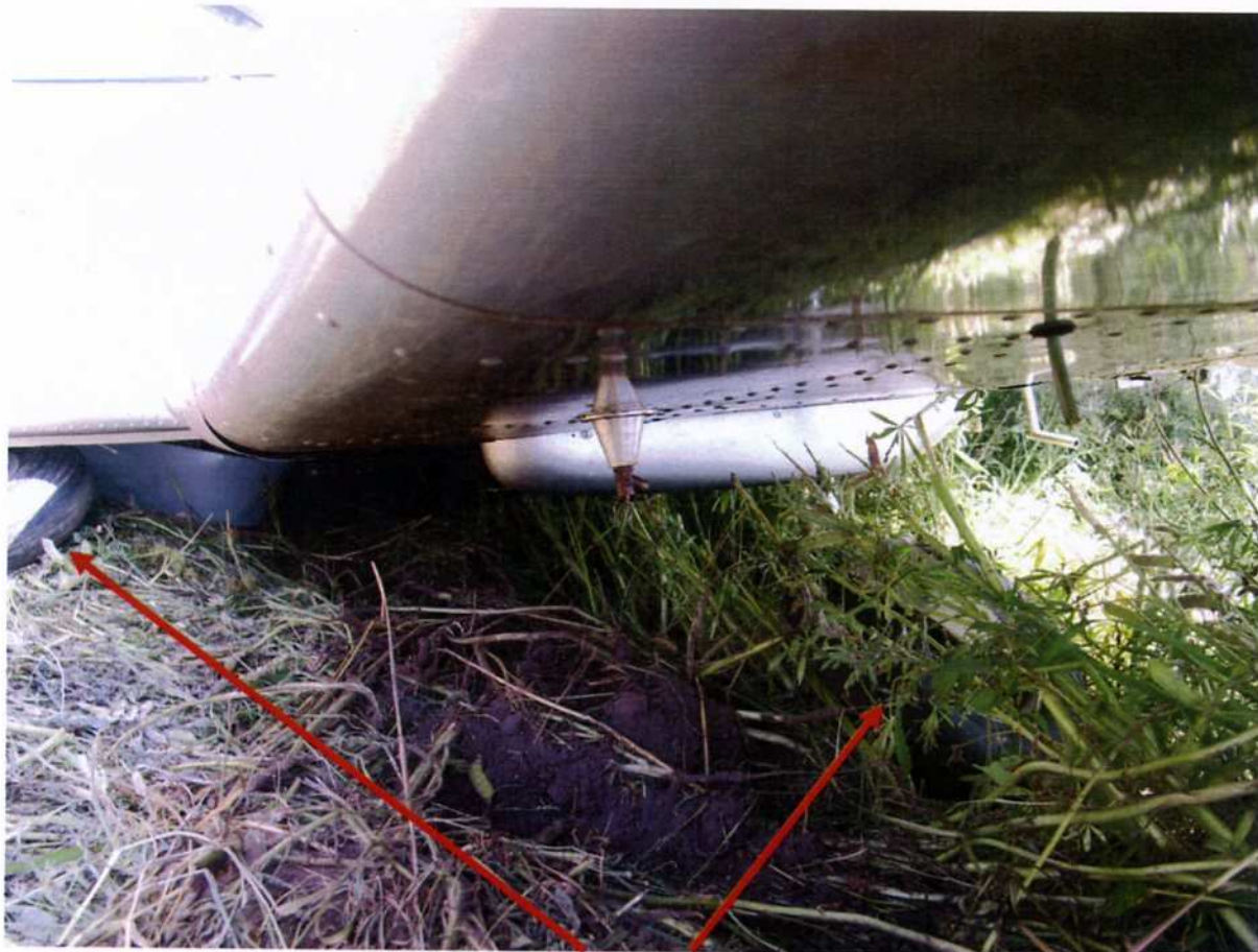
Fot. 6 Złamane przednia i lewa goleń podwozia
