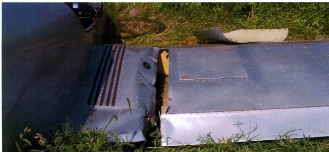
Fot. 3 Uszkodzone połączenie prawego skrzydła z centroplatem
