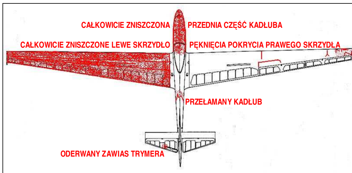
Schematycznie zaznaczone zniszczenia i uszkodzenia struktury szybowca w wyniku wypadku.
