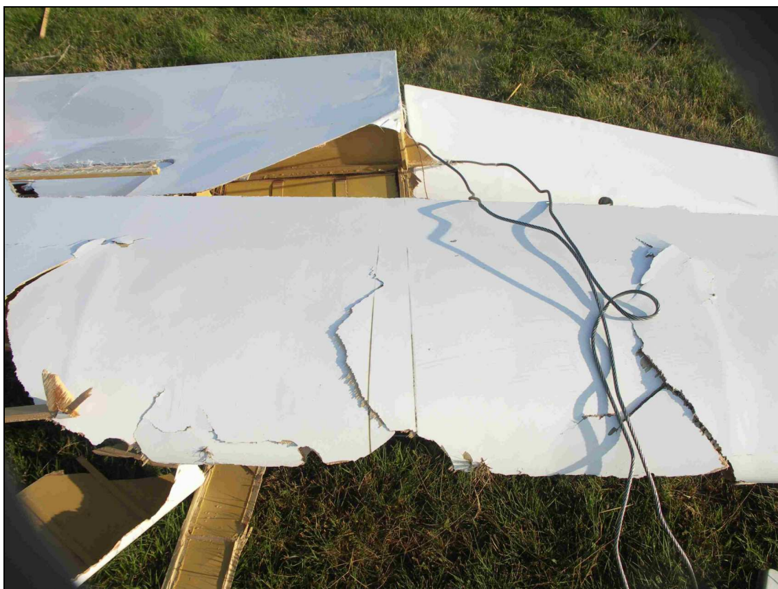
Ślad szarpnięcia liną holowniczą zaczepioną o lotkę na zniszczonym pokryciu kesonu lewego skrzydła [foto: T.Makowski, PKBWL].
