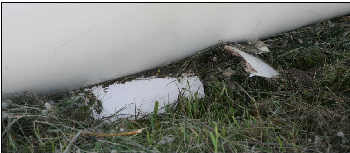
12 – Uszkodzone pokrywy luku podwozia, prawa strona.
