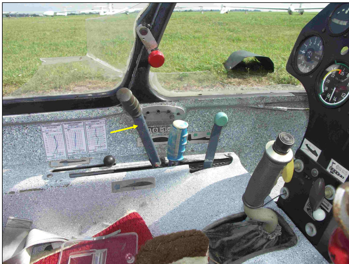
14 – Wnętrze kabiny, lewa strona. Dźwignia sterowania klapami w położeniu startowym (+2°). Widoczne potłuczone oszklenie kabiny. Na zewnątrz widoczna osłona tablicy przyrządów; w tle – szybowce oczekujące na start.
