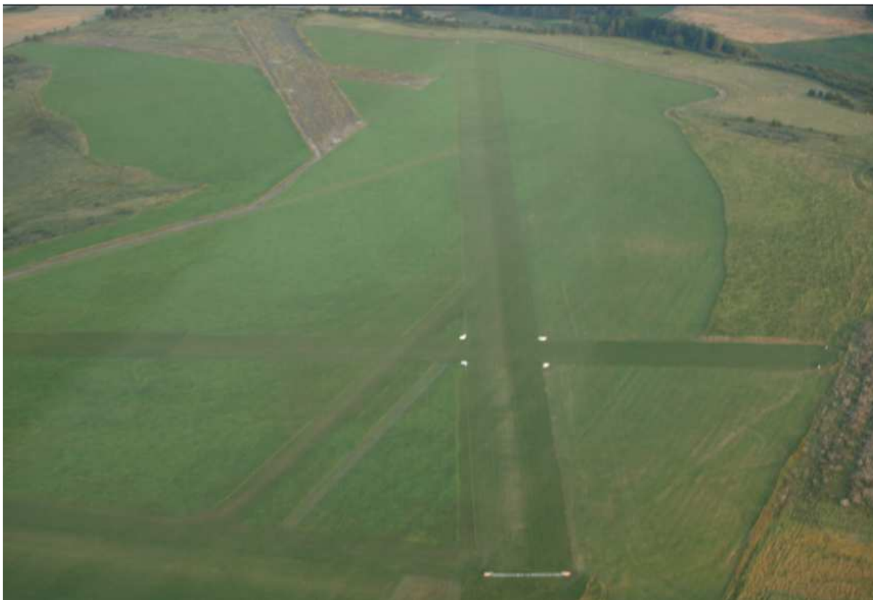
Oznaczenie lotniska w dniu zdarzenia - brak właściwego oznaczenia pola wlotów
