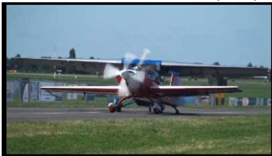
Moment uderzenia śmigłem w usterzenie poziome samolotu Extra 300L
