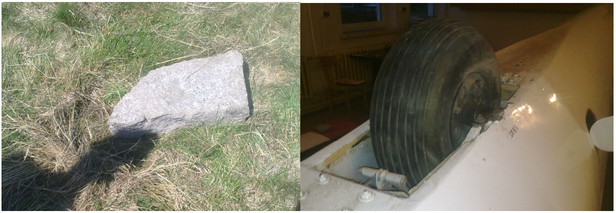
Fot. 1 Zdjęcie kamienia na który wkołował szybowiec podczas dobiegu oraz uszkodzenia mocowania osi podwozia (zdjęcia nadesłane przez zgłaszającego).
