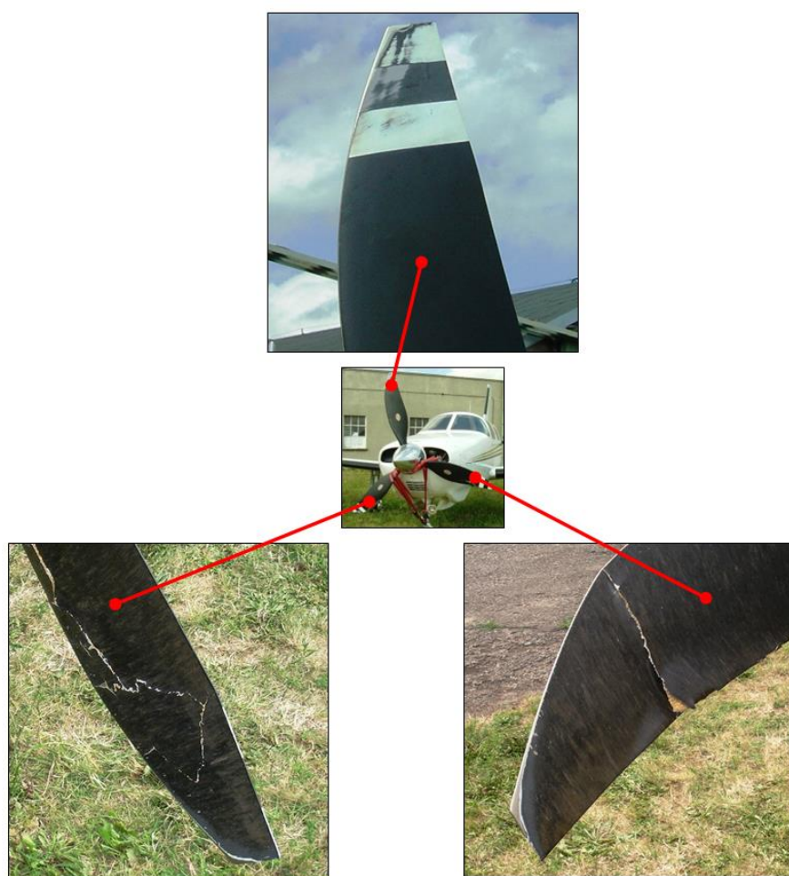
Rys. 7. Uszkodzenia łopat śmigła samolotu
