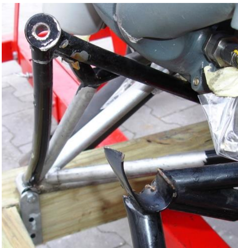
Rys. 15. Elementy mocowania siłownika chowania przedniego podwozia (zdjęcie wykonane po zdemontowaniu z samolotu ok. 1,5 miesiąca po zdarzeniu) [zdjęcie – organizacja obsługi]
