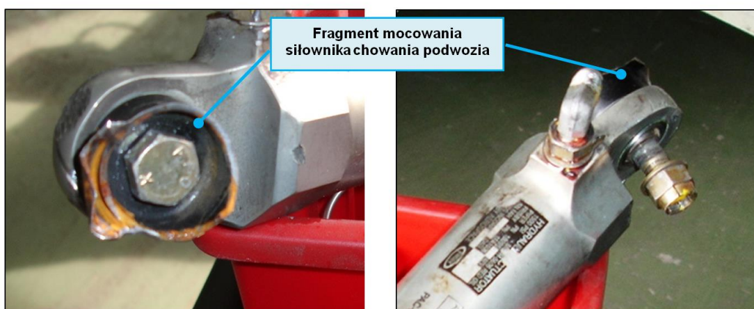
Rys. 13, 14. Ucho siłownika z fragmentem mocowania (zdjęcie wykonane po zdemontowaniu z samolotu ok. 1,5 miesiąca po zdarzeniu) [zdjęcie – organizacja obsługi]
