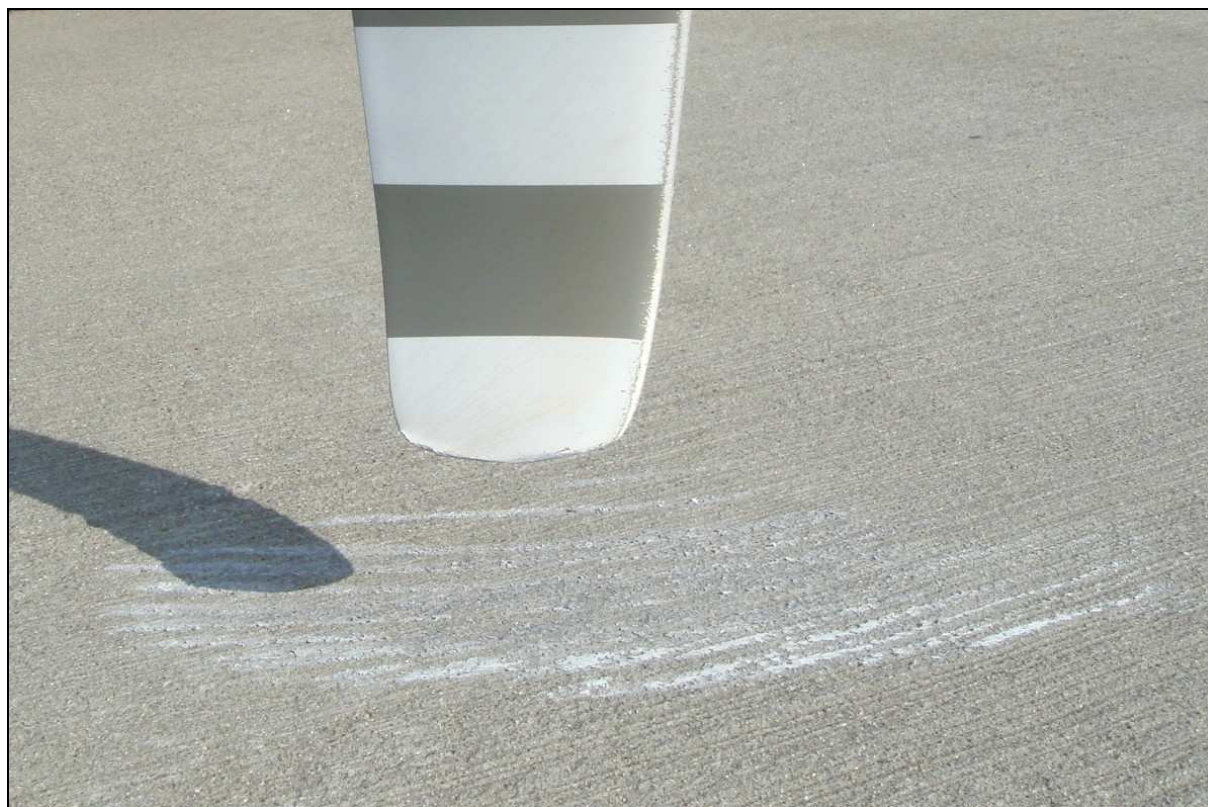
5 – Zniszczona końcówka łopaty śmigła. Widoczne ślady kontaktu śmigła z nawierzchnią betonową.
