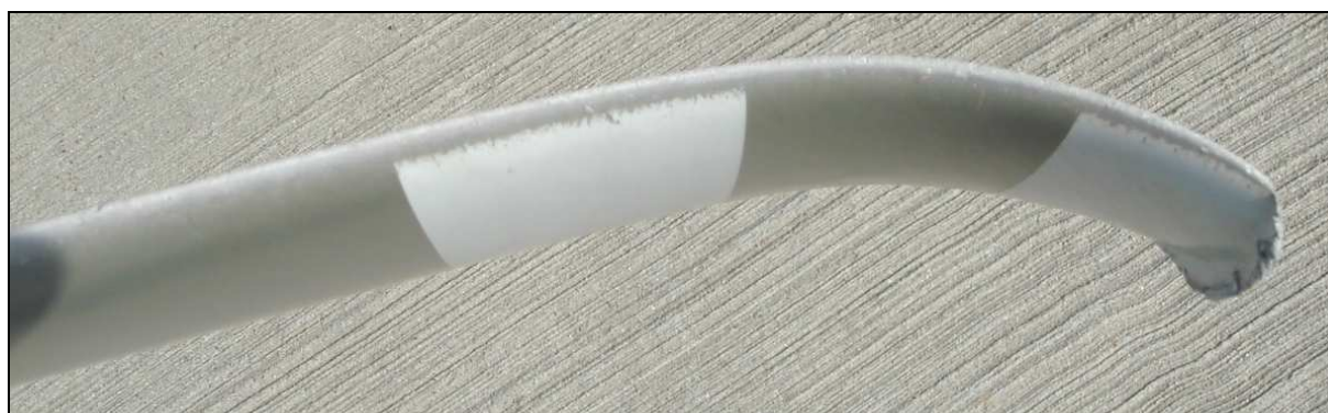
4 – Zniszczona końcówka łopaty śmigła.
