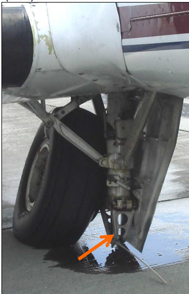
7, 8, 9 – Lewe podwozie główne ze złamanym trzonem amortyzatora goleni i zgiętą górną połówką nożyc (strzałka).
