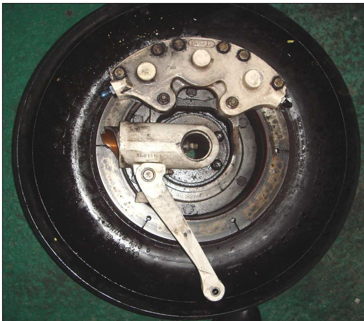
11 – Koło lewego podwozia głównego, zdemontowane wraz z odłamaną częścią goleni i dolną połówką nożyc.
