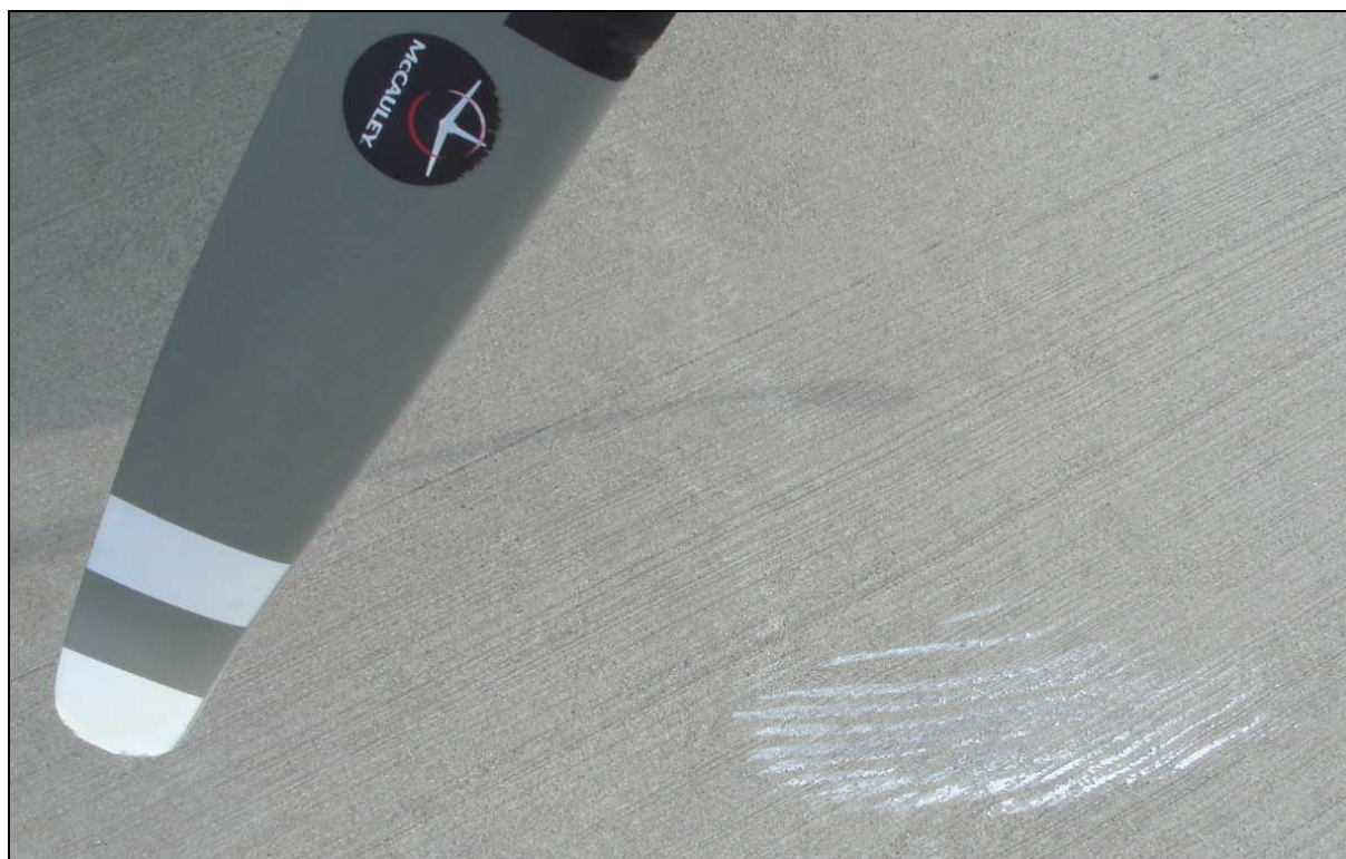
6 – Zniszczona końcówka łopaty śmigła. Widoczne ślady kontaktu śmigła z nawierzchnią betonową.
