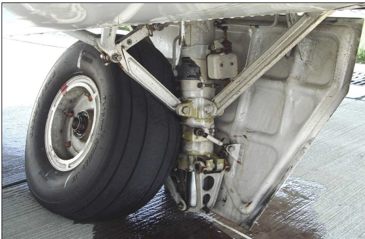
7, 8, 9 – Lewe podwozie główne ze złamanym trzonem amortyzatora goleni i zgiętą górną połówką nożyc (strzałka).
