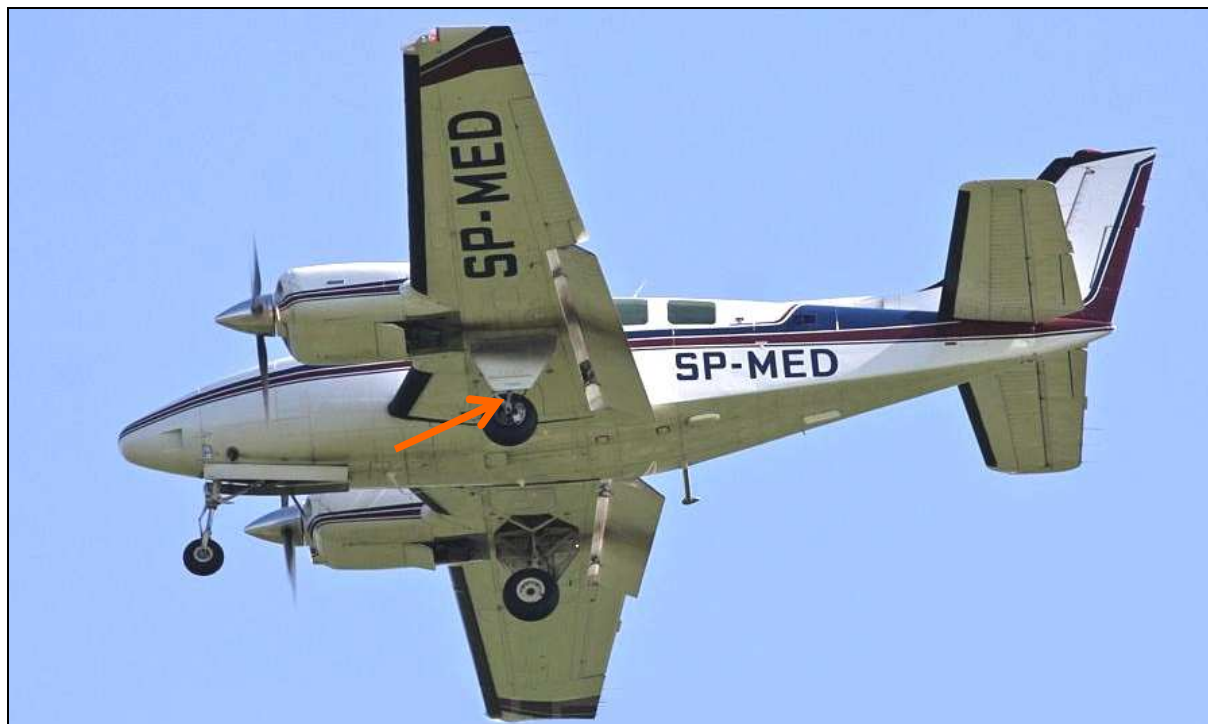
1 – Samolot sfotografowany w okresie poprzedzającym zdarzenie. Strzałką zaznaczone miejsce, gdzie nożyce lewego podwozia głównego uderzały w trzon amortyzatora, powodując pęknięcie. [fot.P.Gębski]
