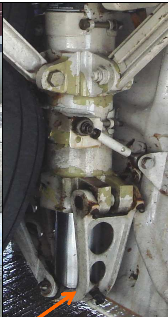
7, 8, 9 – Lewe podwozie główne ze złamanym trzonem amortyzatora goleni i zgiętą górną połówką nożyc (strzałka).
