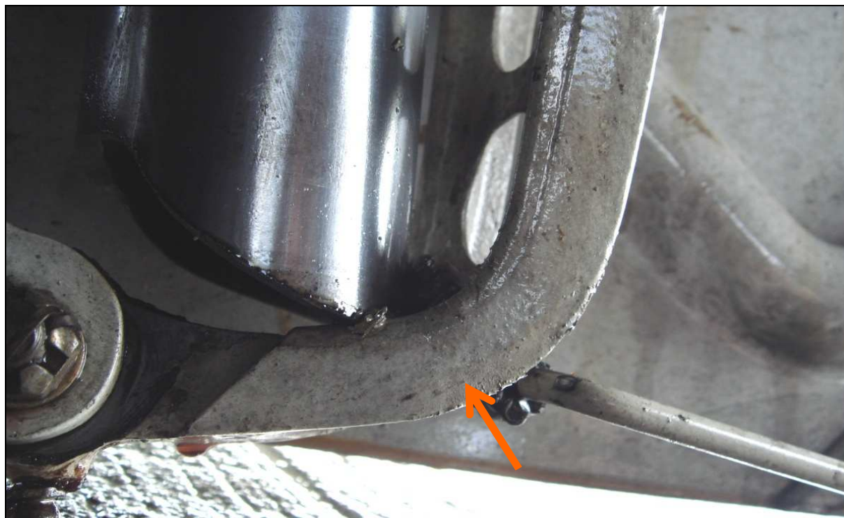
10 – Zbliżenie z lewej strony na przełom trzonu amortyzatora i zgiętą górną połówkę nożyc (wskazaną strzałką).
