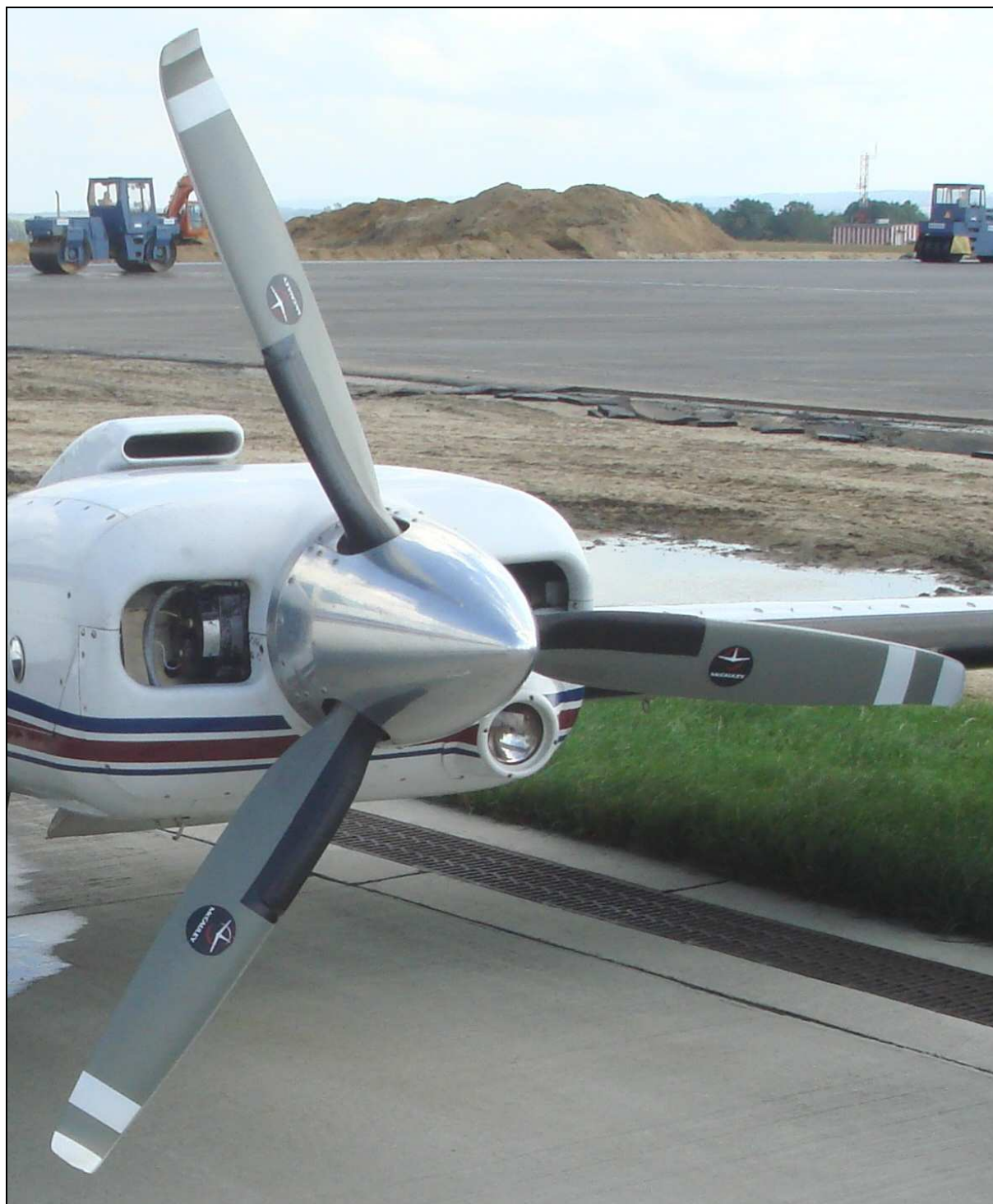
3 – Ogólny widok lewego śmigła ze zniszczonymi łopatom.
