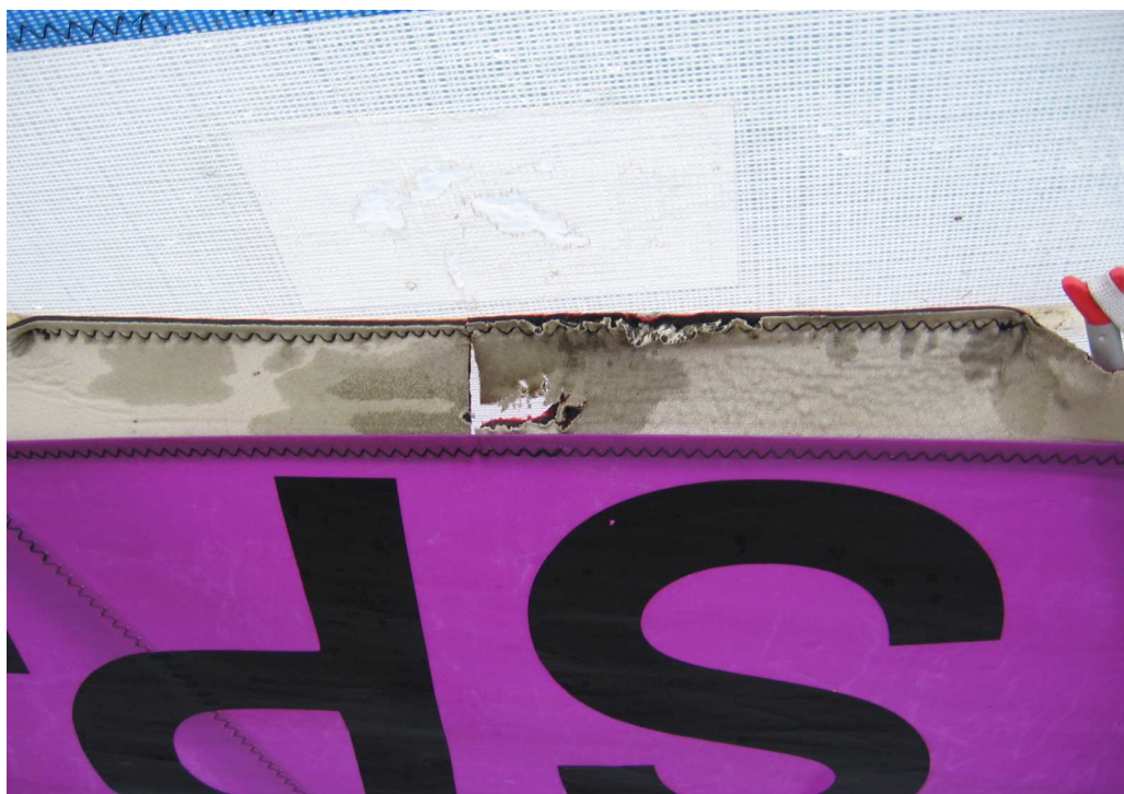
Fot.2. Widok fragmentu krawędzi spływu. Uwagę zwraca fatalny stan neoprenu.
