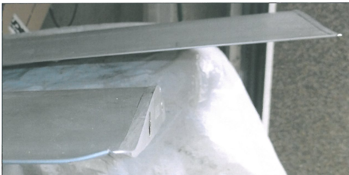
22 – Końcówki obu łopat wirnika, widoczne uszkodzenia krawędzi splywu przy końcówce jednej z nich.
