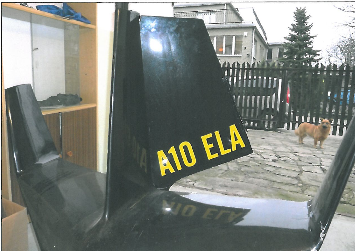
23 – Uszkodzenia usterzenia, powstałe podczas załadunku i transportu z miejsca wypadku.
