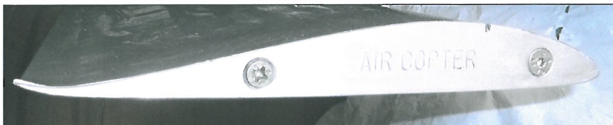
19 – Końcówka jednej z łopat wirnika, odkształcona na krawędzi spływu.
