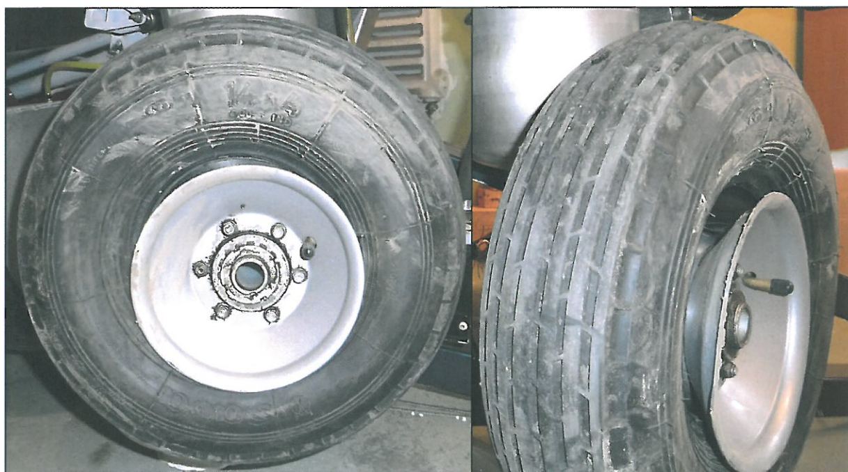
14, 15 – Uszkodzenie koła podwozia głównego (pęknięta dętka ogumienia, uszkodzona-wgięta na krawędzi obręcz).
