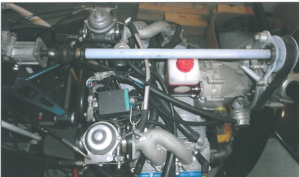
32 – Górna część silnika od góry, widoczna przekładnia napędu rozkręcania wirnika przed startem i wałek wzdłużny z gumowym tłumikiem drgań skrętnych (po lewej stronie kadru).
