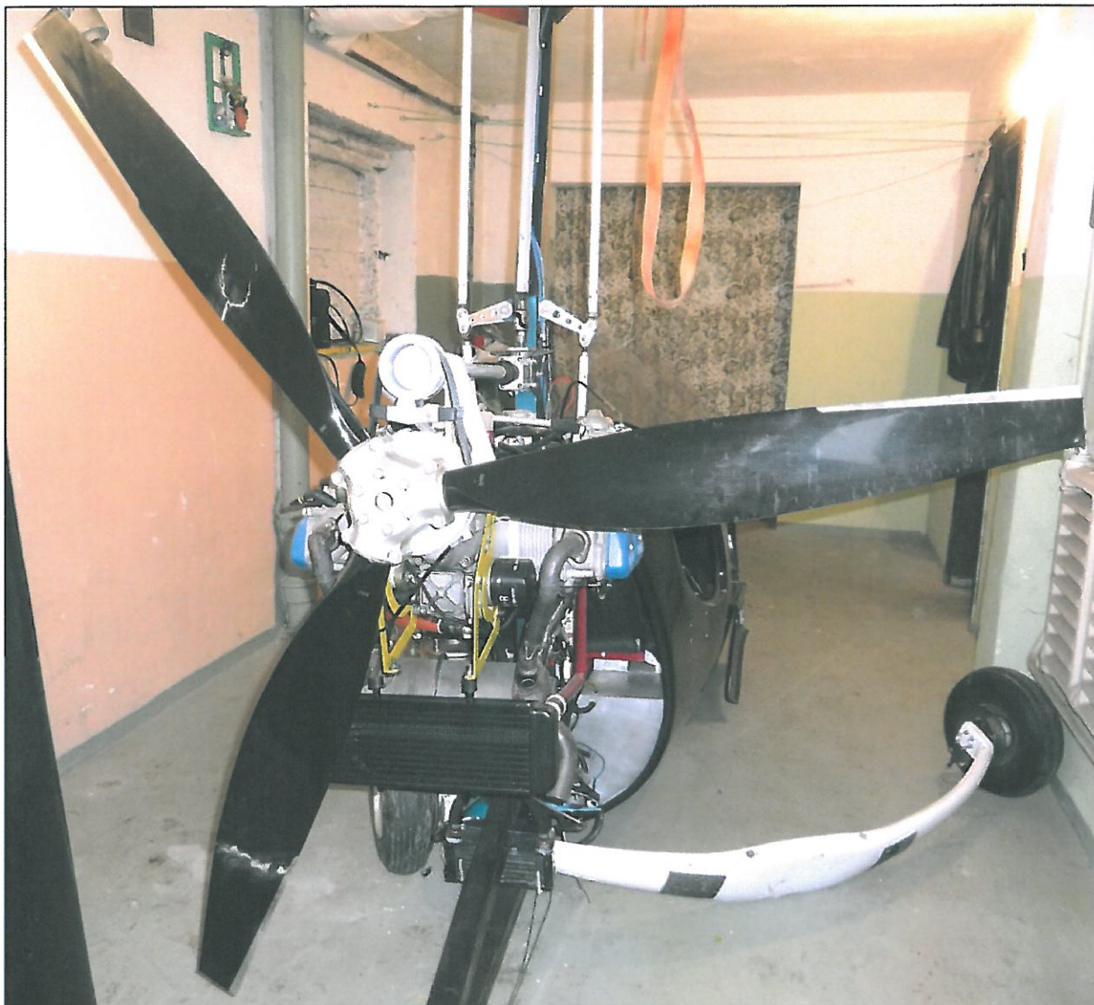
11 – Zniszczone śmigło i zdemontowane po uszkodzeniu zamocowań podwozie główne.
