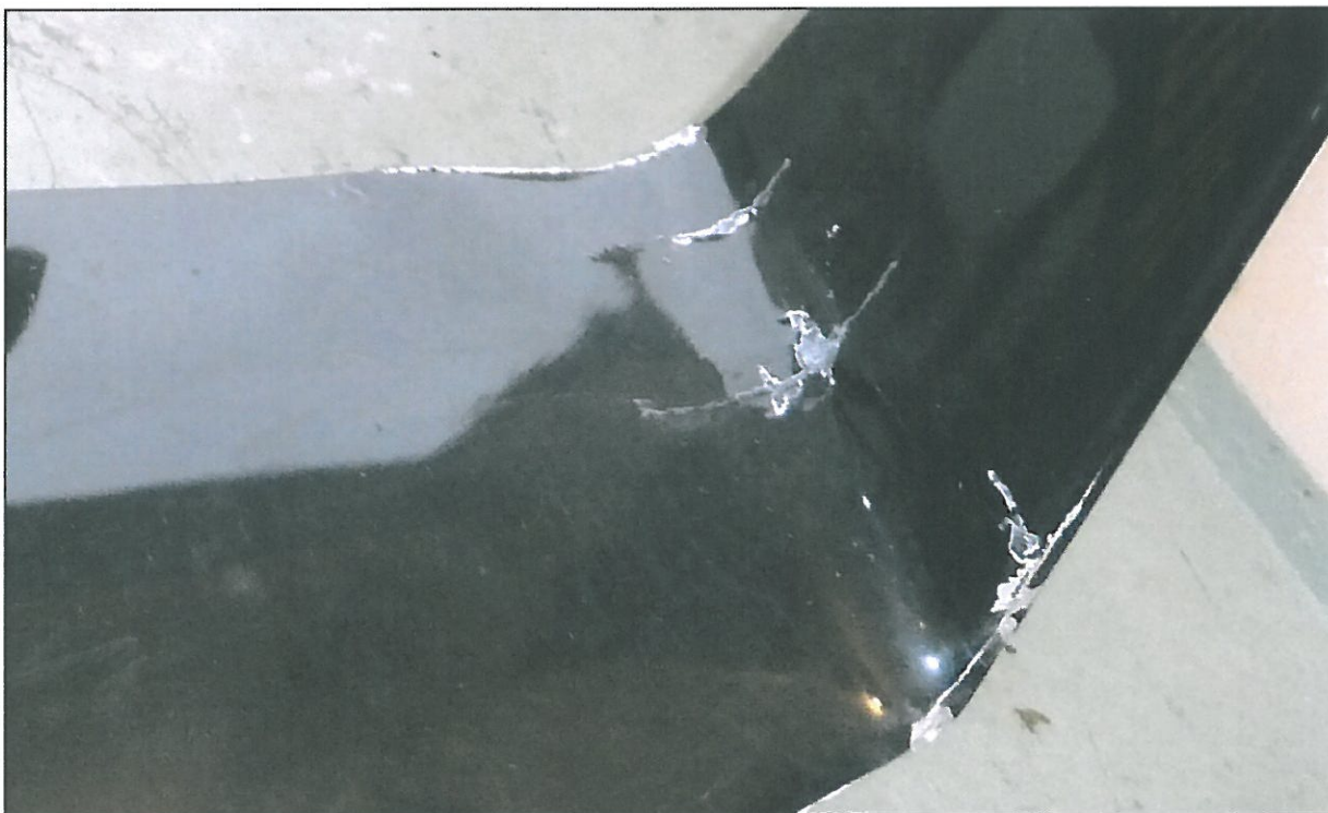
24 – Uszkodzenia usterzenia, powstałe podczas załadunku i transportu z miejsca wypadku.
