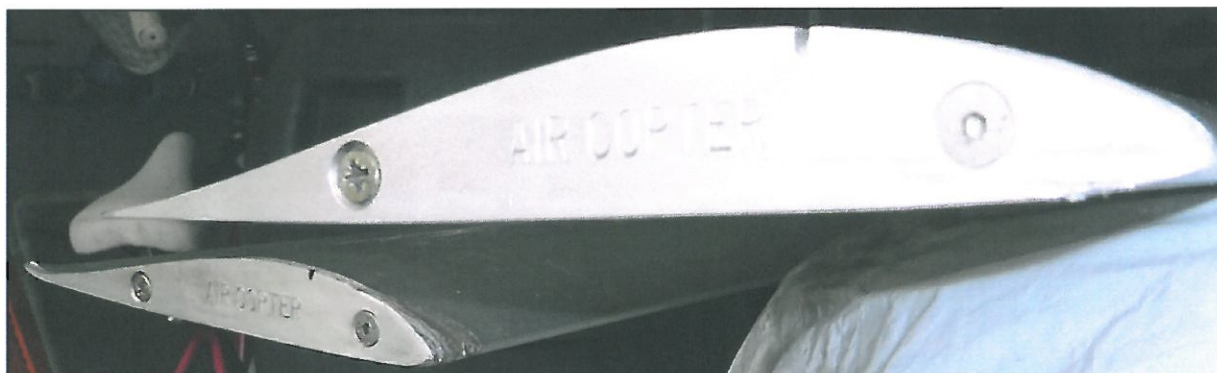
21 – Końcówki obu łopat wirnika, widoczne uszkodzenia.
