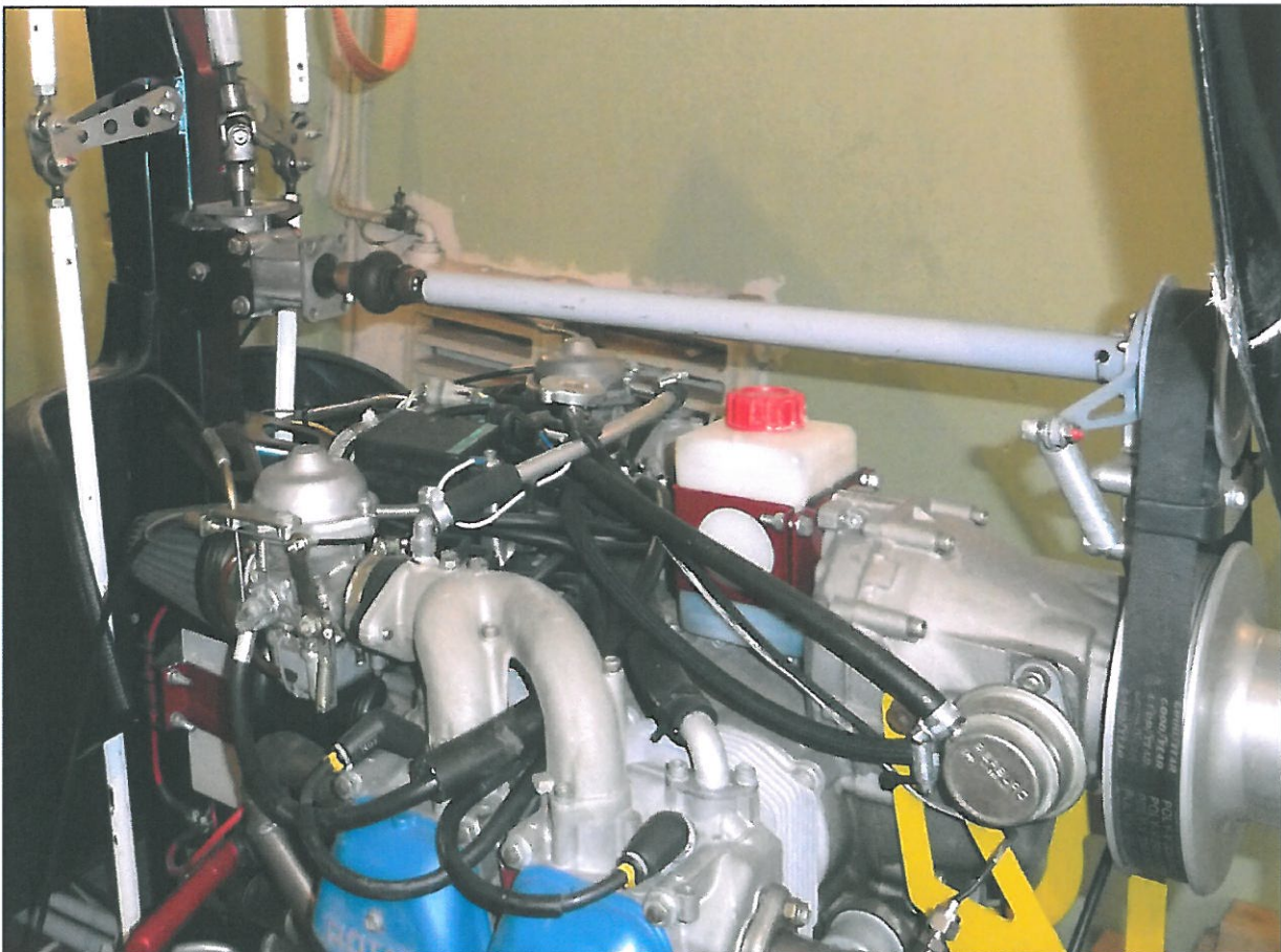
30 – Górna część silnika, lewa strona, widoczna pasowa przekładnia napędu rozkręcania wirnika przed startem (po prawej stronie kadru), przegub Cardana, przekładnia kątowna i tłumik drgań skrętnych na wale wzdłużnym (po lewej stronie kadru).
