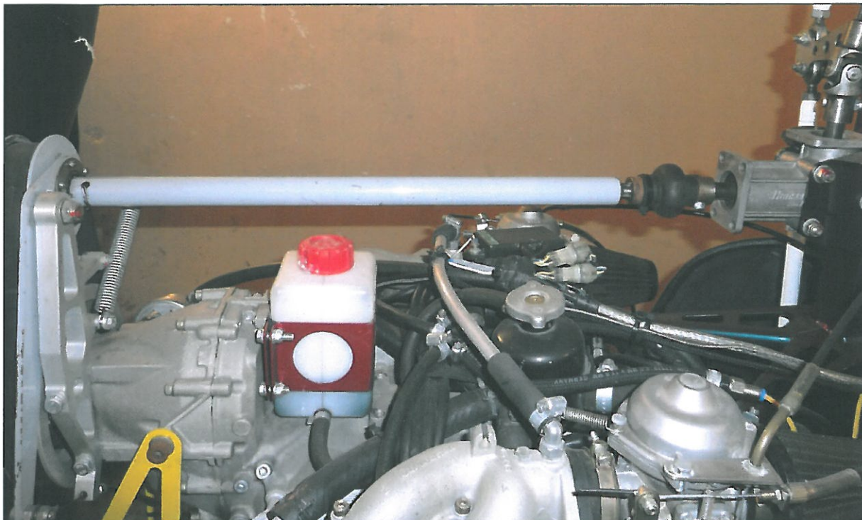
31 – Górna część silnika, prawa strona, po prawej stronie kadru widoczna przekładnia kątowna napędu rozkręcania wirnika przed startem i gumowy tłumik drgań skrętnych na wale wzdłużnym.
