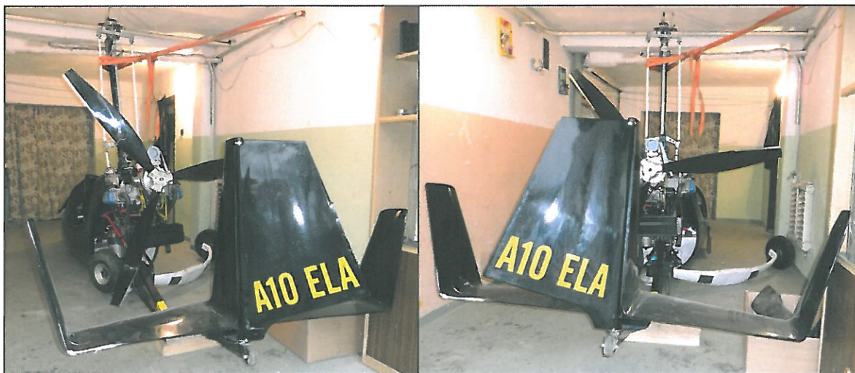
9, 10 – Uszkodzony wiatrakowiec pokazany od tyłu z lewej i prawej strony. Łopaty wirnika i podwozie główne zdemontowane.
