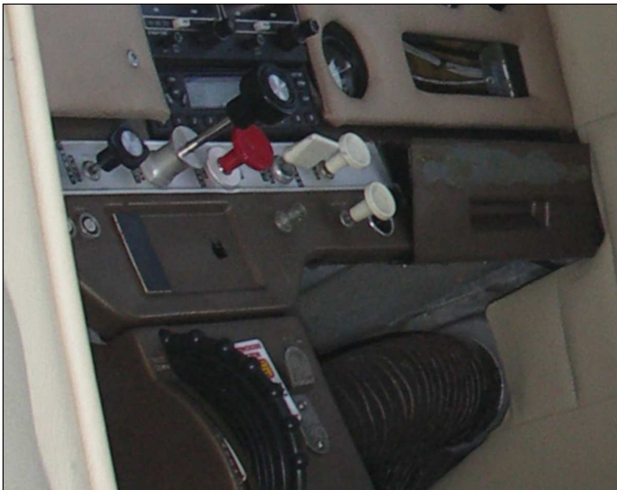
29 – Pulpit poziomy i pulpit centralny z lewej strony – widoczne położenia przepustnicy i przełączników.
