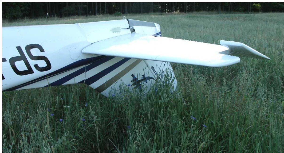
17 – Tylna część kadłuba z usterzeniem – widoczne załamanie struktury.
