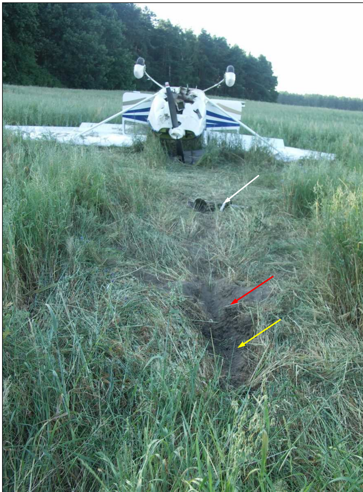
6 – Ostatni odcinek śladu lądowania. Strzałka żółta – początek łamania goleni podwozia przedniego, strzałka czerwona – kontakt osłon silnika i łopaty śmigła z ziemią (bruzda), strzałka białoszara – wyłamana goleń podwozia przedniego.
