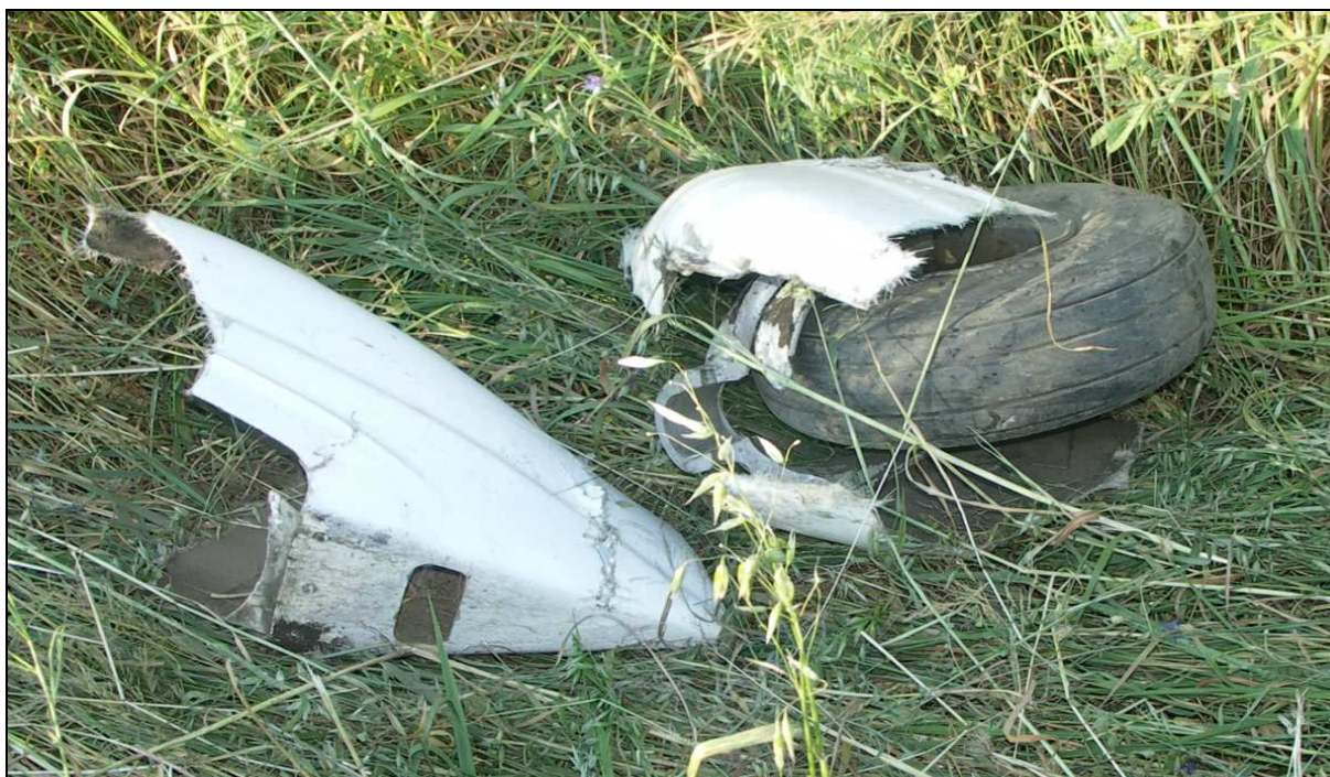
7 – Koło podwozia przedniego wyłamane wraz z fragmentem widelca i zniszczona owiewka koła.
