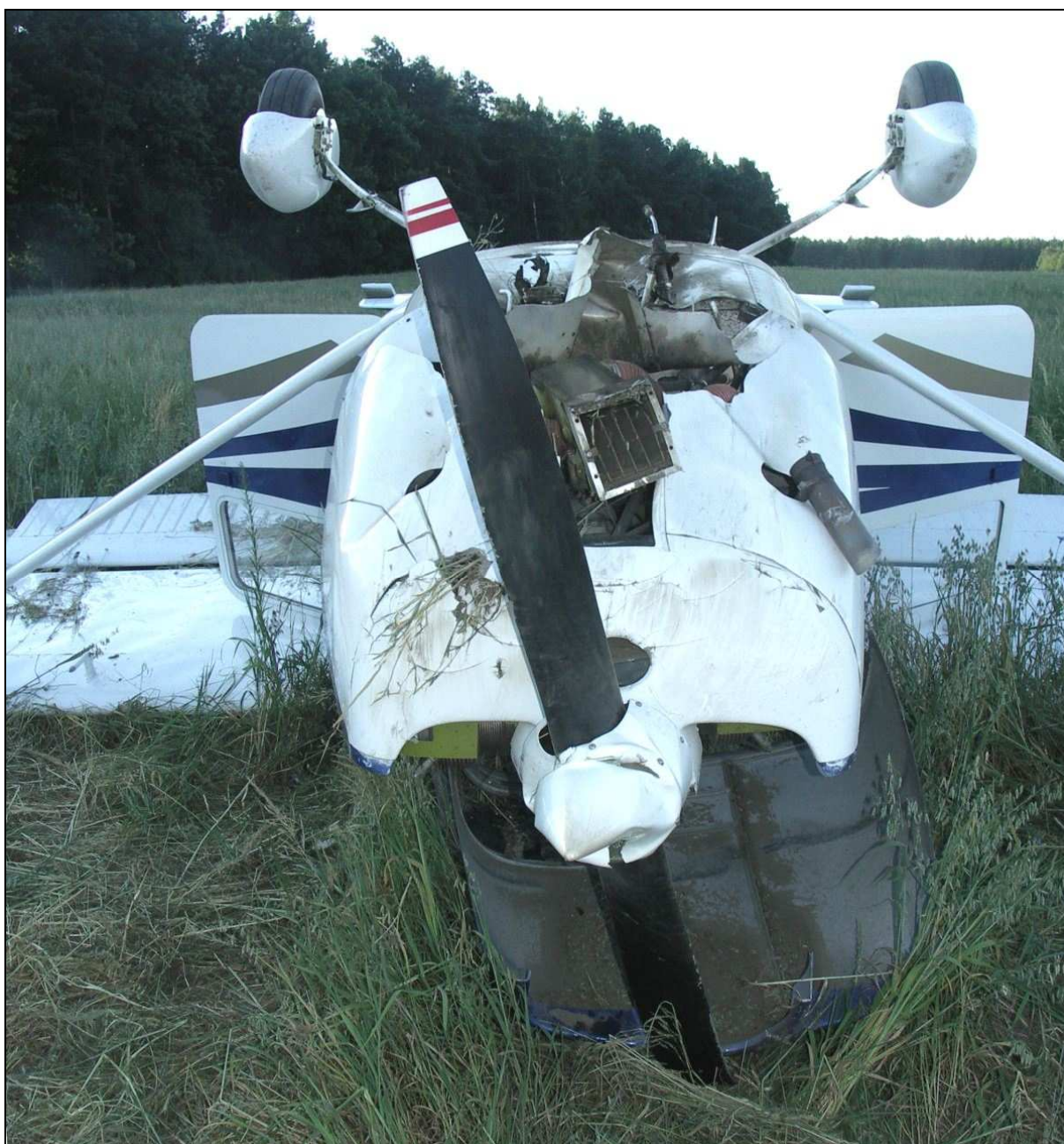
13 – Samolot na miejscu wypadku, widok od przodu. Widoczne uszkodzenia zewnętrznych agregatów silnika.
