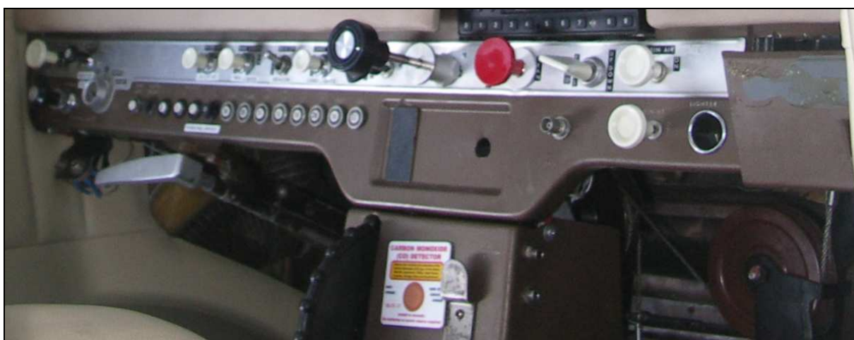
28 – Pulpit poziomy i pulpit centralny z prawej strony – widoczne położenia przepustnicy i przełączników.
