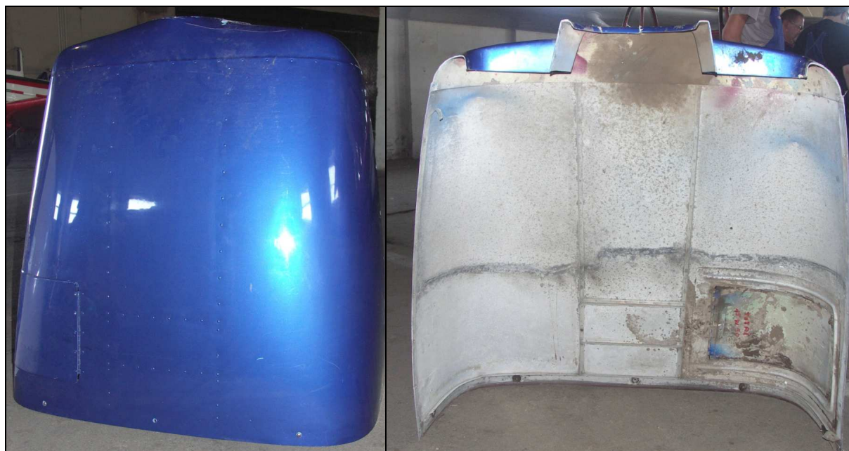
32 i 33 – Lekko uszkodzona górna osłona silnika od strony zewnętrznej (z lewej) i wewnętrznej (z prawej).
