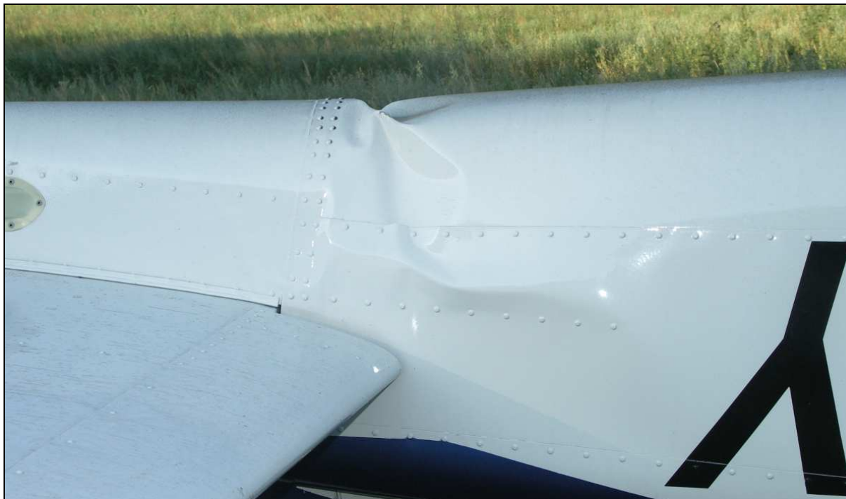
20 – Zbliżenie załamania struktury tylnej części kadłuba.
