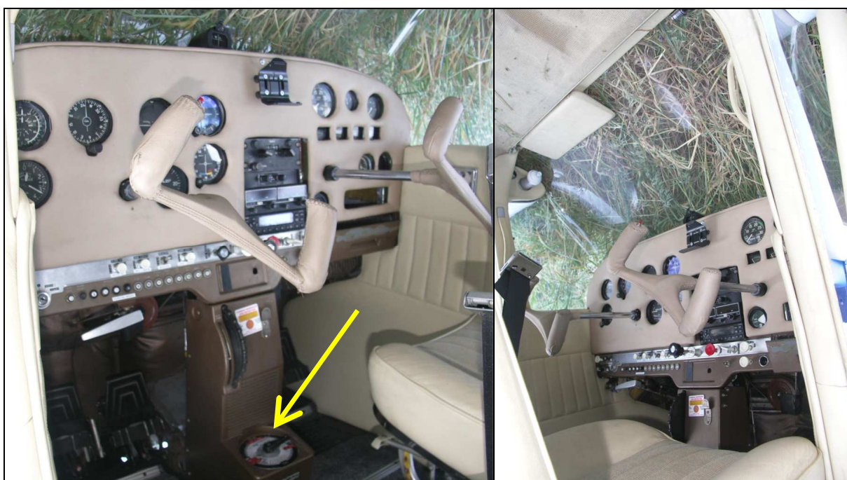
26 i 27 – Widok na tablicę przyrządów i pulpity (obrócony o 180° dla lepszej czytelności). Na fot.26 wskazany strzałką zawór paliwowy ustawiony w pozycji „Lewy zbiornik”.
