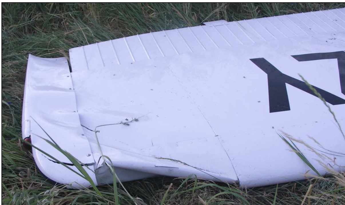
21 – Uszkodzenia końcówki, noska i pokryw lewego skrzydła.
