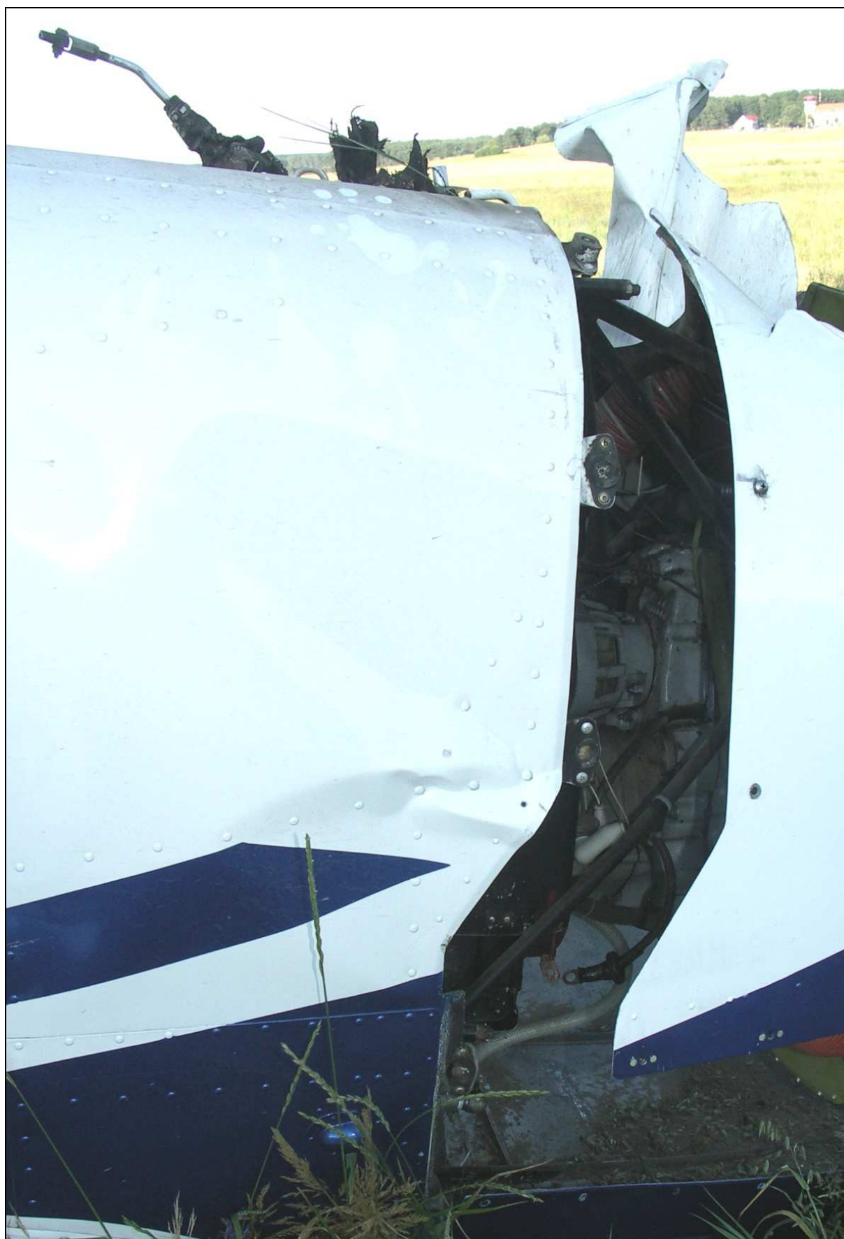
15 – Łoże silnika i jego agregaty, widoczne w luce między kadłubem a dolną pokrywą.
