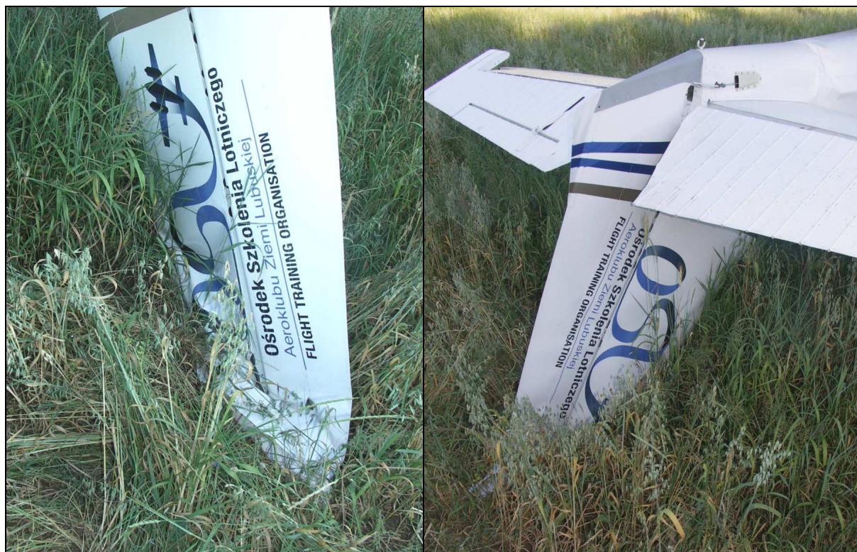
18 i 19 – Zaryte w ziemi usterzenie pionowe z prawej i lewej strony.
