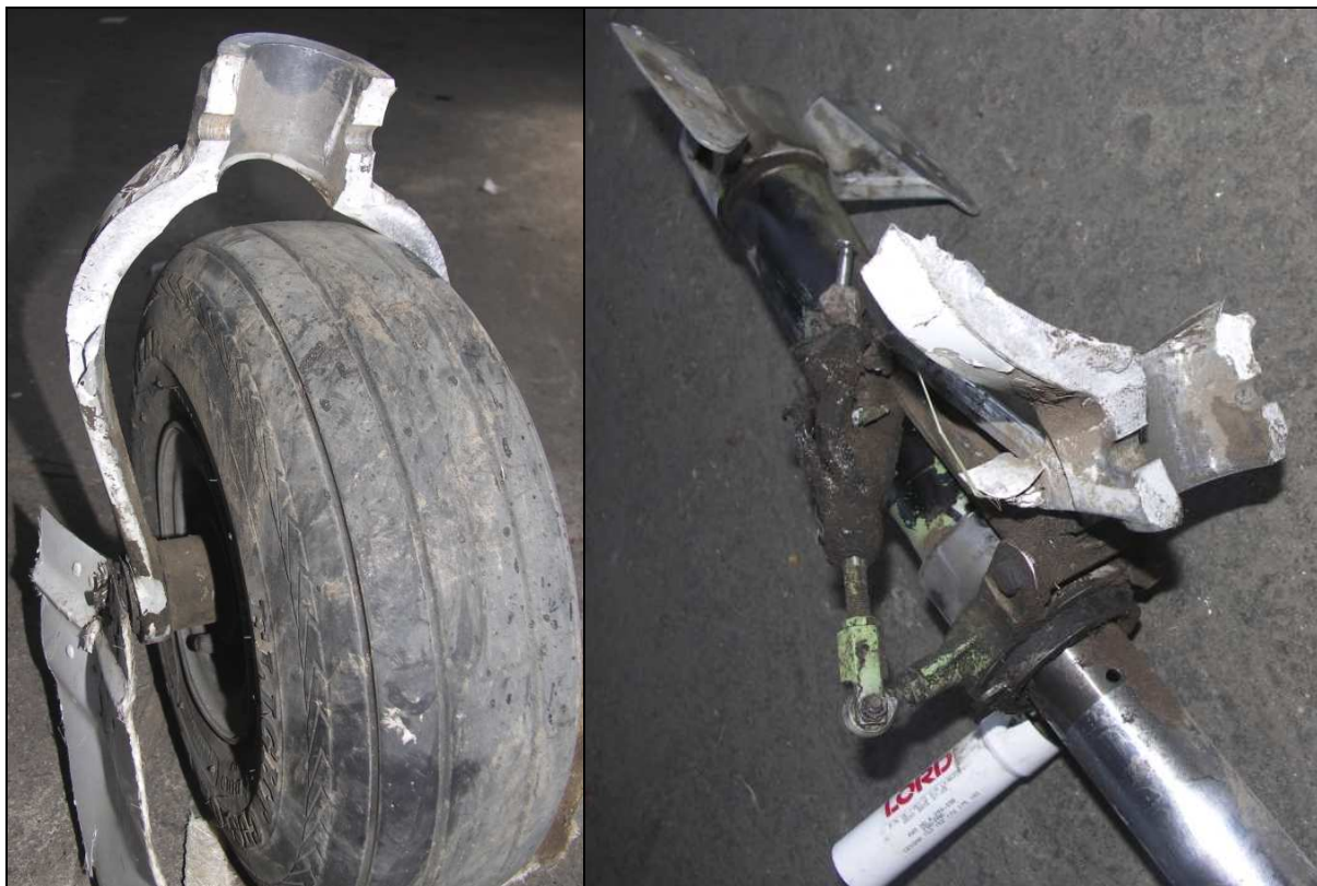
30 i 31 – Zniszczone podwozie przednie. Widoczne przełomy doraźne widelca, bez śladów zmęczenia materiału.
