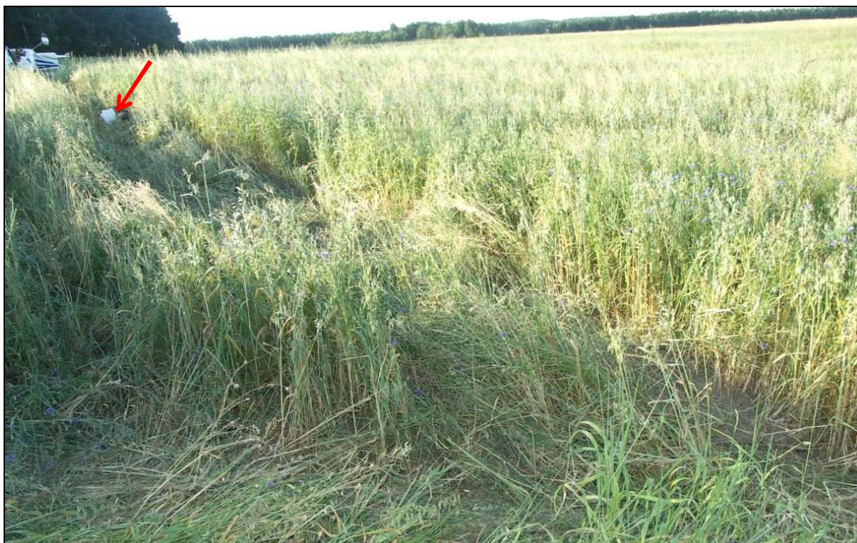
5 – Ślad lądowania samolotu w zbożu na polu obok lotniska. Czerwoną strzałką wskazane oderwane koło przednie.
