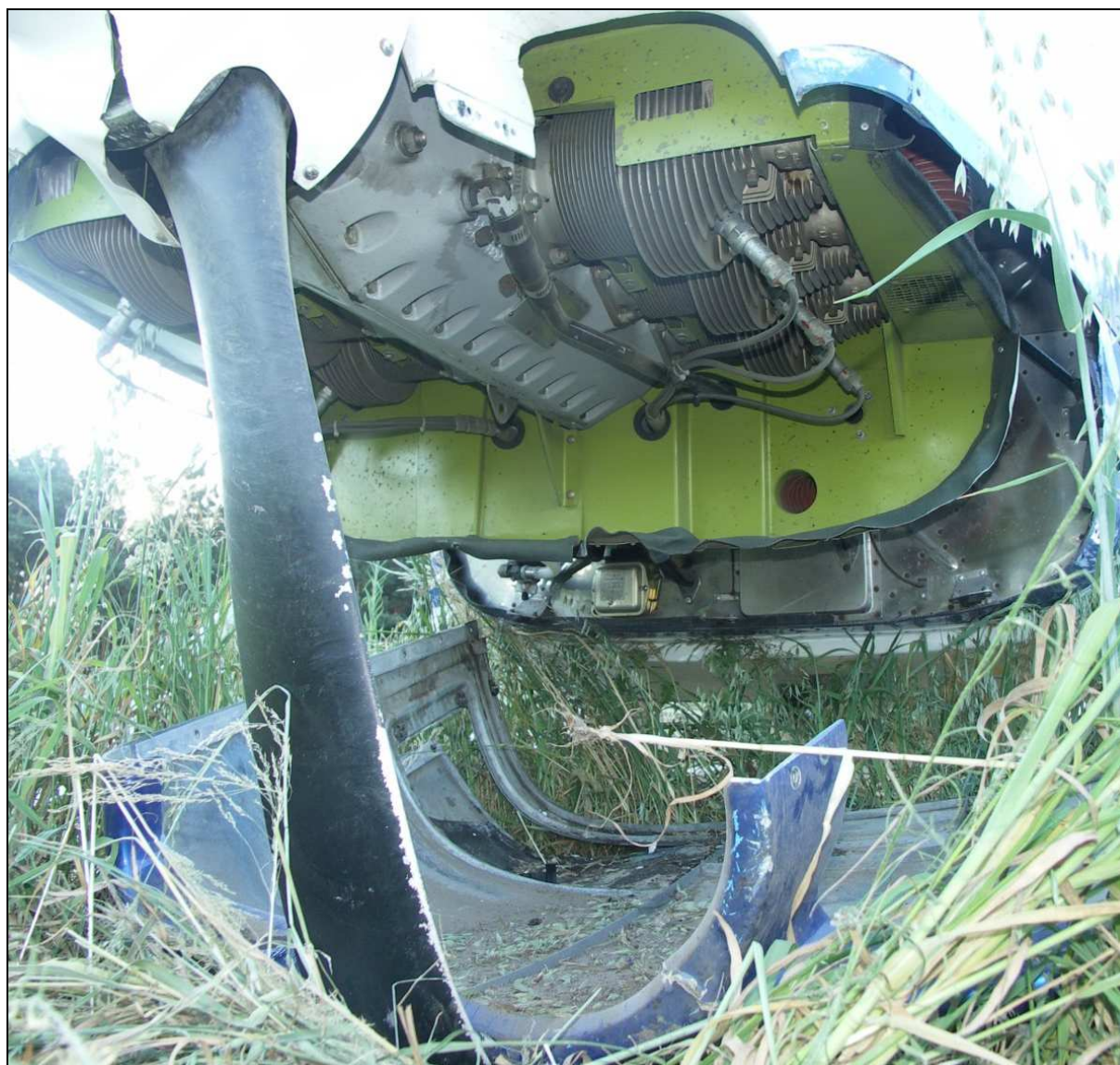
14 – Widok górnej części silnika, po odjęciu górnej pokrywy. Dobrze widoczne zgięcie łopaty śmigła.
