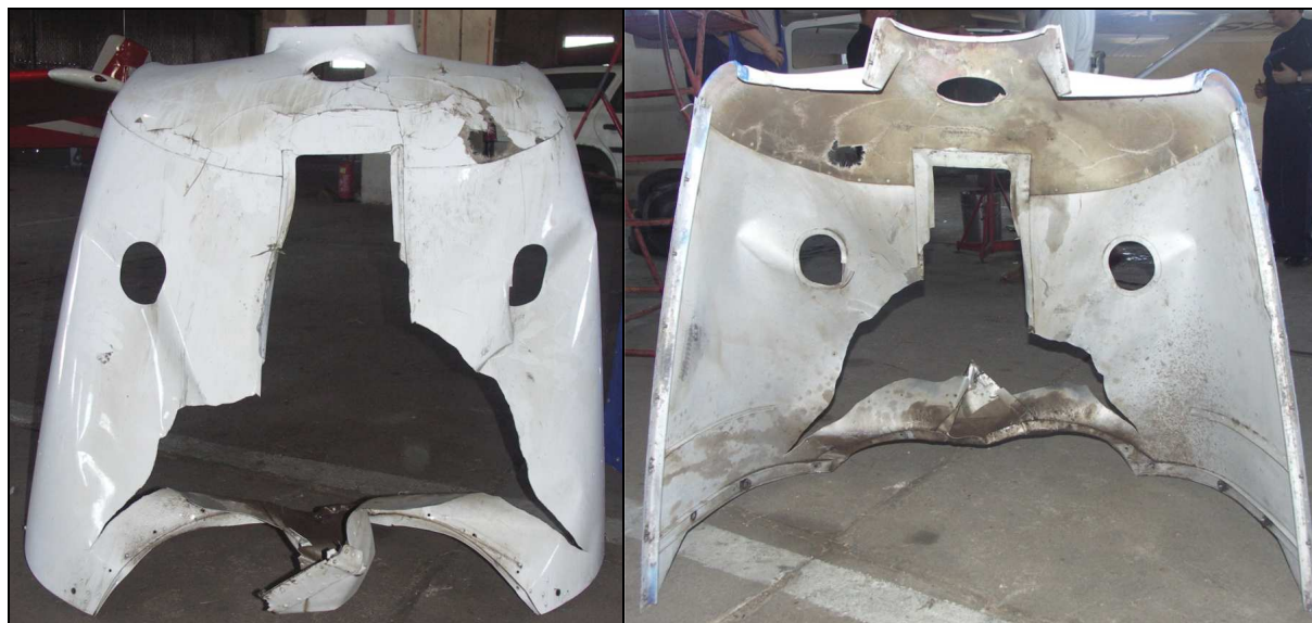
34 i 35 – Zniszczona dolna osłona silnika od strony zewnętrznej (z lewej) i wewnętrznej (z prawej).
