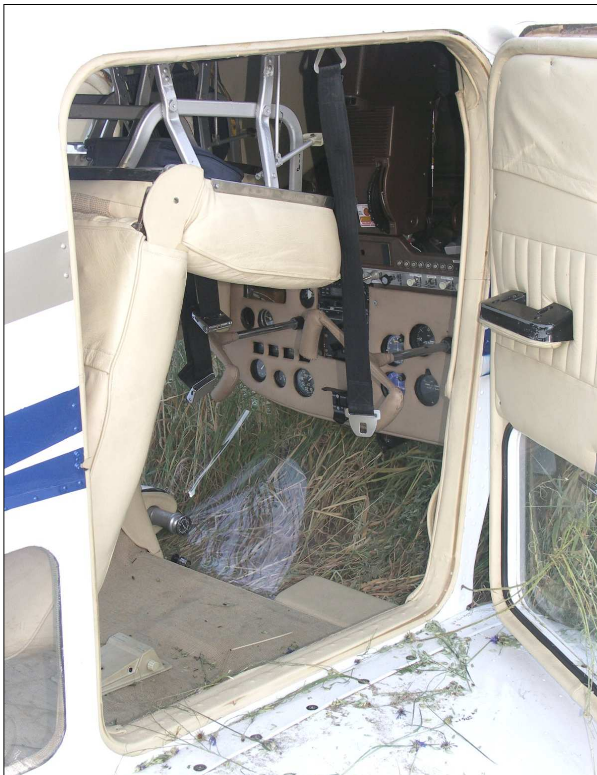
23 – Wnętrze kabiny przewróconego samolotu, lewa strona.
