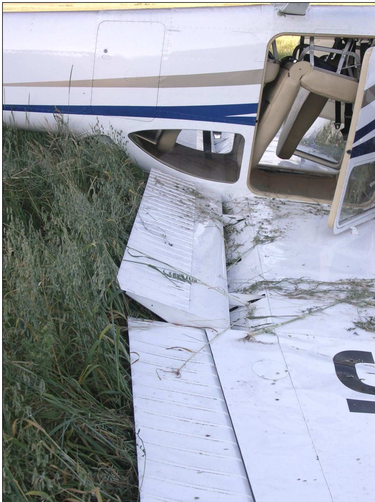
22 – Dolne pokrycia lewego skrzydła, widoczne ich zafalowania w okolicy żebra nasadowego lotki.
