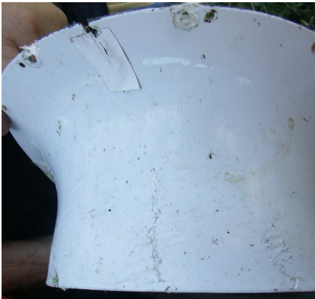
Fot. 3. Owiewka przedniego koła motolotni. Widoczne ukośne otarcia pozostałe po kontakcie z przewodem linii elektrycznej.
