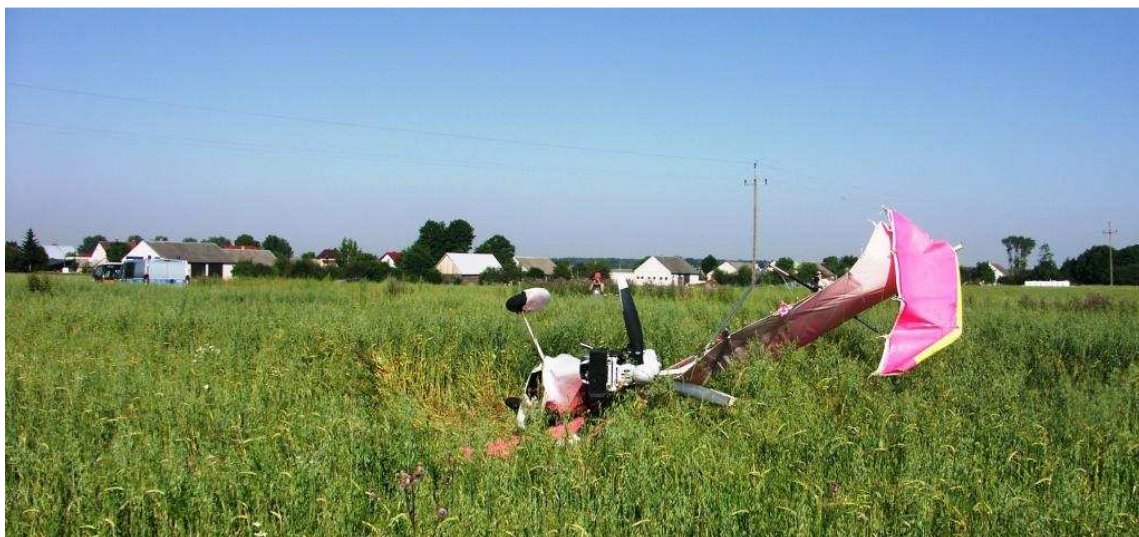
Fot. 1. Widok miejsca wypadku. W głębi zdjęcia widoczna linia elektryczna, z którą zderzyła się motolotnia.
