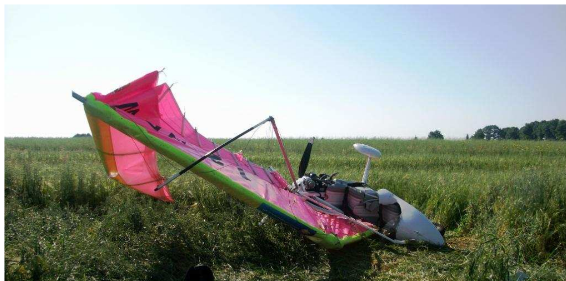
Fot. 2. Wrak motolotni SP-MWAC. Lewy dolny, boczny węzeł sterowniczy został rozłączony podczas akcji ratowniczej.
