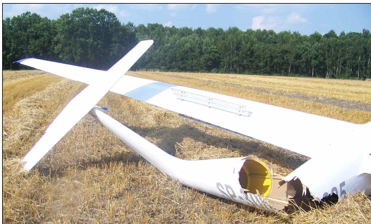
10 – Szybowiec po wypadku – widok ogólny. Widoczny przełom kadłuba.
