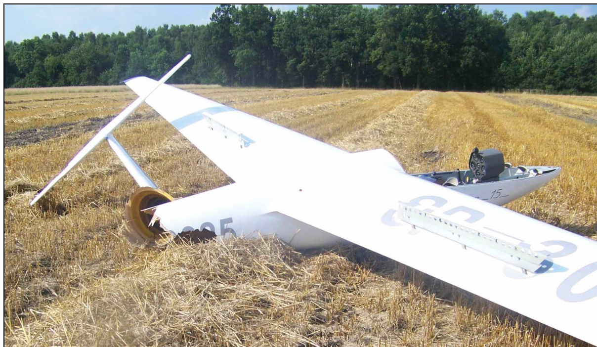
9 – Szybowiec po wypadku – widok ogólny. Widoczny przełom kadłuba.
