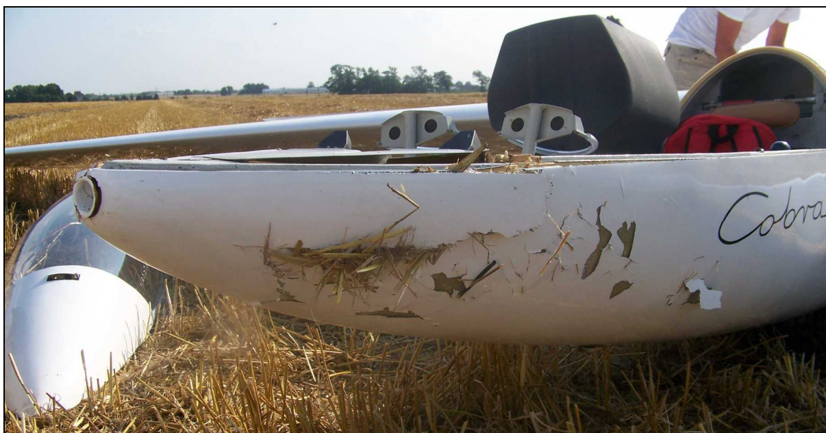
13 – kabinowa część kadłuba, lewa strona. Widoczne uszkodzenia pokrycia.
