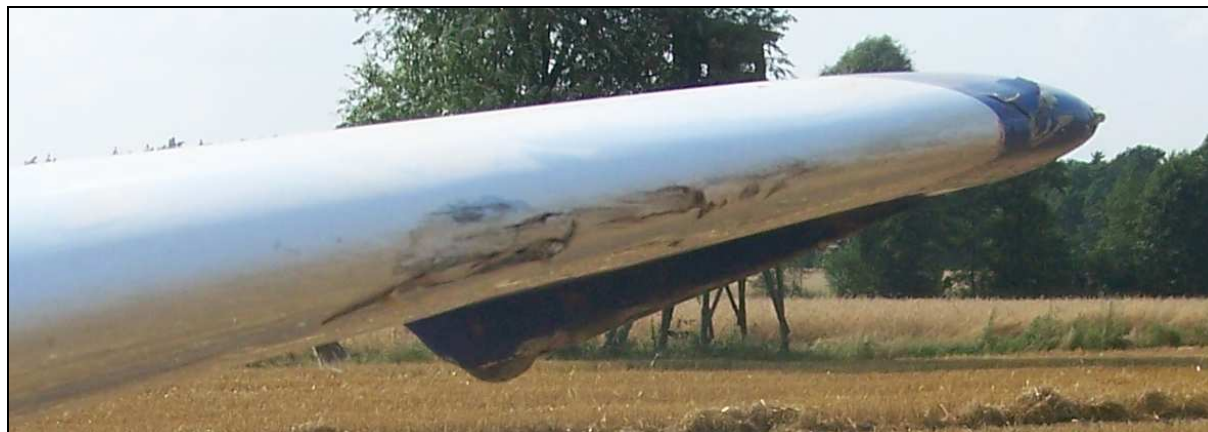
17 – Uszkodzenia noska lewego skrzydła przy końcówce.
