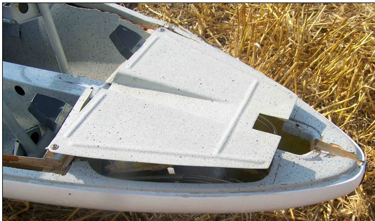
14 – Kabinowa część kadłuba w okolicy sterownic nożnych – widoczne uszkodzenia.
