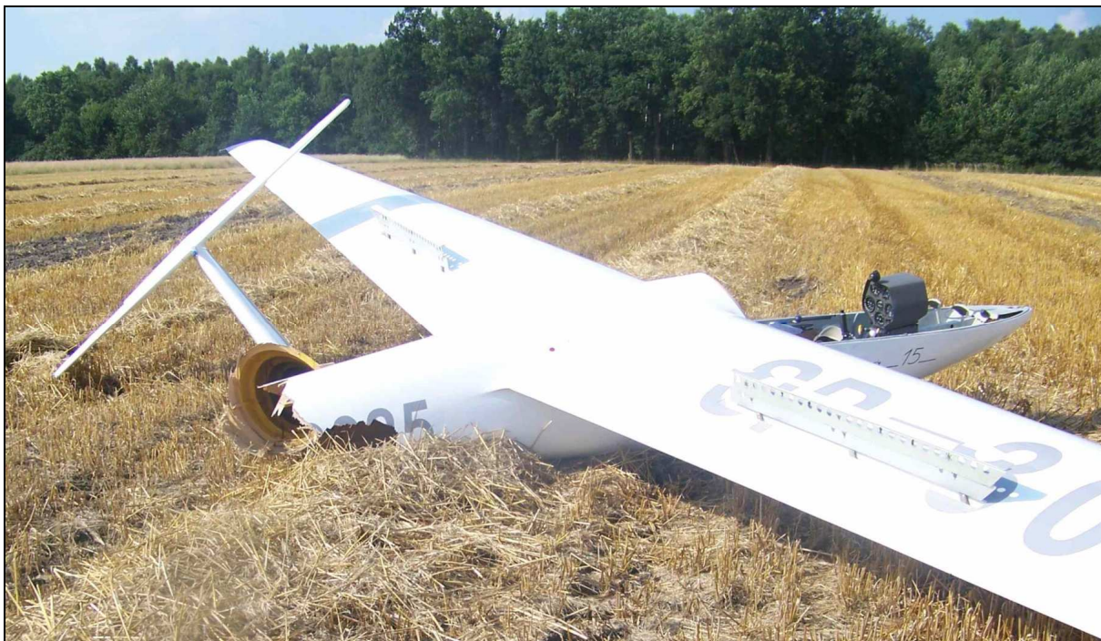
Szybowiec po wypadku – widok ogólny. Widoczny przełom kadłuba.
