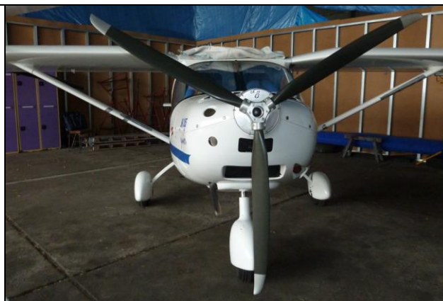
3 – Ogólny widok uszkodzonego samolotu z przodu, zwraca uwagę brak kołpaka śmigła [zdjęcie: PKBWL].
