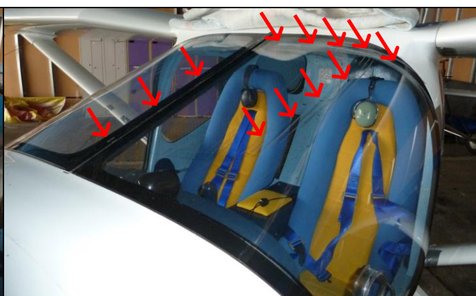
6, 7 – Uszkodzenia wiatrochronu – zbliżenia z prawej i lewej strony [zdjęcia: PKBWL].
