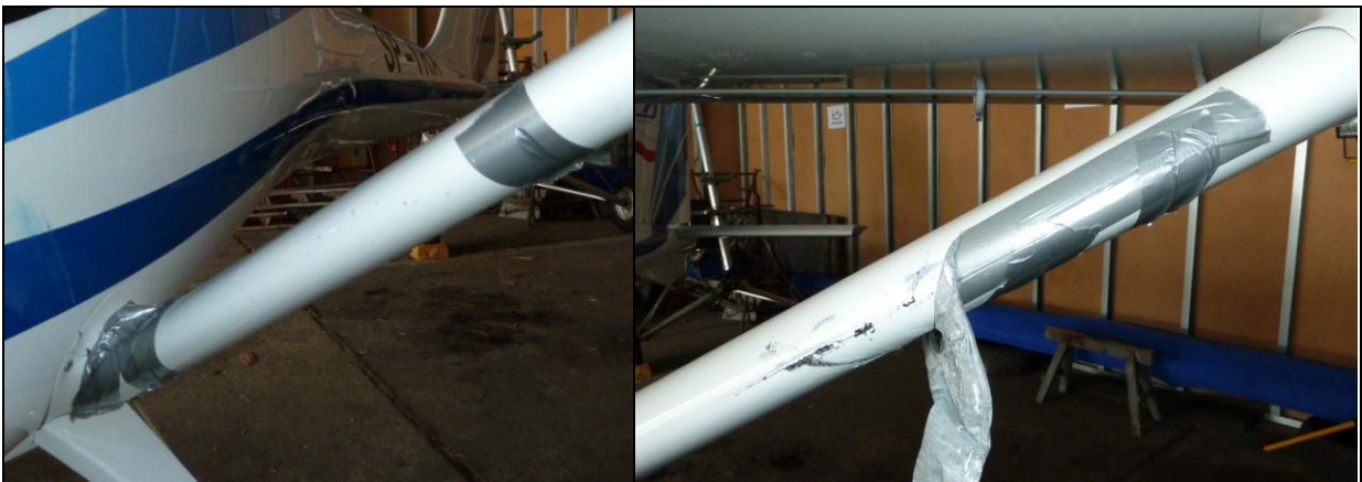
10, 11 – Uszkodzenia lewego zastrzału – zbliżenia stref uszkodzeń [zdjęcia: PKBWL].
