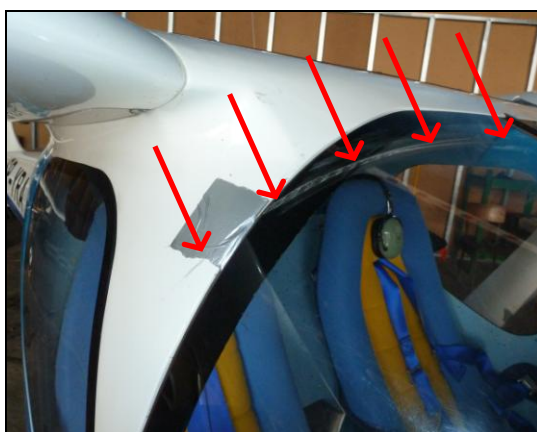
6, 7 – Uszkodzenia wiatrochronu – zbliżenia z prawej i lewej strony [zdjęcia: PKBWL].
