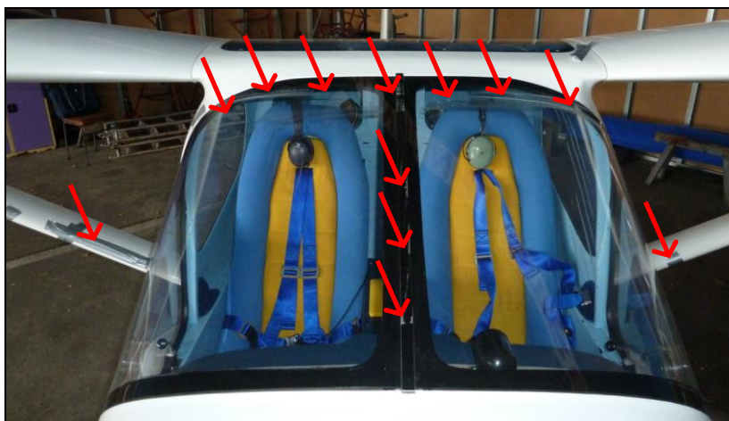
4 – Uszkodzenia wiatrochronu i zastrzałów – widok ogólny [zdjęcie: PKBWL].
