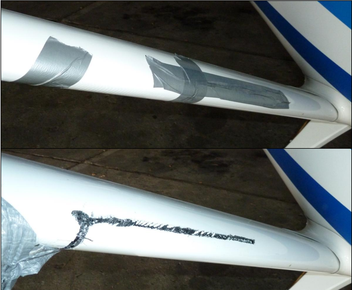
8, 9 – Uszkodzenia prawego zastrzału – zbliżenia stref uszkodzeń [zdjęcia: PKBWL].
