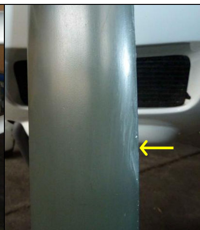
5 – Uszkodzenie łopaty śmigła [zdjęcie: PKBWL].
