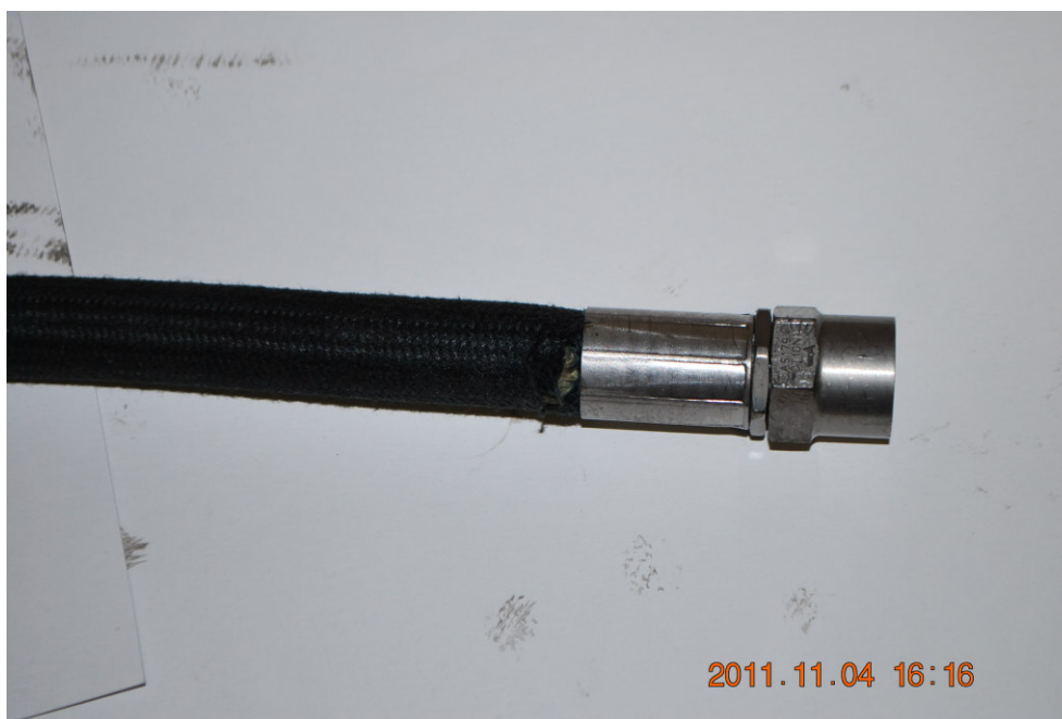
Fot. 14 Uszkodzenie przewodu hydraulicznego wypuszczania podwozia samolotu SP-LPC.
