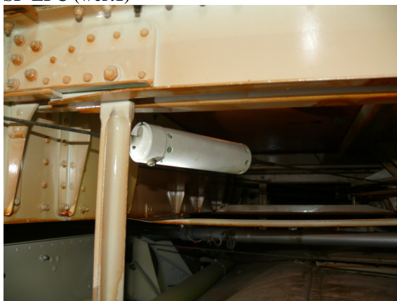
Fot. 17 Ogranicznik przeciążeniowy alternatywnego systemu wypuszczania prawego podwozia głównego.
