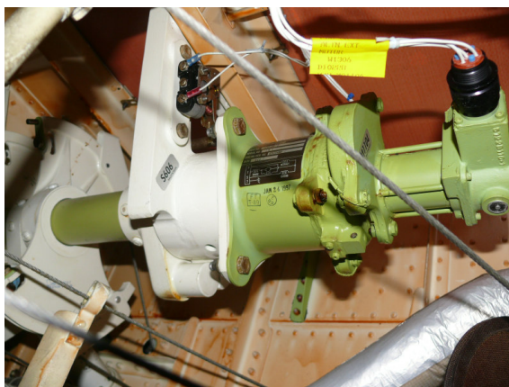
Fot. 18 Silnik elektryczny alternatywnego systemu wypuszczania podwozia.
