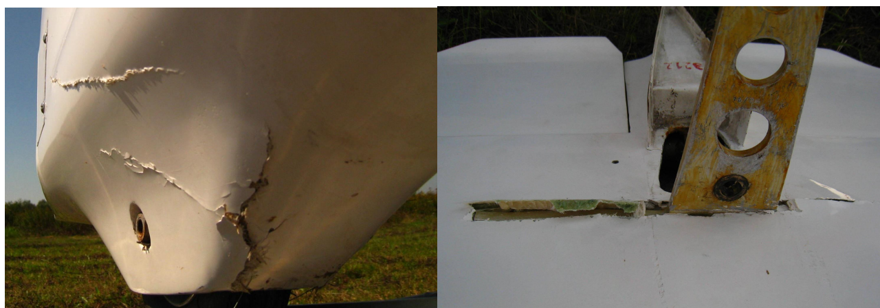
Fot. 2 Uszkodzenia belki ogonowej oraz statecznika poziomego
