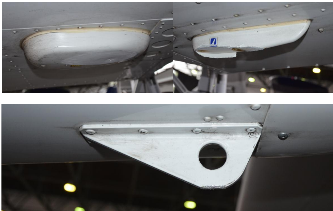
Fot. 1 Zdjęcia uszkodzeń elementów na spodniej części kadłuba (fot. przekazane przez zgłaszającego zdarzenie)
