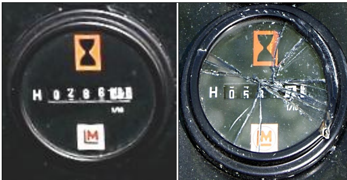
53 [K.Bodzak], 54 [PKBWL] – Dwa zdjęcia licznika motogodzin silnika, wykonane w różnych okresach. Po lewej zdjęcie wykonane 09 marca 2007 r. ze wskazaniem 0286.31, po prawej zdjęcie wykonane 30 kwietnia 2012 r. (w dzień po wypadku) ze wskazaniem 0535.71. Oznacza to, że w okresie od 09 marca 2007 r. do 29 kwietnia 2012 r. silnik samolotu przepracował 249.40 godzin. Można przyjąć, że odpowiada to ok.225 godzinom lotu.
