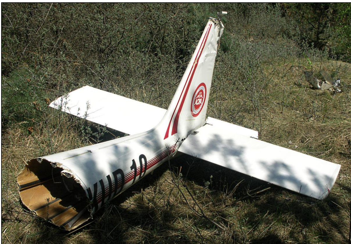
21 – Odcięta tylna część kadłuba z usterzeniem – widok ogólny.
