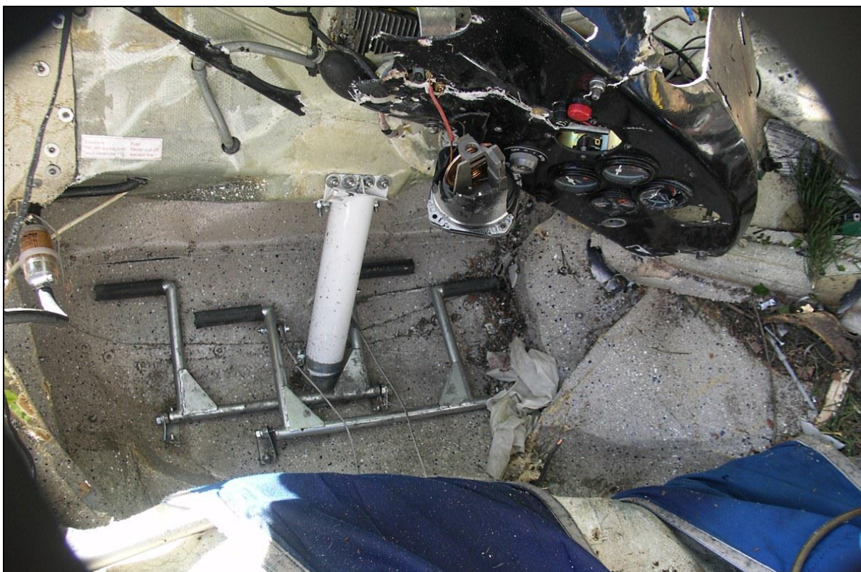
16 – Widok na wnętrze i podłogę kabiny. Widoczne sterownice nożne i rura goleni podwozia przedniego.
