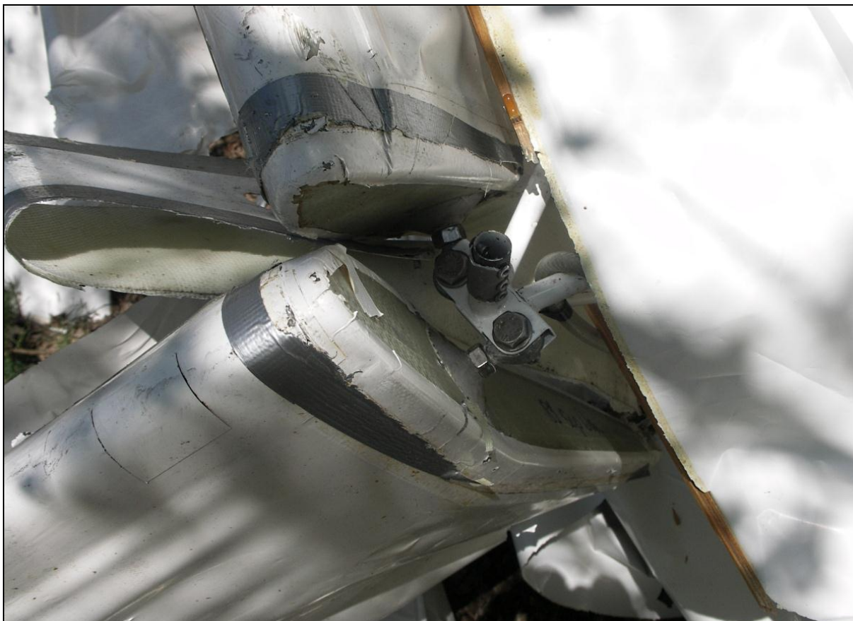
10 – Zbliżenie na węzeł połączenia prawego dolnego skrzydła z kadłubem. Zwraca uwagę zastosowanie taśmy samoprzylepnej do „ulepszenia” stanu pokrycia.
