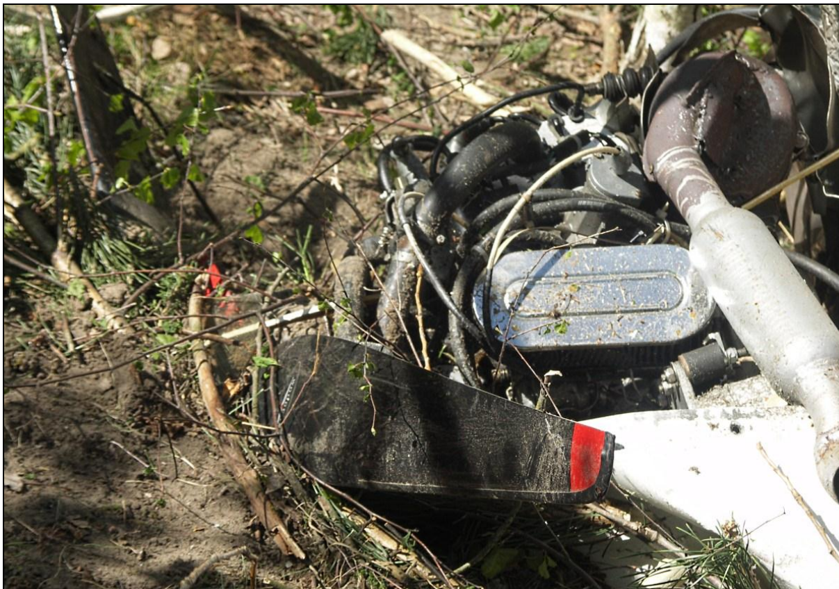
30 – Przednia część silnika z piastą śmigła częściowo zarytą płytko w ziemi.
