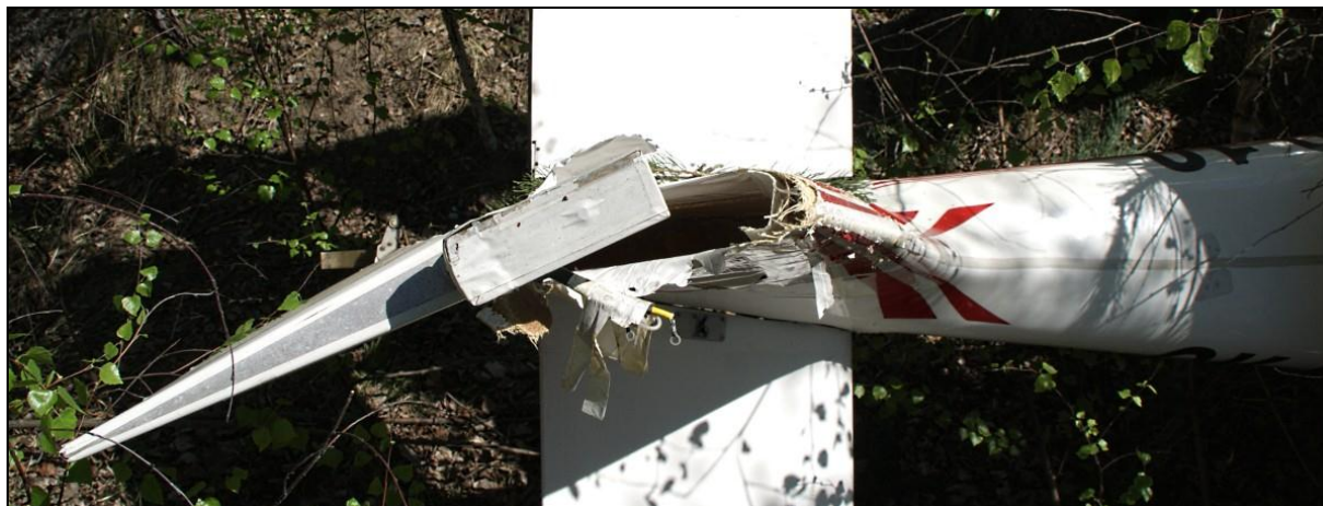
26 – Końcówka usterzenia pionowego z widocznym śladem uderzenia statecznikiem o pień drzewa, widok z góry [foto: KPP Radomsko].
