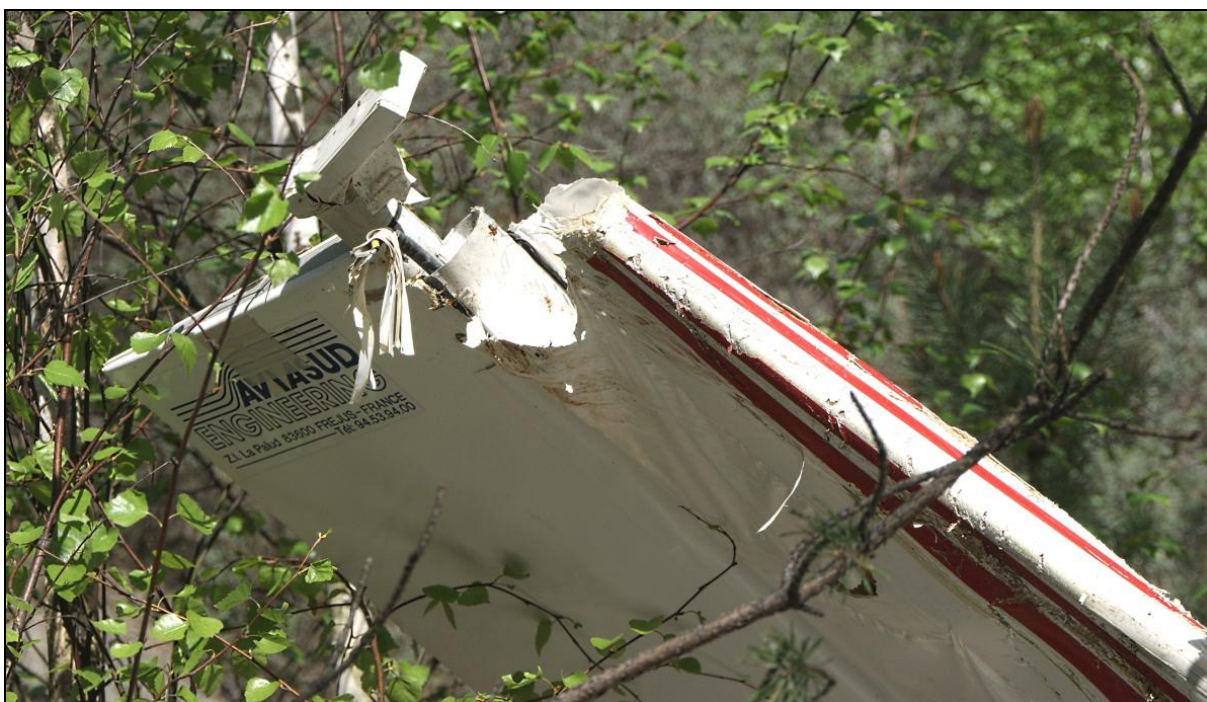
24 – Końcówka usterzenia pionowego z widocznym śladem uderzenia statecznikiem o pień drzewa, prawa strona.
