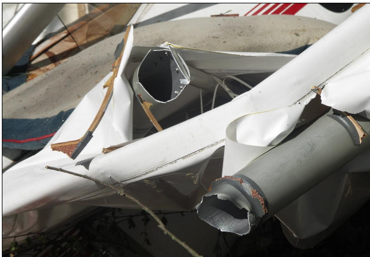
9 – Zbliżenie na jeden z przełomów dźwigara górnego skrzydła.
