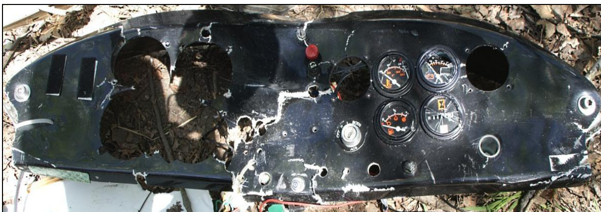
45 – Zniszczona tablica przyrządów, widok od strony kabiny. Zwraca uwagę uszkodzenie (z wyłamaniem przyrządów pilotażowych) charakterystyczne dla silnego uderzenia głową [foto: KPP Radomsko].
