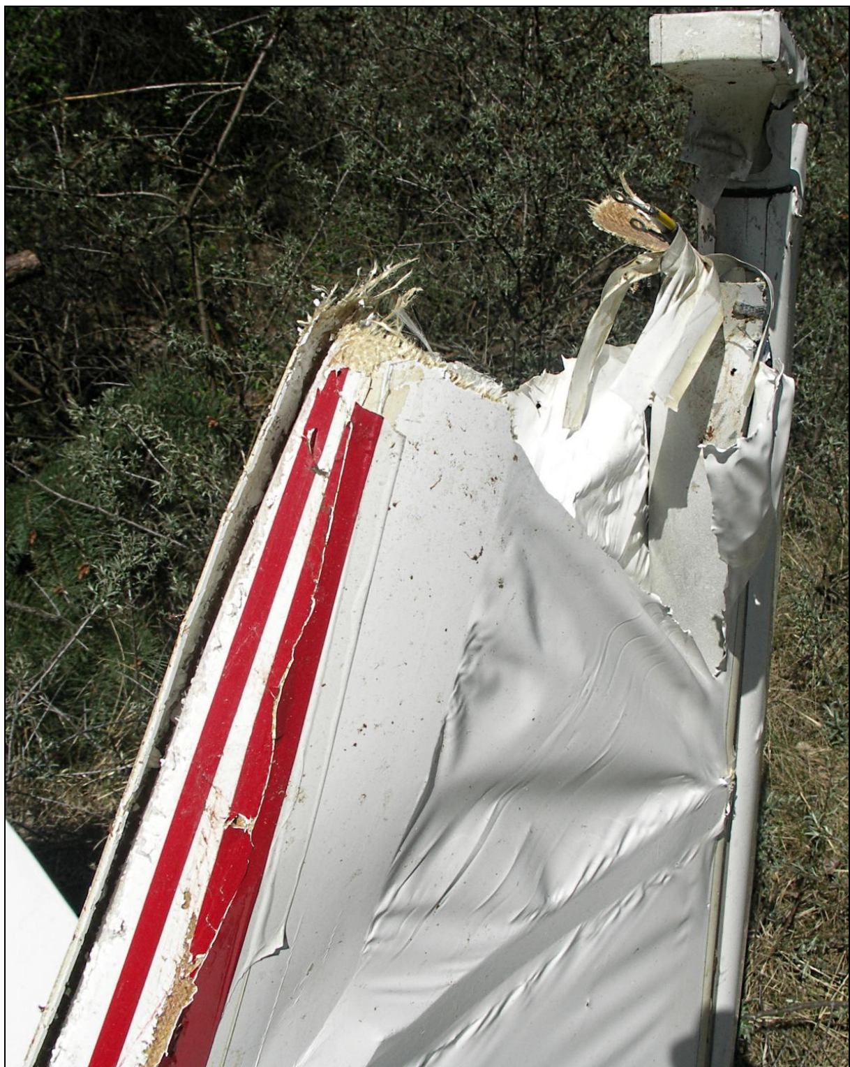
25 – Końcówka usterzenia pionowego z widocznym śladem uderzenia statecznikiem o pień drzewa, lewa strona [foto: KPP Radomsko].
