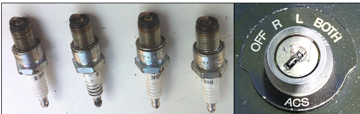
38 [PKBWL], 39 [KPP Radomsko] – Świece zapłonowe po wykręceniu i zbliżenie na stacyjkę zapłonową z odłamanym kluczykiem. Zwraca uwagę dobry stan świec zapłonowych i położenie stacyjki BOTH (=oba).
