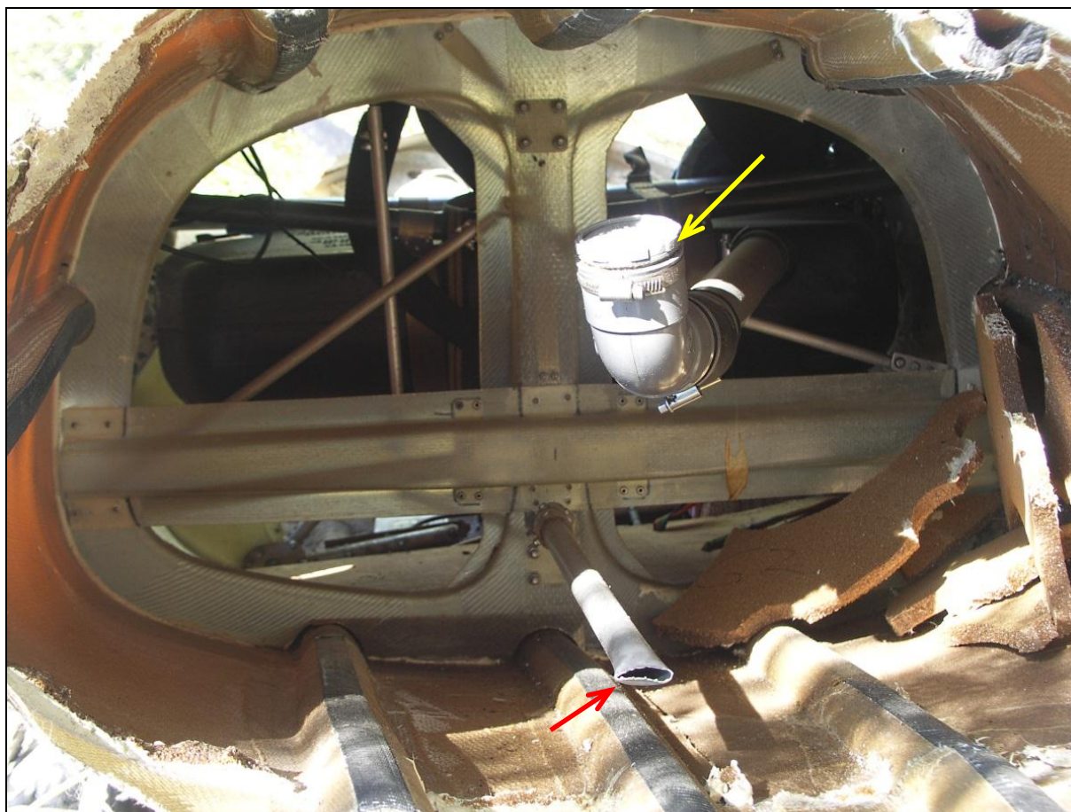
19 – Wręga kadłuba za zbiornikiem paliwa, widoczna po odcięciu części tylnej z usterzeniem. Żółtą strzałką zaznaczony wlew paliwa, czerwoną – odcięty popychacz sterowania płytą usterzenia poziomego.
