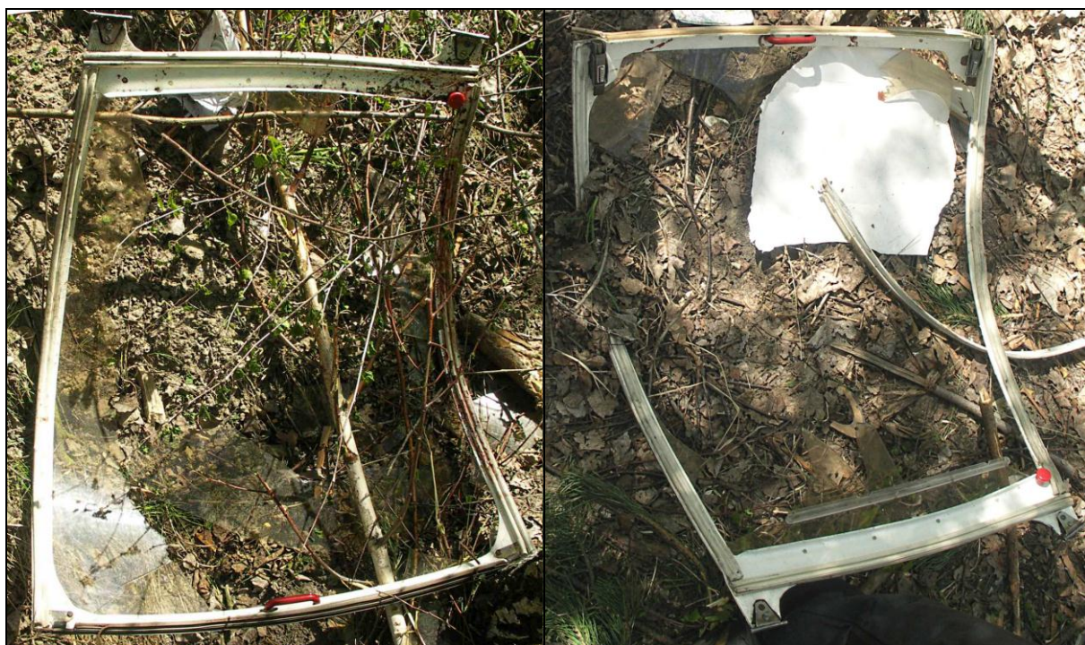
27, 28 – Ramy lewych i prawych drzwi kabiny ze zniszczonym oszkleniem.
