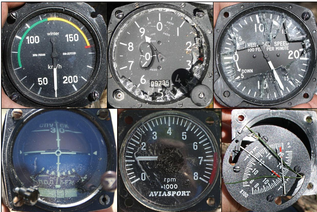
46, 47, 48, 49, 50, 51 – Przyrządy wyrwane z tablicy – kolejno od lewej do prawej: prędkościomierz, wysokościomierz, wariometr, sztuczny horyzont, obrotomierz i wskaźnik EGT [foto: KPP Radomsko].
