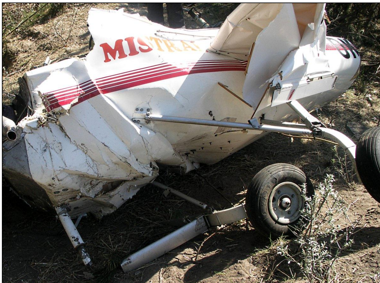
17 – Kadłub po wydobyciu z miejsca wypadku, część tylna z usterzeniem odcięta, prawe podwozie główne wyłamane. Dobrze widoczny charakter uszkodzeń części przedniej, powstałych w wyniku zderzenia z ziemią.
