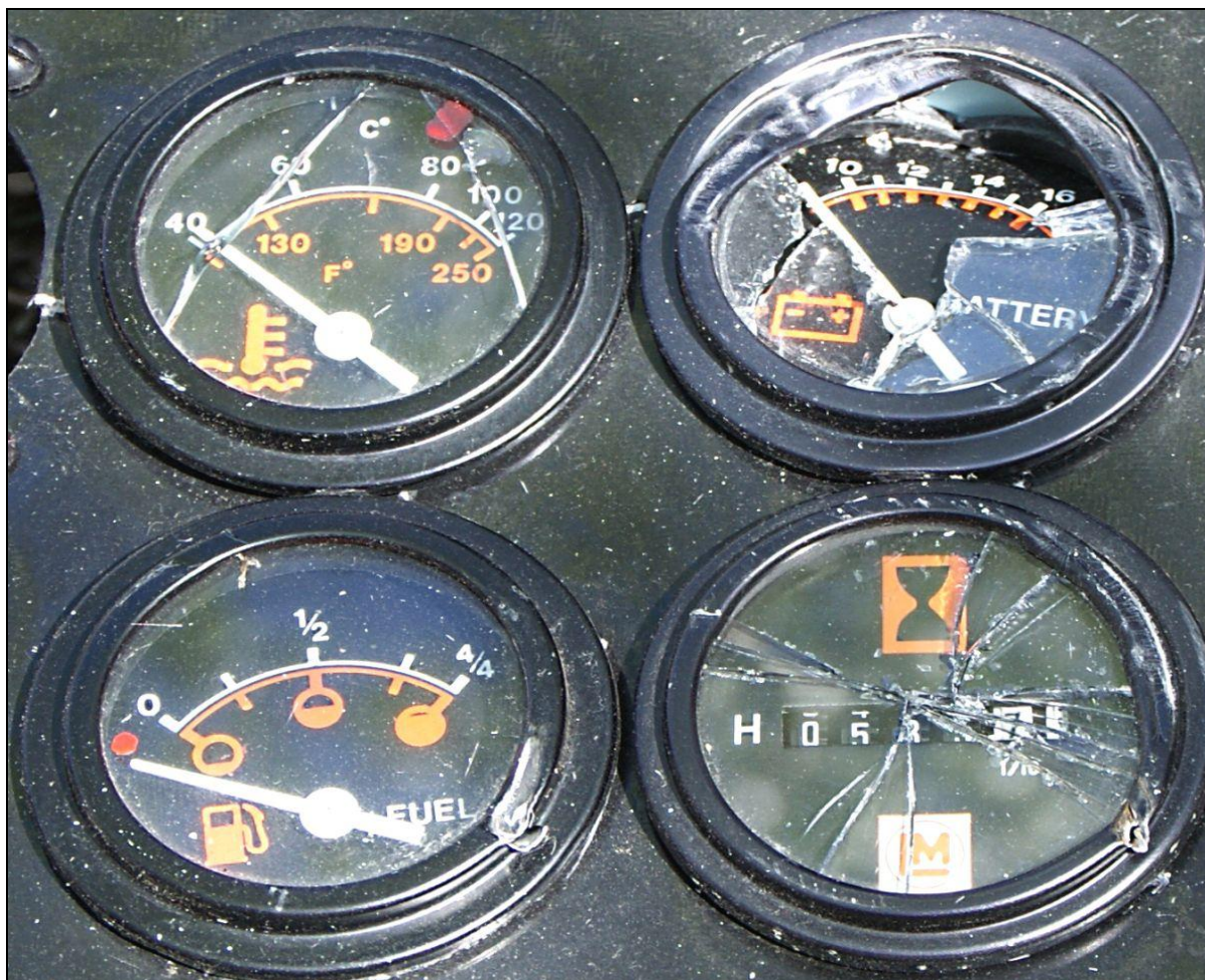
52 – Przyrządy kontroli silnika, pozostałe w tablicy – kolejno od lewej do prawej: wskaźnik temperatury oleju, wskaźnik instalacji elektrycznej, wskaźnik paliwomierza i licznik motogodzin pracy silnika [foto: KPP Radomsko].
