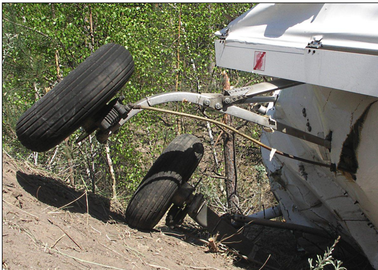
18 – Widok od tyłu na podwozie główne i spód skorupy kadłuba w rejonie kabiny.
