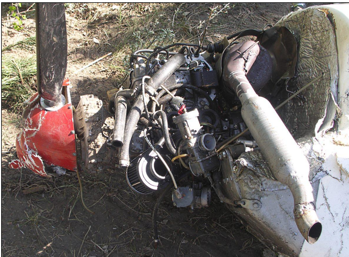
34 – Silnik, lewa strona. Widoczny oderwany jeden z gaźników. Zwraca uwagę sposób zniszczenia kołpaka śmigła, charakterystyczny dla kontaktu z podłożem pod dużym kątem.
