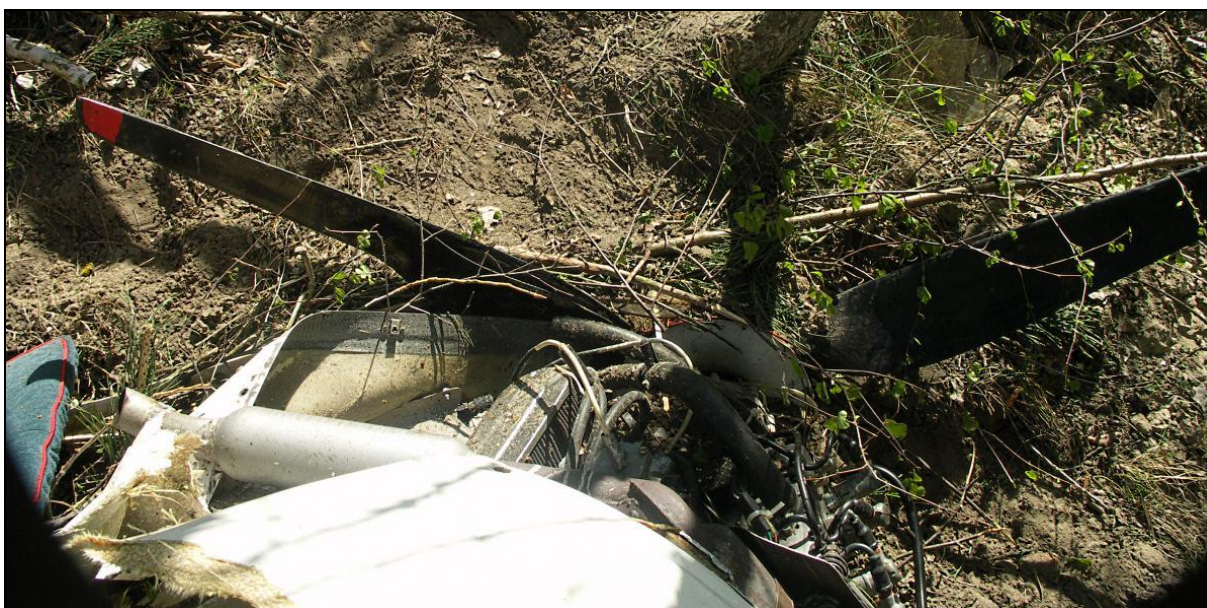
31 – Widok na silnik z góry od tyłu. Zwraca uwagę brak uszkodzeń łopat, charakterystycznych dla uderzenia o ziemię podczas pracy silnika.
