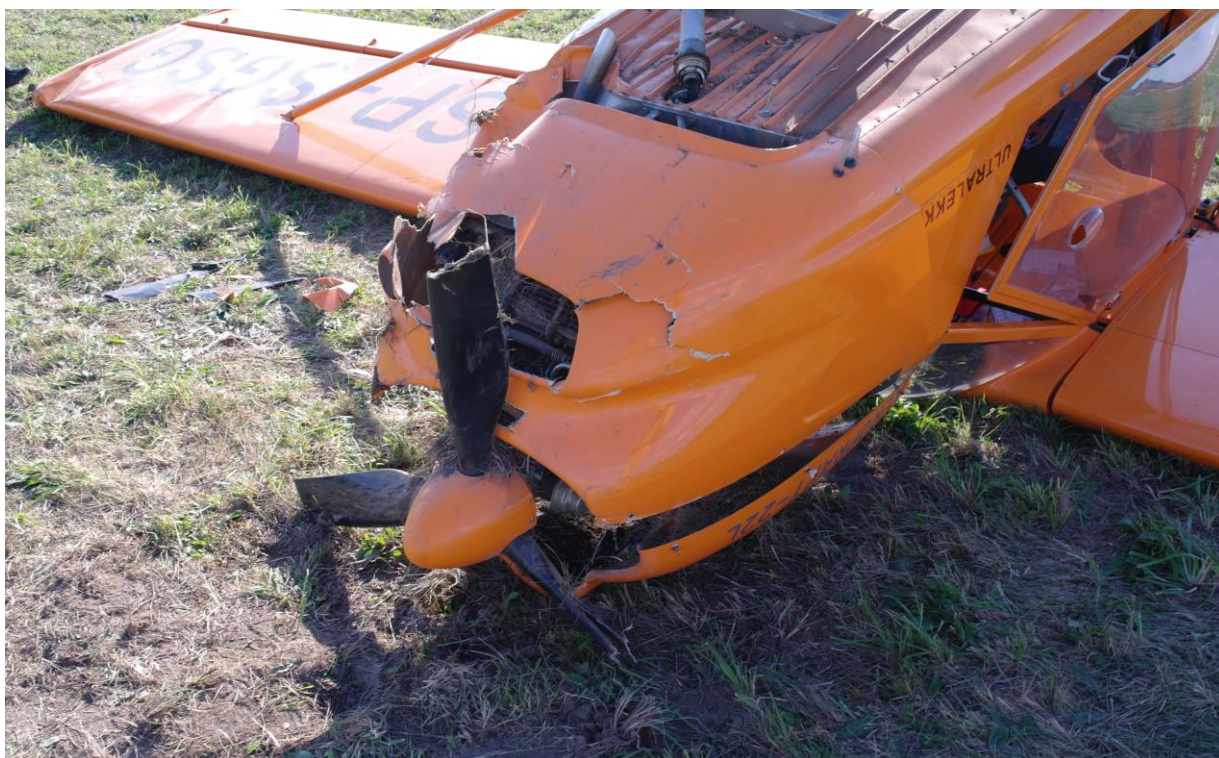
Rys. 1. Czołowa część samolotu po kapotażu
