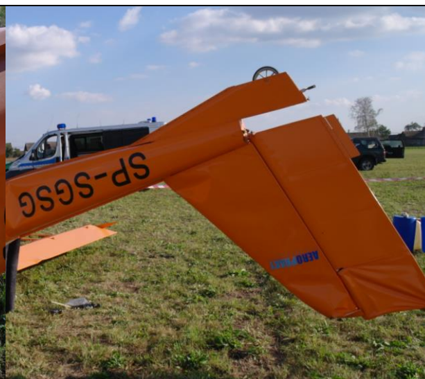
Rys. 3. Uszkodzenia usterzenia kierunku
