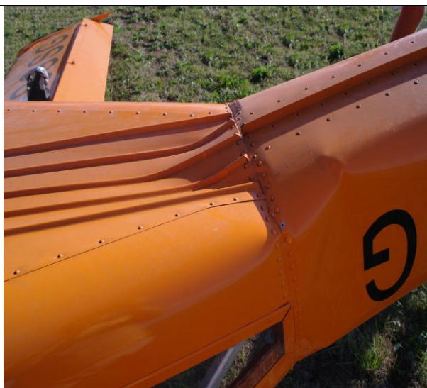
Rys. 2. Załamana belka ogonowa
