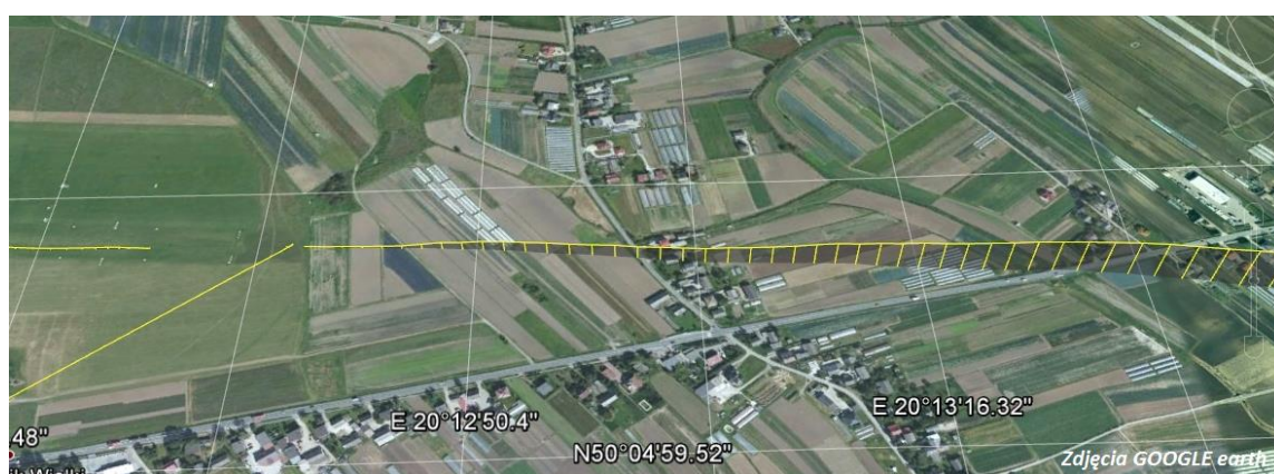
Rys. 8. Ścieżka podejścia do lądowania wg zapisu rejestratora pokładowego.
