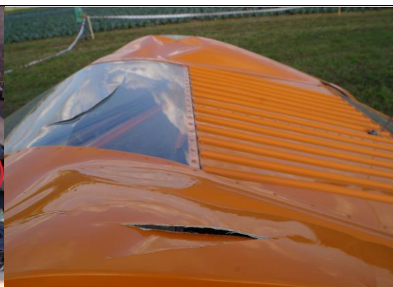
Rys. 5. Uszkodzenia pokrycia skrzydła
