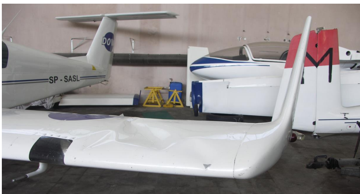
Rys.3. Uszkodzone lewe skrzydło samolotu [foto PKBWL]
