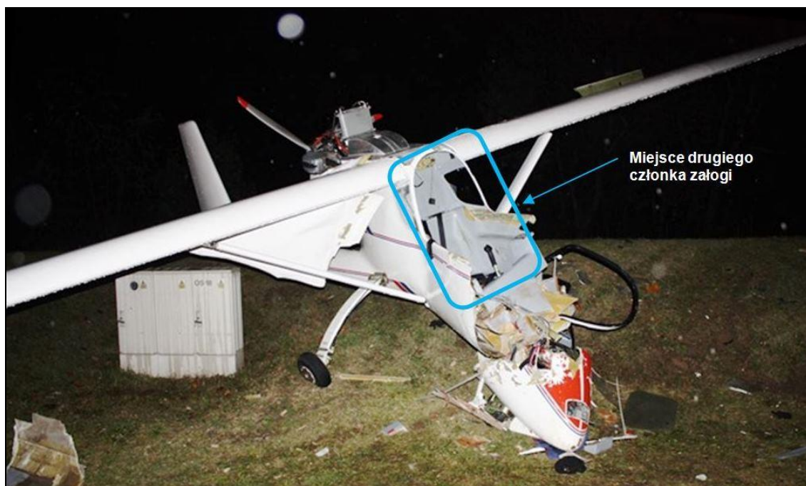
Ilustracja 7. Widoczne zmiążdżenie przedniej części kadłuba; całkowicie została zniszczona przednia część kabiny (miejsce dowódcy) a tylna – do fotela drugiego członka załogi.
