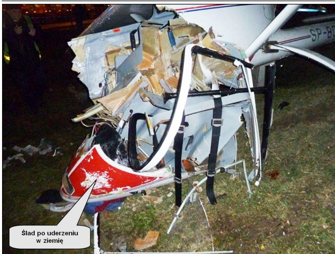
Ilustracja 8. Widoczne odchylenie przodu kadłuba („nosa motoszybowca”) w prawo, co świadczy o tym, że uderzenie nastąpiło lewą stroną przodu kadłuba (zdjęcie wykonano po akcji ratowniczej, która mogła wprowadzić pewne naruszenia stanu w stosunku do stanu bezpośrednio po wypadku).
