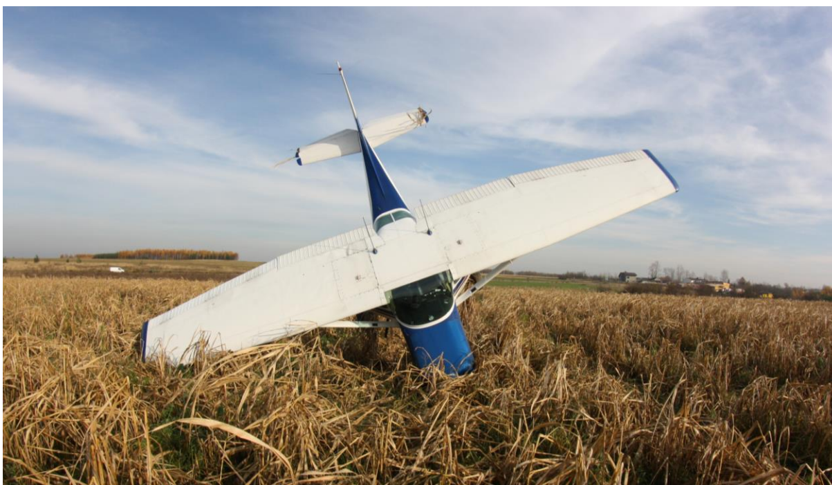
Rys. 2. Samolot po awaryjnym lądowaniu podparty na silniku i końcówce prawego skrzydła [foto Aer. Częstochowski].
