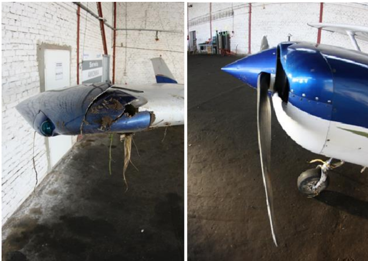
Rys.3. Zdjęcia uszkodzeń końcówki prawego skrzydła oraz wygiętej łopaty śmigła. [foto PKBWL].
