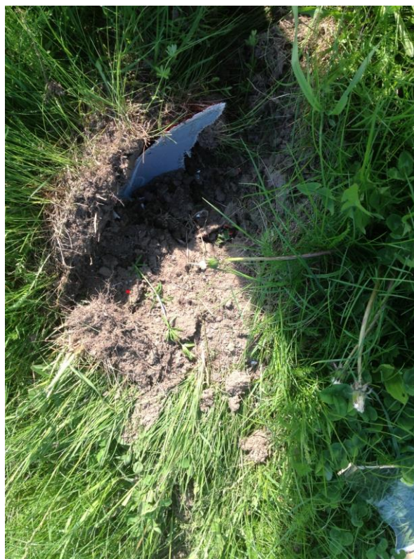
5. Miejsce uderzenia dziobu szybowca w pozycji odwróconej
