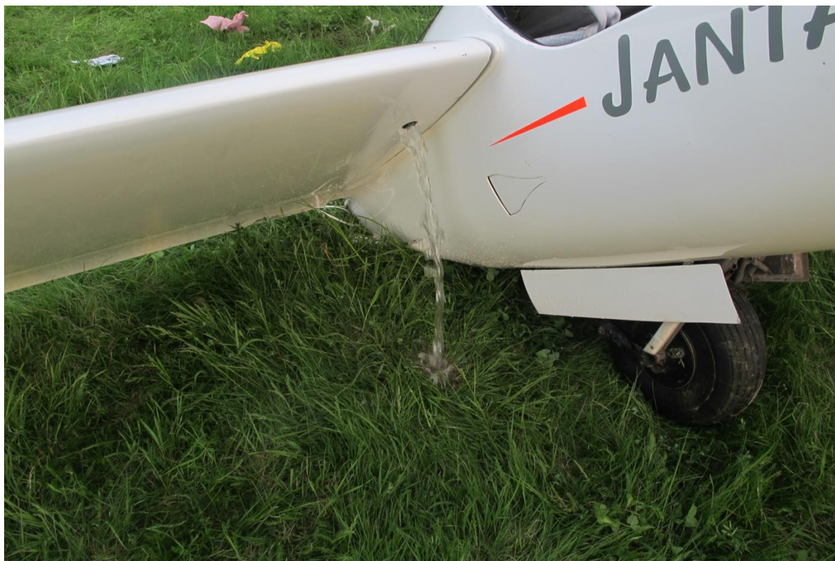
16. Opróżnianie zbiorników balastowych podczas demontażu wraku
