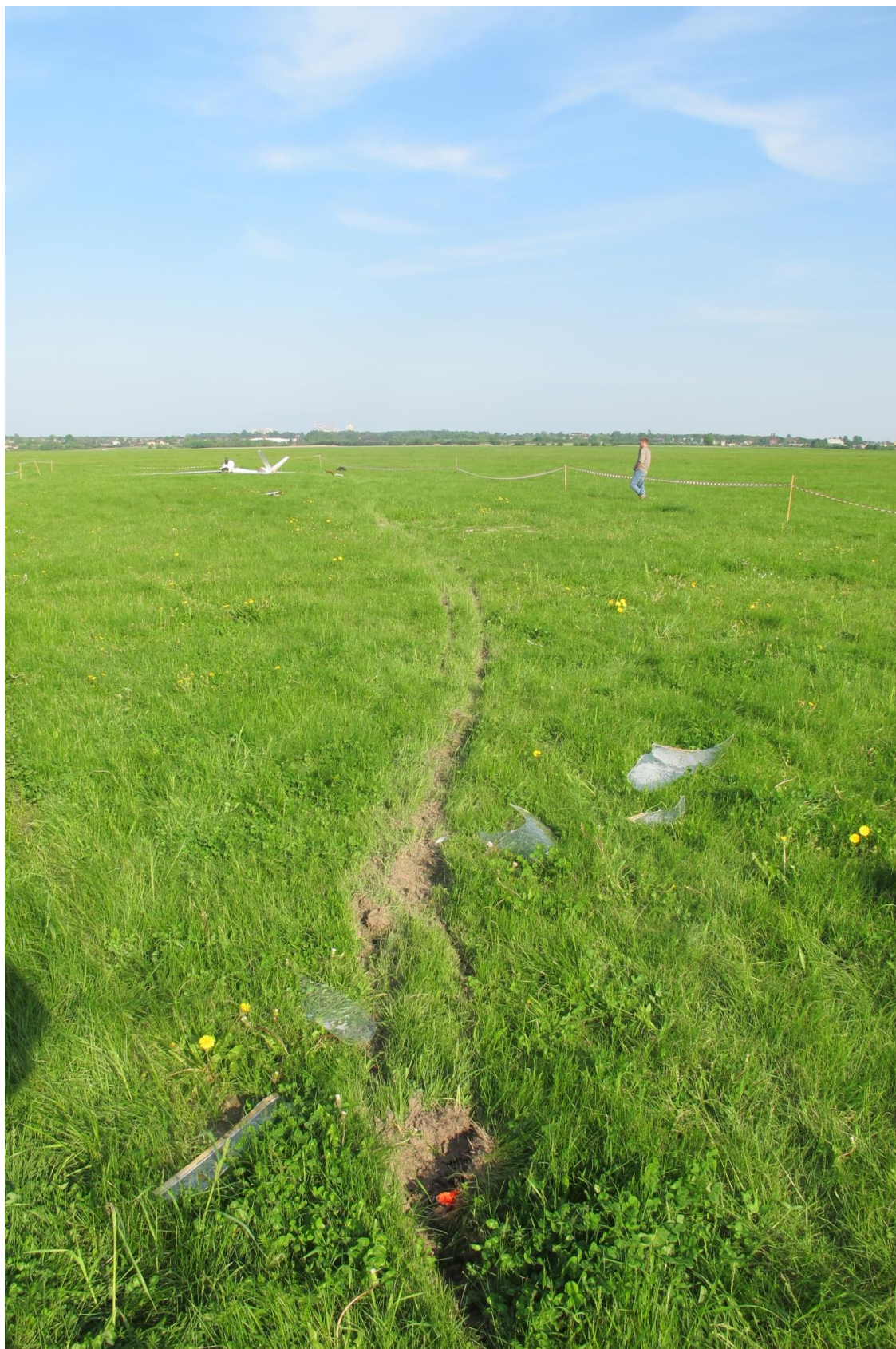
11. Ślad uderzenia dziobu, oraz wleczenia szybowca przez samolot do momentu zatrzymania
