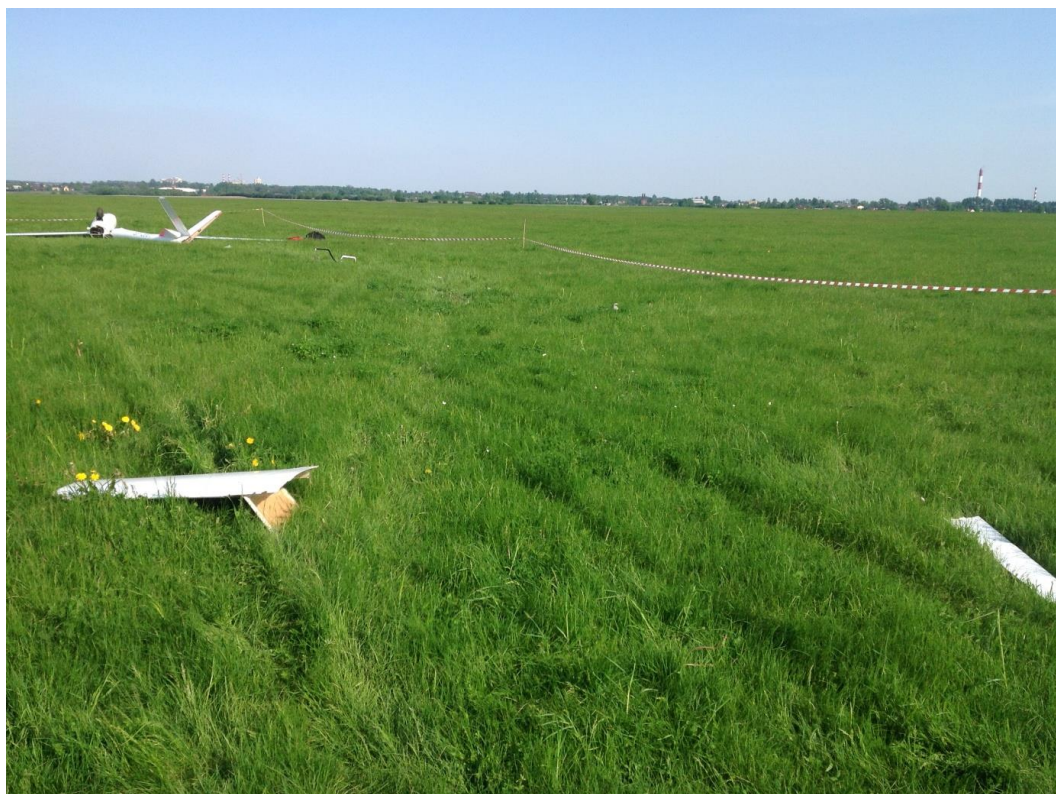
9. Wyłamany statecznik wysokości wraz ze sterem
