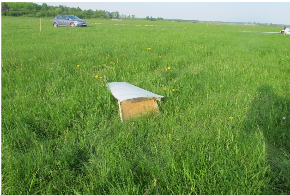
10. Wyłamany statecznik wysokości
