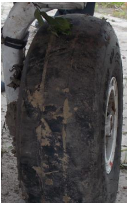
Stan opony prawej podwozia głównego
