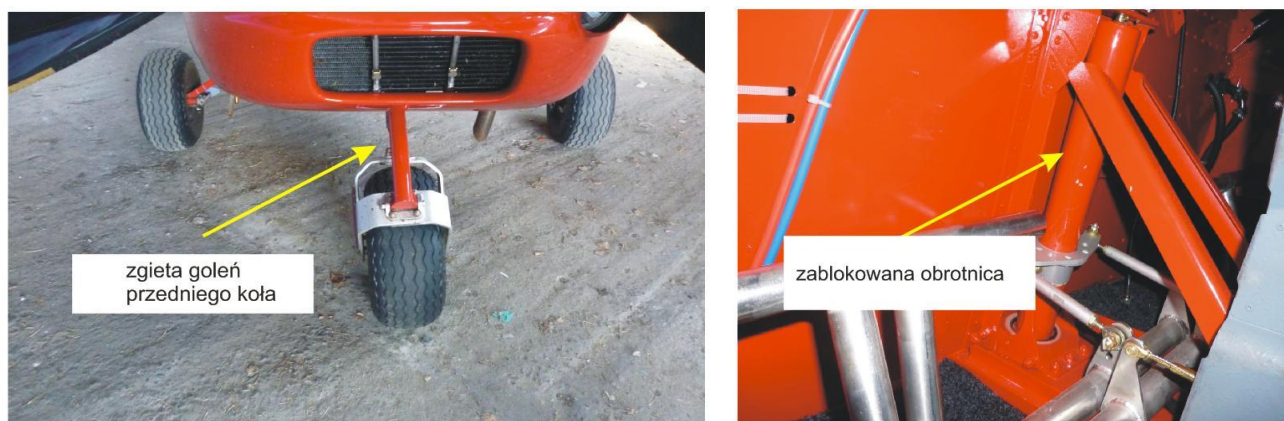
Fot. Widok zgiętej goleni i zablokowanej obrotnicy przedniej goleni
