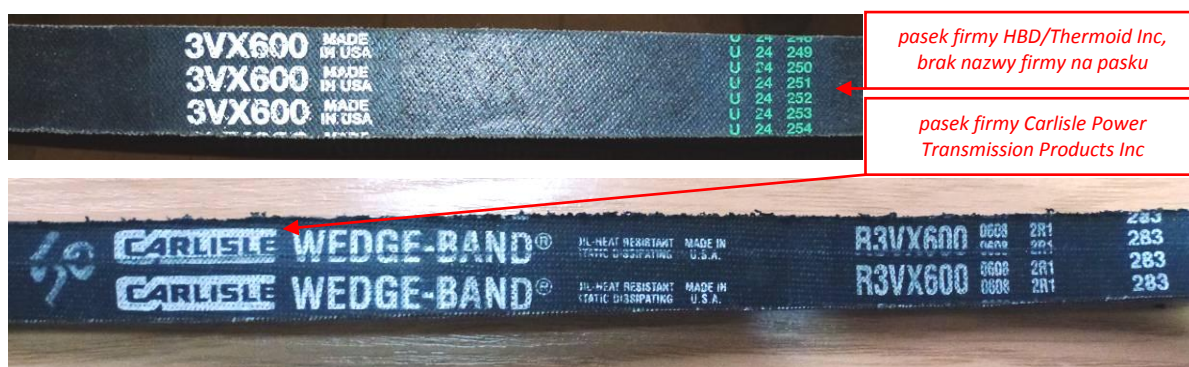
Fot. 7. Porównanie pasków firm: HBD/ Thermoid, Inc i Carlisle Power Transmission Products, Inc
