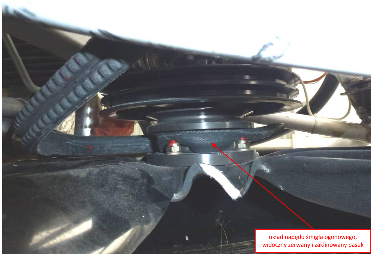
Fot. 5. Widok zaklinowanego paska napędu śmigła ogonowego
