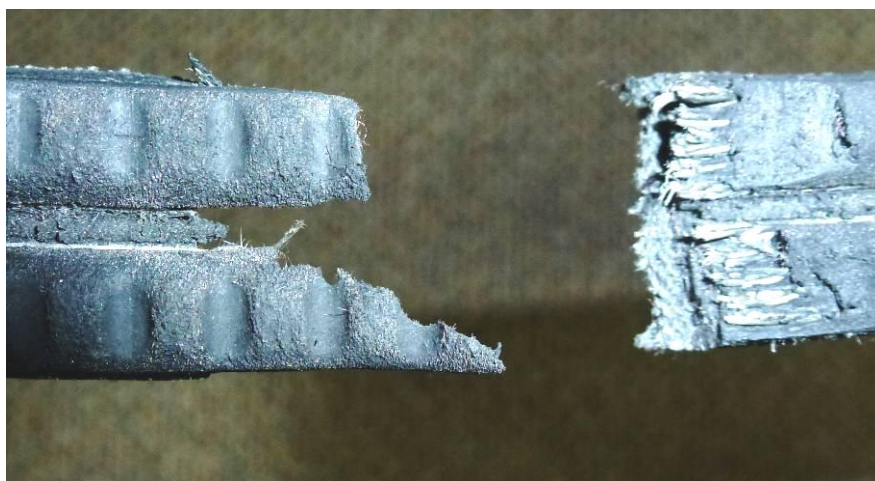
Fot. 6. Widok zerwanego paska napędu śmigła ogonowego
