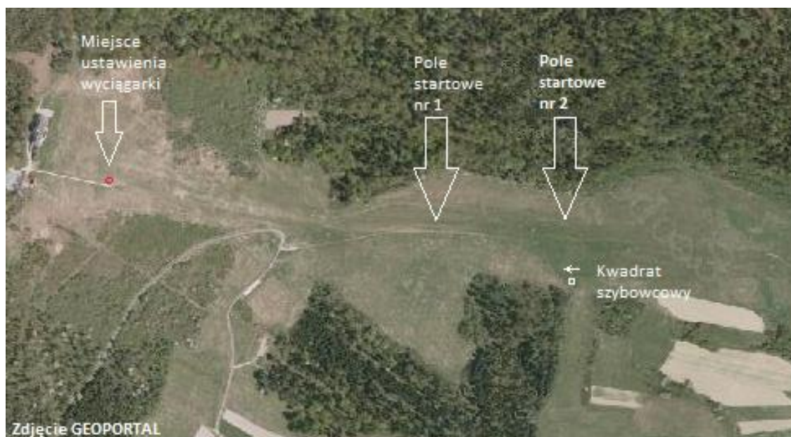
Rys. 1. Elementy sytuacyjne startu wyciągarkowego na lądowisku
