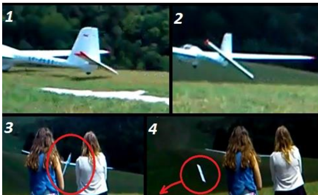
Rys. 9. Oddzielenie się usterzenia poziomego od kadłuba szybowca.
