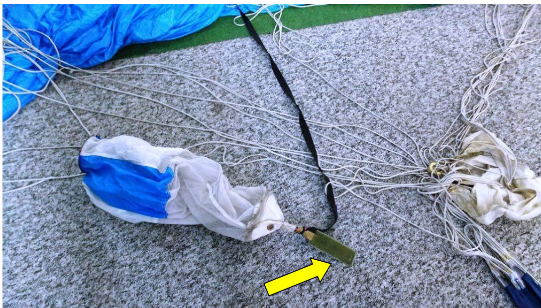
Fot. 1. Widok pilocika z taśmą łączącą przechodzącą przez linkę. Żółta strzałka wskazuje dodatkową taśmę zamocowaną przez mechanika. Fot. PKBWL
