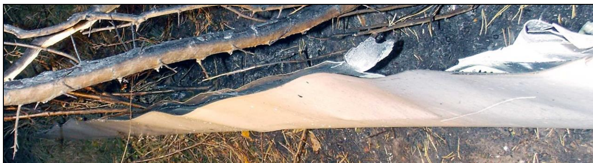
26 – Łopata nr 2 wirnika głównego – uszkodzenia spływu charakterystyczne dla uderzenia w płaską przeszkodę na całej długości noska [foto: Policja].
