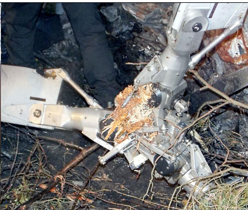
36 – Głowica wirnika głównego ze śladami gwałtownego kontaktu z drzewem. Widoczne naniesione numery porządkowe łopat wirnika.
