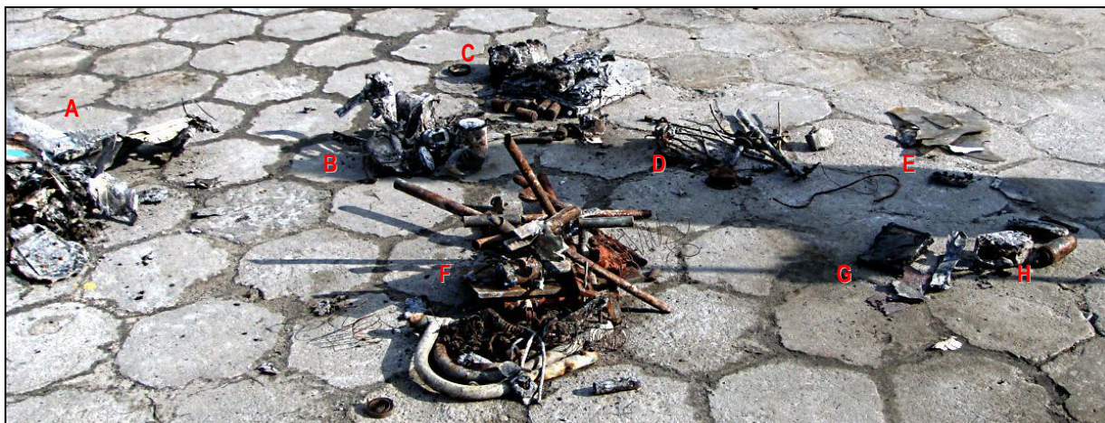
62 – Pogrupowane drobniejsze szczątki śmigłowca po selekcji dokonanej na miejscu przechowywania wraku: A – szczątki kabinowej części kadłuba (spalone resztki skorup kompozytowych), B – zniszczone przyrządy pokładowe, C – rozbity i spalony akumulator oraz fragmenty instalacji elektrycznej, D – szczątki instalacji paliwowej (fragmenty przewodów, zniszczone paliwomierze, zamknięcia zbiorników), E – drobne szczątki oszklenia, F – szczątki kratownicy kadłuba i sterownic oraz układów sterowania (stalowe końcówki popychaczy), G – urządzenie GPS, H – szczątki wyposażenia kabiny.
