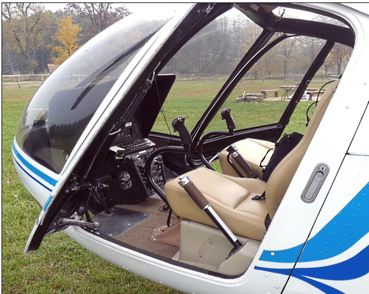
2 – Śmigłowiec na terenie ośrodka w Hermanowie przed startem do ostatniego lotu – wnętrze kabiny. Widoczny zdwojony zestaw sterownic. [foto: świadek startu].
