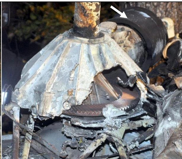
34 – Pokazana od przodu przekładnia zębata wirnika głównego z częściowo stopioną przez pożar skorupą korpusu. Białą strzałką wskazane koło przekładni pasowej.
