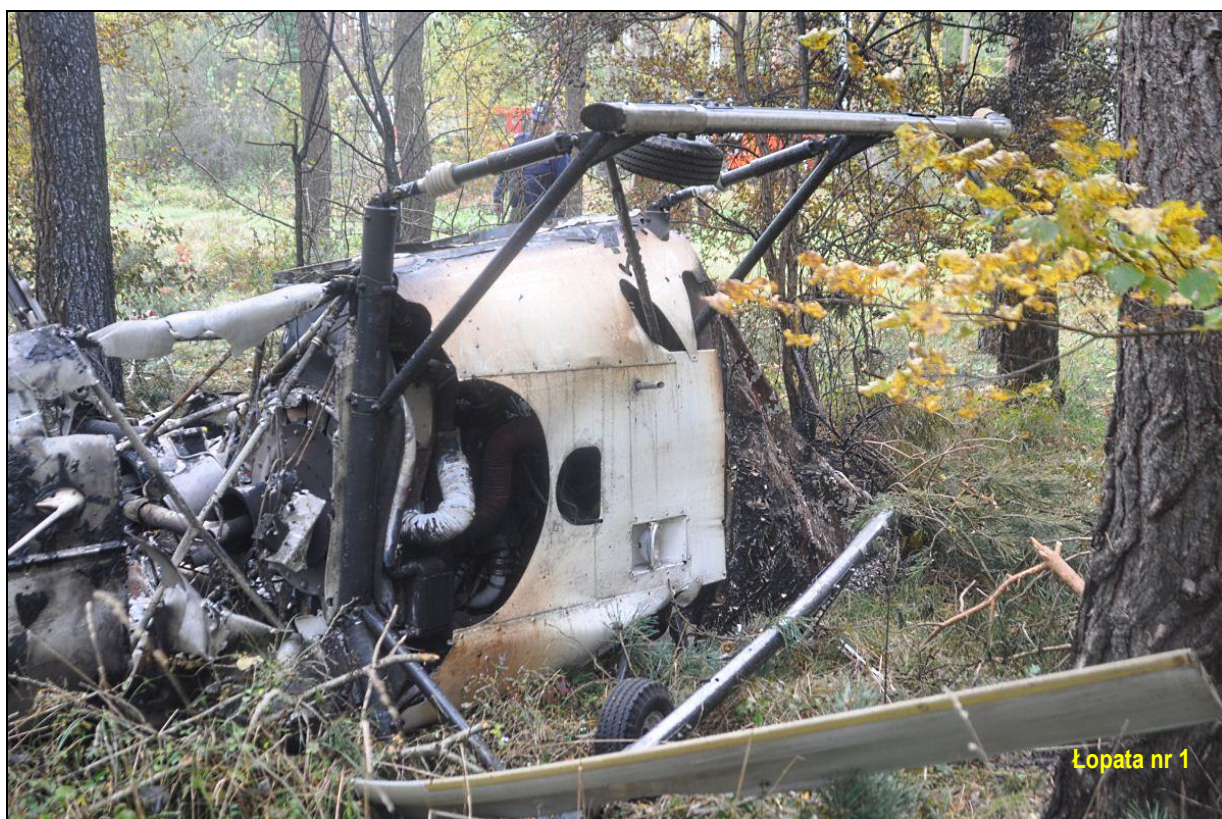
21 – Środkowa część kadłuba, widok od spodu - zbliżenie. Widoczne znaczne zniszczenia od pożaru w przedziale za silnikiem oraz kompletne spalenie części kabinowej. Dobrze widoczna łopata nr 1 wirnika głównego, podwinięta pod kadłub. Stan łopaty wirnika nr 1, najbliższego otoczenia oraz połamane lewe golenie płozowego podwozia głównego i nieuszkodzone golenie prawe świadczą, że śmigłowiec spadł na lewy bok kadłuba bez prędkości postępowej z nieruchomym lub bardzo wolno obracającym się wirnikiem [foto: Policja].
