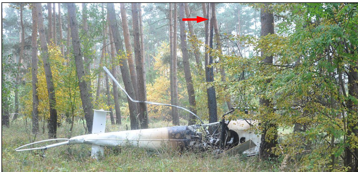
15 – Ogólny widok śmigłowca na miejscu wypadku od strony spodu kadłuba. Strzałką wskazane drzewo uszkodzone przez uderzenie głowicy wirnika głównego [foto: Policja].
