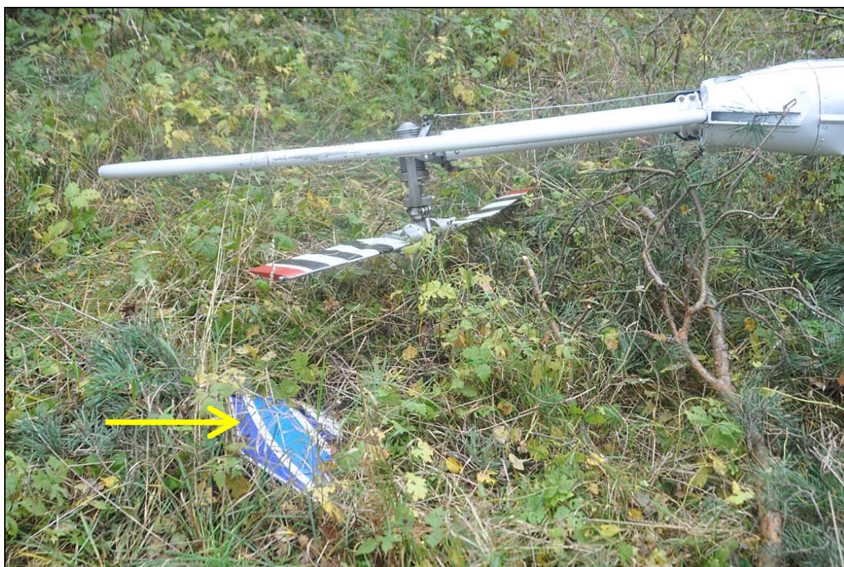
17 – Końcówka belki ogonowej ze śmigłem ogonowym. Stan łopat świadczy, iż nie obracało się ono w chwili kontaktu z ziemią. Poniżej wirmika widoczny odłamany górny fragment prawego statecznika pionowego (strzałka żółta) [foto: Policja].
