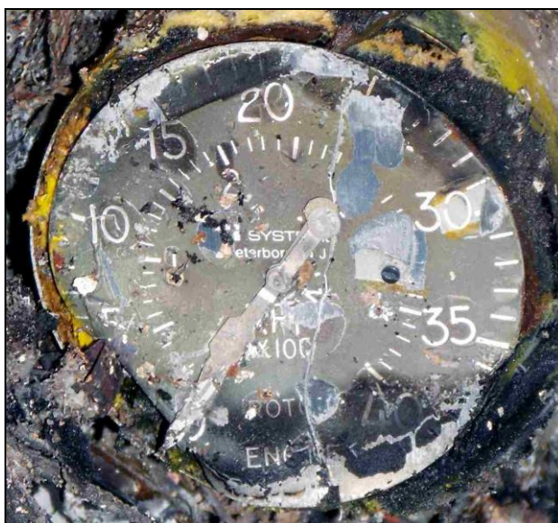
41 – Zniszczony przez pożar dwuwskazówkowy obrotomierz wirnika głównego i silnika.
