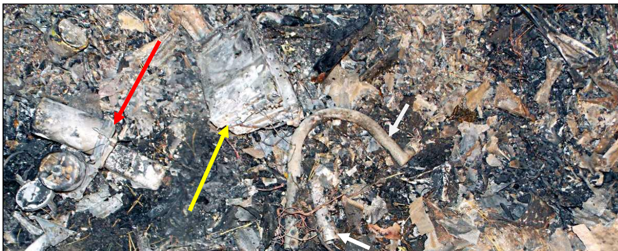
38 – Szczątki tablicy przyrządów (czerwona strzałka) i wyposażenia radionawigacyjnego (żółta strzałka). Na środku kadru widoczne sterownice ręczne (białe strzałki).
