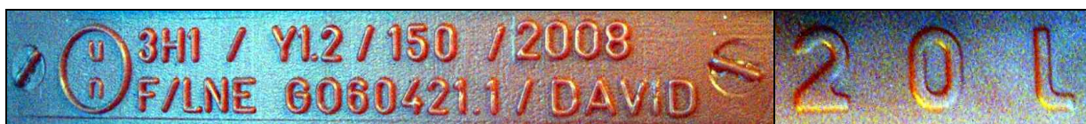
58, 59 – Oznakowania typu i pojemności na 20-litrowym kanistrze z paliwem.
