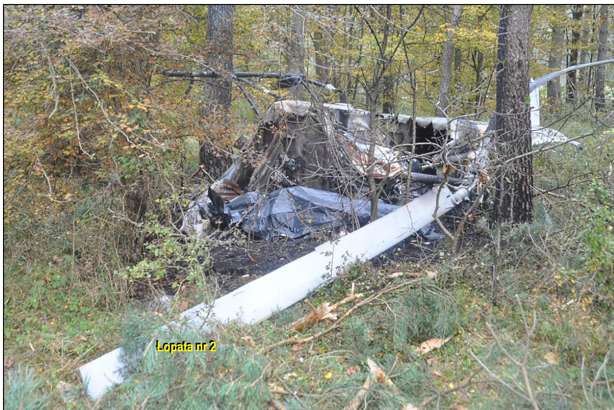
23 – Środkowa część kadłuba, widok od grzbietu i od przodu. Widoczne znaczne zniszczenia od pożaru w przedziale za silnikiem oraz kompletne spalenie części kabinowej. Stan łopaty nr 2 wirnika głównego świadczy, że w chwili zderzenia śmigłowca z ziemią był on nieruchomy lub obracał się bardzo wolno [foto: Policja].
