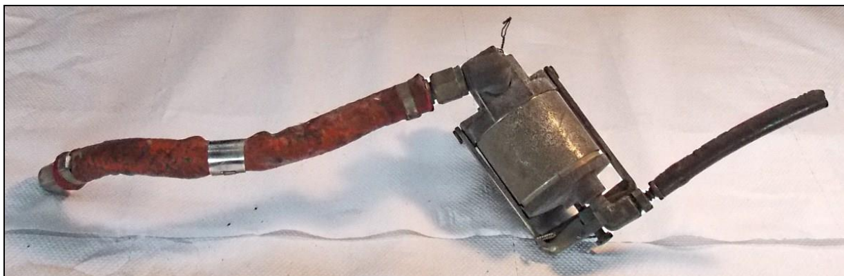
49 – Filtr paliwa z zaworem zlewowym po zdemontowaniu z wraku.
