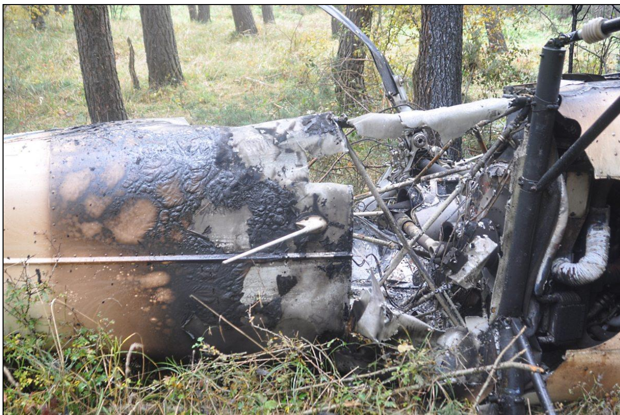
20 – Środkowa część kadłuba, widok od spodu - zbliżenie. Widoczny znaczny zasięg zniszczeń od pożaru w przedziale za silnikiem, gdzie w śmigłowcu Enstrom 280 znajduje się bagażnik [foto: Policja].
