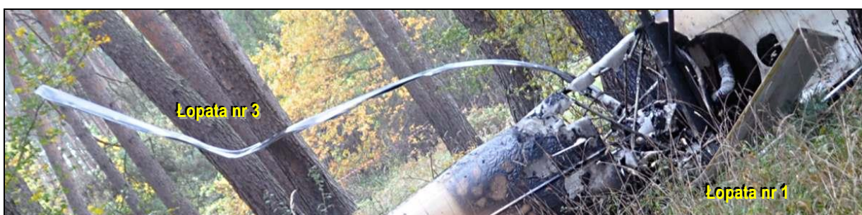
16 – Ogólny widok śmigłowca na miejscu wypadku od strony spodu kadłuba – zbliżenie łopat wirnika głównego nr 1 i nr 3. Łopata nr 3 zgięta w płaszczyźnie cięciw wskutek uderzenia o drzewo [foto: Policja].
