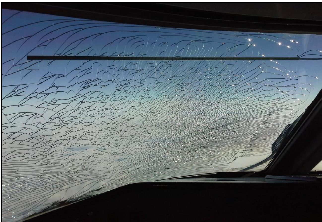
Uszkodzona lewa szyba przednia kabiny załogi samolotu Embraer ERJ-175.
