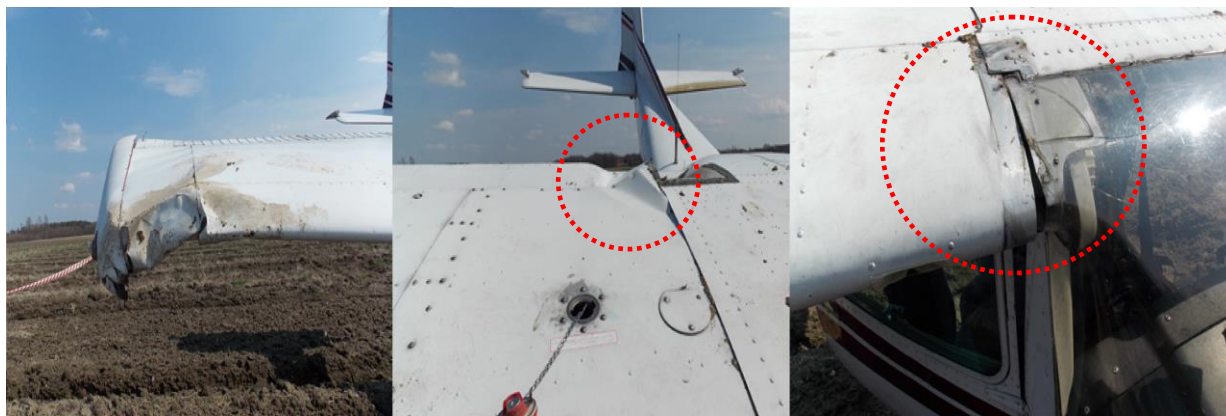
Rys. 2. Uszkodzenia prawego skrzydła na końcówce i w części przykadłubowej. [foto PKBWL]
