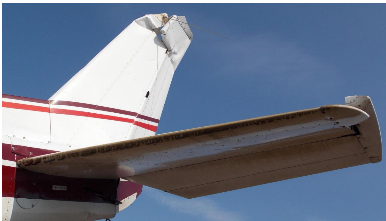
Rys. 3. Uszkodzenia statecznika pionowego i steru kierunku. Widoczne ślady oleju silnikowego na kesonie statecznika poziomego. [foto PKBWL]
