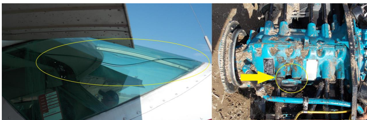
Rys. 4. Pęknięte tylne oszklenie kabiny oraz pęknięty korpus silnika w okolicy cylindra nr 2. [foto PKBWL]
