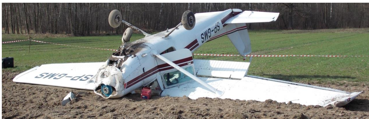
Rys. 1. Widok ogólny samolotu na miejscu wypadku. Widoczne wylamane śmigło, uszkodzona osłona silnika, wylamana goleń przedniego podwozia i uszkodzona końcówka prawego skrzydła [fotoPKBWL]
