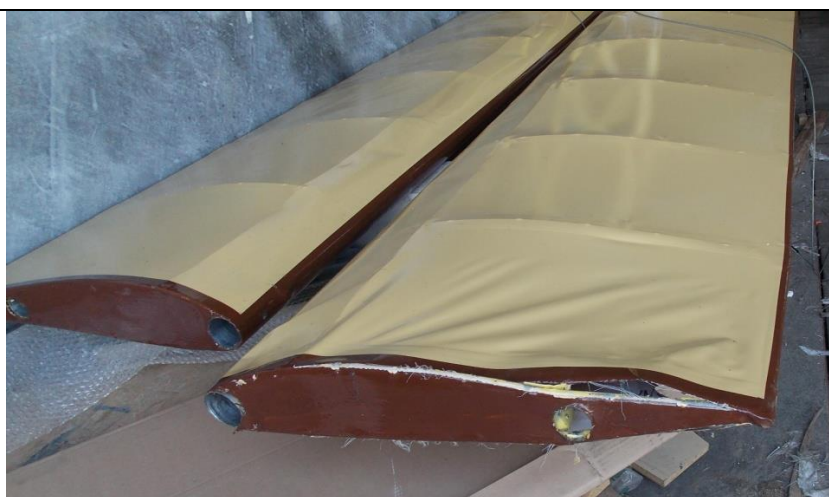
Zdjęcie przedstawia fragment uszkodzonego w części przykadłubowej prawego skrzydła
