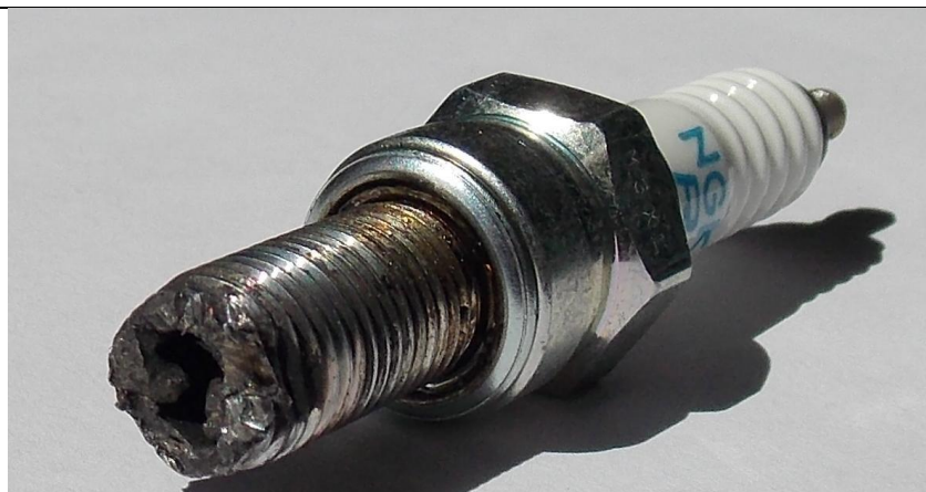
Zdjęcie po lewej – uszkodzona świeca prawego cylindra.
