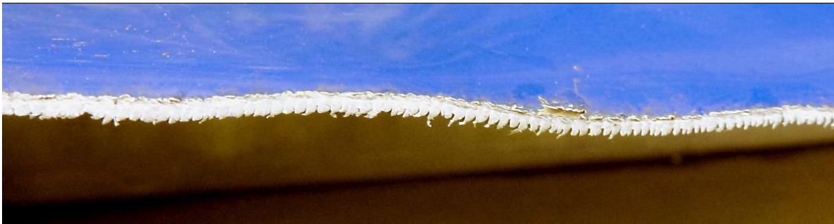
12 – Powiększenie widoku krawędzi rozcięcia pokrycia usterzenia samolotu (2) SP-APL.
