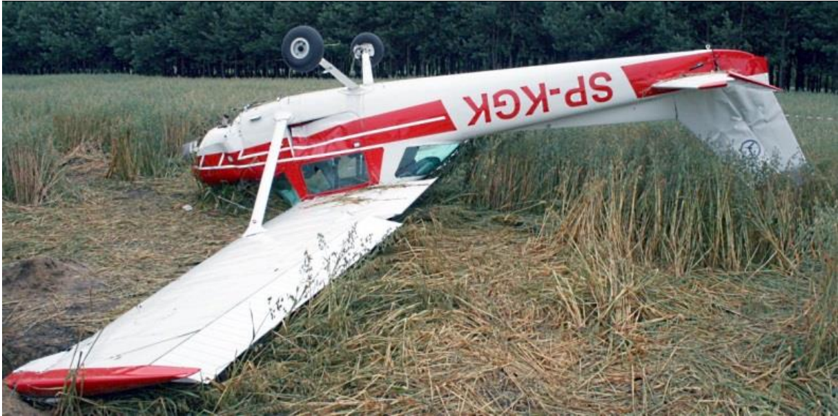
2 – Uszkodzony samolot (1) SP-KGK na miejscu awaryjnego lądowania – zbliżenie z prawej strony. Dobrze widoczne uszkodzenia usterzenia pionowego i wgniecenia prawych drzwi. [foto: KGP Radom]
