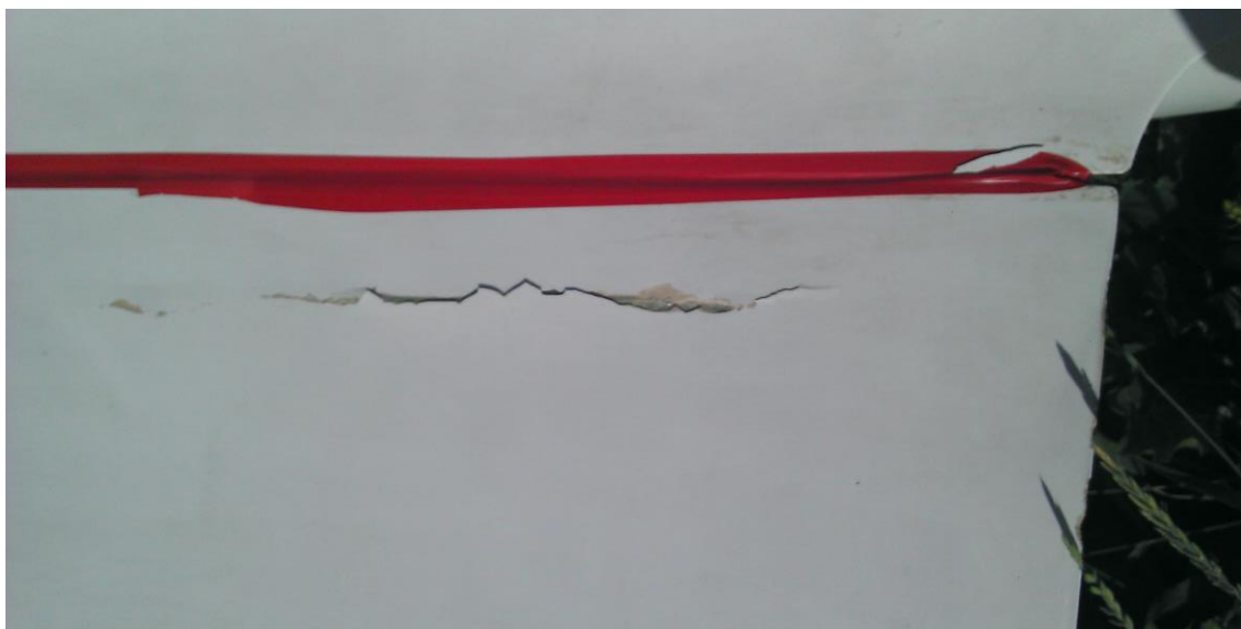
Rys. 3 – Uszkodzenie górnego pokrycia lewego skrzydła – pęknięcie długości ok. 40 cm umiejscowione 5 cm od nasady
