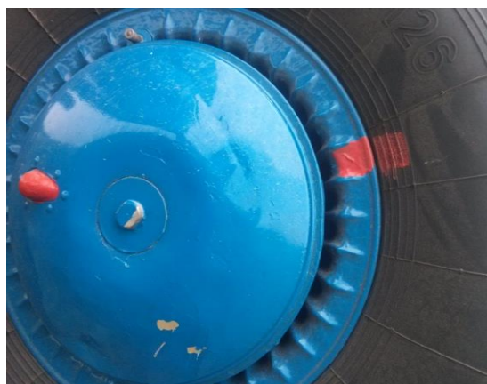
11 – Lewe i prawe koło głównego podwozia samolotu. Nie widać przemieszczeń opon względem obręczy.
