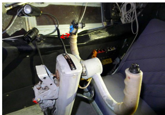
9 – Kolumny sterowania pierwszego i drugiego pilota. Dźwignia hamowania kół po prawej stronie znajduje się bliżej rękojeści niż po stronie lewej.
