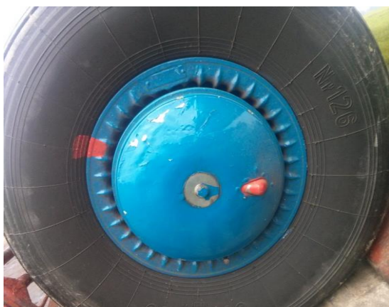
11 – Lewe i prawe koło głównego podwozia samolotu. Nie widać przemieszczeń opon względem obręczy.
