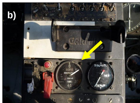
6 – Fotografie tablicy przyrządów wykonane po ustawieniu samolotu na trzech kołach: a) iskrowniki wyłączone po zatrzymaniu się samolotu, b) wskazania wychylenia klap – 15°.
