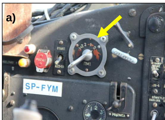
6 – Fotografie tablicy przyrządów wykonane po ustawieniu samolotu na trzech kołach: a) iskrowniki wyłączone po zatrzymaniu się samolotu, b) wskazania wychylenia klap – 15°.
