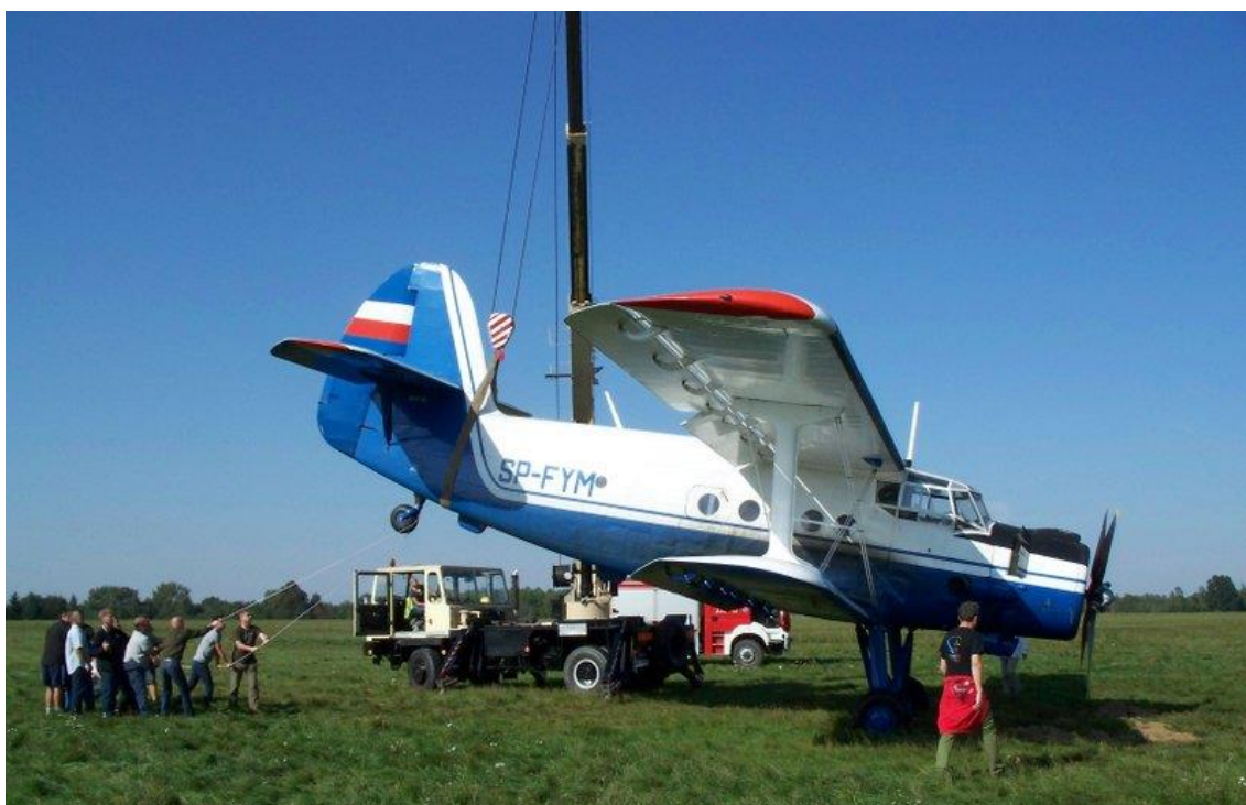
2 -. Ustawianie samolotu na trzy koła przy pomocy dźwigu samochodowego.
