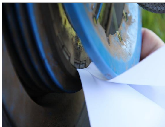
10 – Sprawdzanie stanu szczęk hamulcowych kół podwozia głównego po wylądowaniu samolotu.
