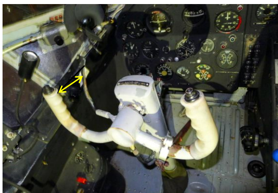
9 – Kolumny sterowania pierwszego i drugiego pilota. Dźwignia hamowania kół po prawej stronie znajduje się bliżej rękojeści niż po stronie lewej.
