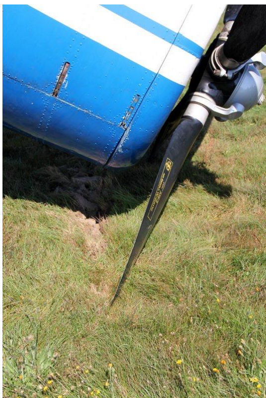
Rys. 11 Widok łopat śmigła z prawej i lewej strony samolotu. Po uderzeniu w ziemię jednej z łopat samolot obrócił się w prawą stronę, a dwie kolejne łopaty wbiły się w grunt.
