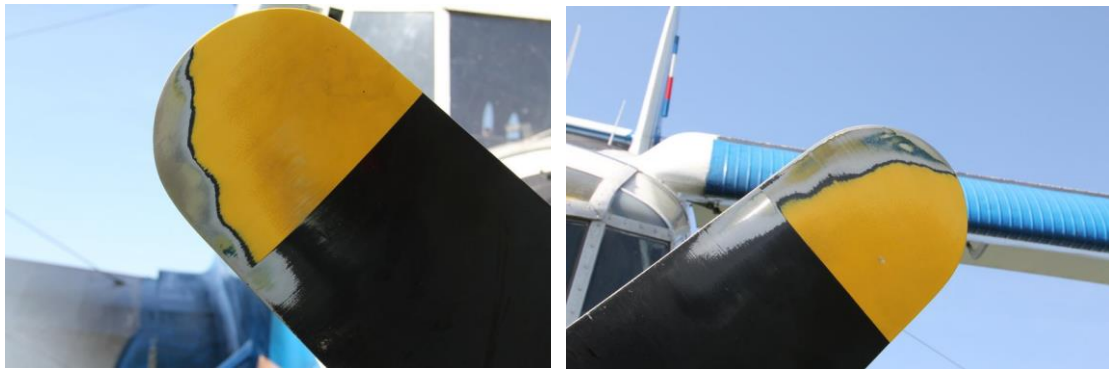
Rys. 2 Ślady kontaktu łopat z ziemią obracającego się śmigła.
