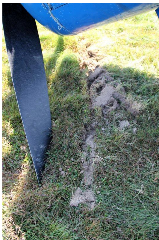
Rys. 11 Widok łopat śmigła z prawej i lewej strony samolotu. Po uderzeniu w ziemię jednej z łopat samolot obrócił się w prawą stronę, a dwie kolejne łopaty wbiły się w grunt.
