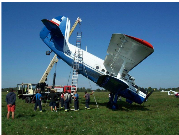
Rys.6 Zabezpieczenie samolotu przed niekontrolowanym opadnięciem ogona.
