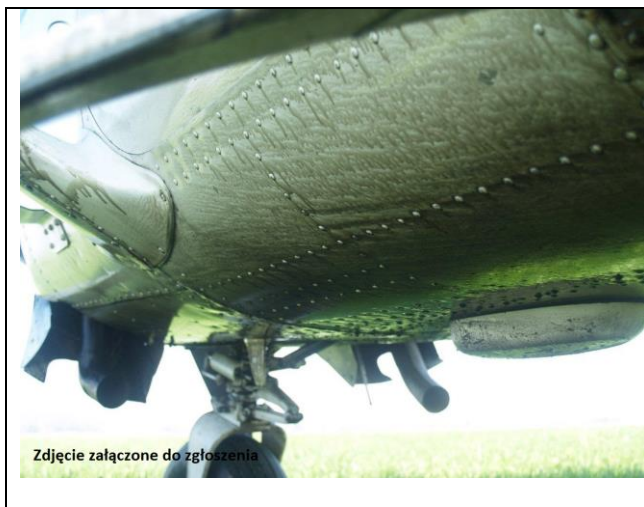
Ilustracja nr 1. Dolna powierzchnia kadłuba samolotu pokryta wyciekającym olejem.
