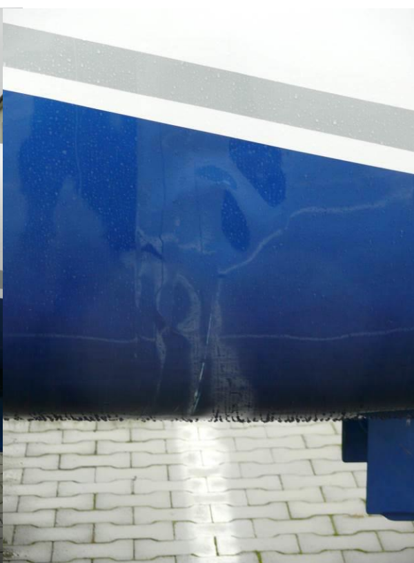
Rys. 15 Zbliżenie na uszkodzenie przedniej części kadłuba.
