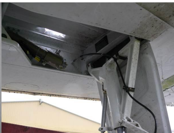
Rys. 19 Urwany wciągnik prawego podwozia – widoczny otwór w górnym pokryciu skrzydła.
