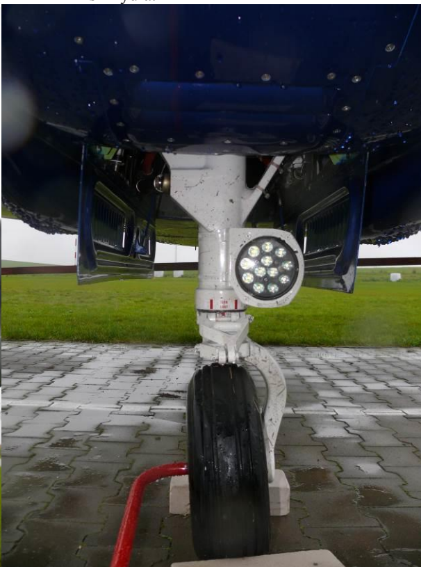
Rys. 21 Wygięte przednie podwozie
