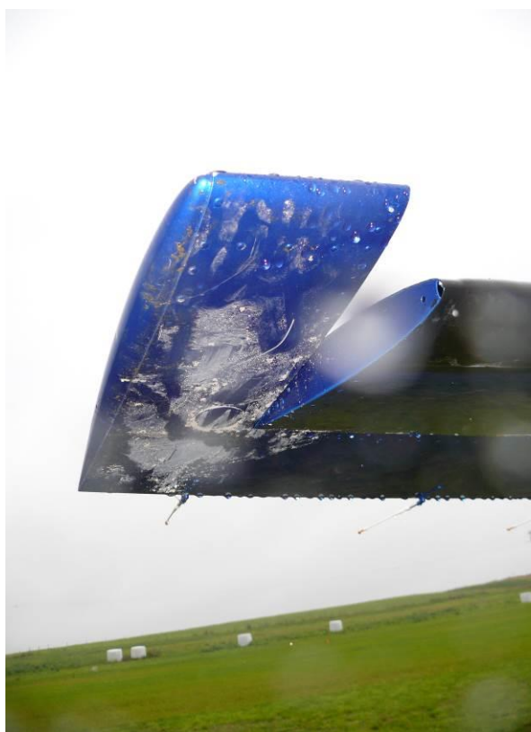
Rys. 20 Uszkodzenia steru wysokości po prawej stronie.
