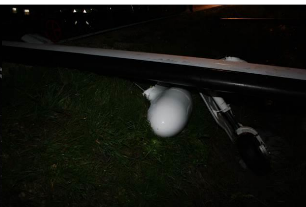
Rys. 5 Wyłamany zasobnik z radarem i częściowo złożone podwozie.
