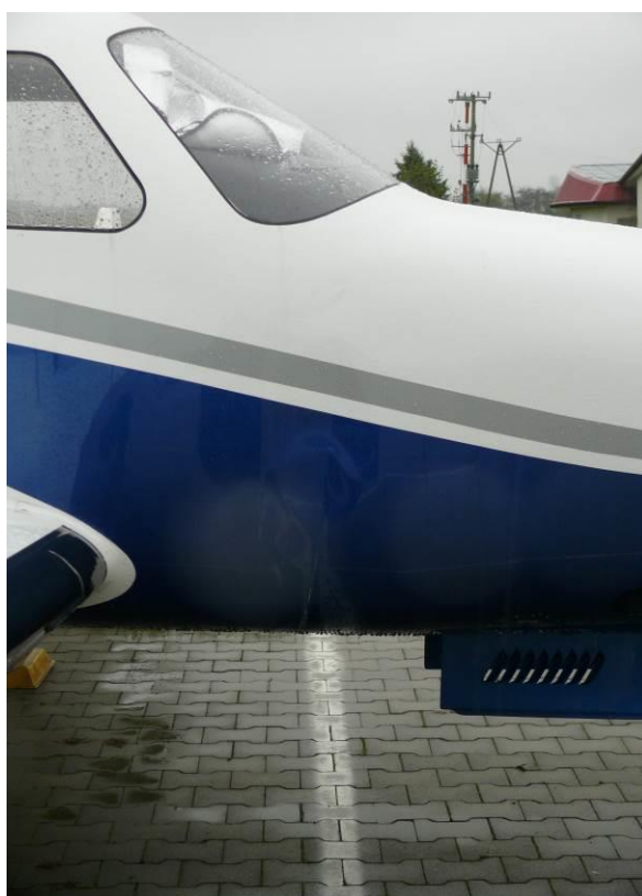
Rys. 14 Uszkodzenie przedniej części kadłuba.
