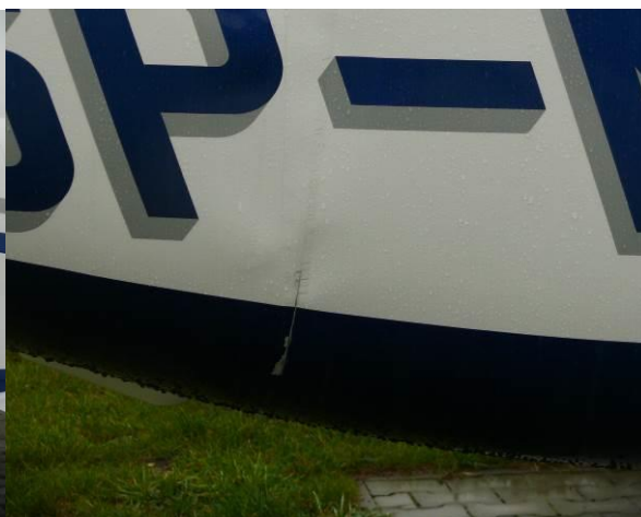
Rys. 13 Zbliżenie na uszkodzenie tyłu kadłuba.
